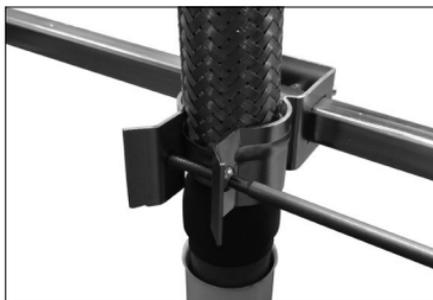
**3b. (VB4/VB6)** Vuelva a poner el tornillo de cabeza redondeada que retiró en el paso 3b. Apriete el tornillo de cabeza redondeada a un par de 15 pulg.-lb/6 N•m (entre 1 y 2 vueltas después de apretar con la mano), como se ve a la izquierda.
