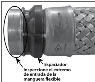
2. Inspeccione la entrada de la manguera flexible Serie AH1-CC o AH2-CC por si tuviera daños (muescas, bordes aplastados, etc.). Utilice una manguera flexible nueva Victaulic® Serie AH1-CC, AH1-CC-LP, AH2-CC, AH2-CC-LP o AH2-CC-300 si hubiera algún daño.
