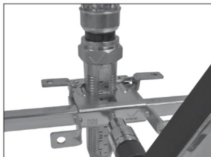
5. Con una broca T25 Torx\*, apriete el tornillo de retención de la barra cuadrada a un par de apriete de 72 pulg.-lb/8,1 N•m•m.
