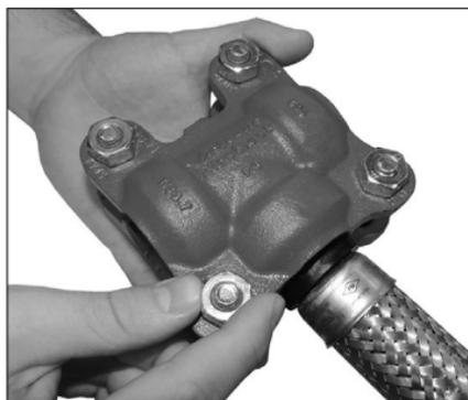
5. Introduzca la manguera flexible Serie AH1-CC, AH1-CC-LP, AH2-CC, AH2-CC-LP o AH2-CC-300 en el codo de 90° N° 101 o la "T" recta N° 102. Compruebe que la junta esté bien asentada en la bolsa de cada carcasa y que las patillas del acoplamiento se metan en el espaciador de la entrada de la manguera flexible Serie AH1-CC, AH1-CC-LP, AH2-CC, AH2-CC-LP o AH2-CC-300.
