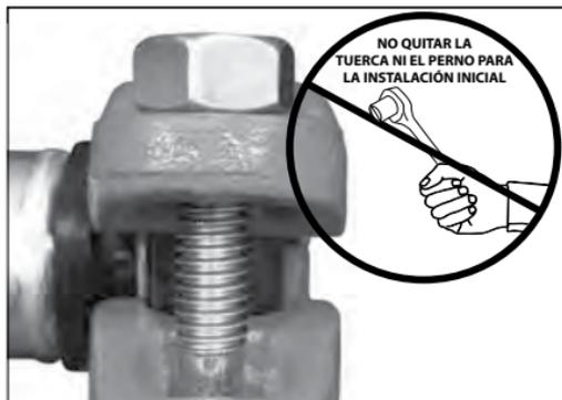
**1. NO DESMONTAR EL ACOPLAMIENTO:** El acoplamiento Estilo 108 de las Series AH1-CC, AH2-CC y AH2-CC-300 está diseñado para que el instalador no tenga que quitar conexiones, tuercas ni tornillos en la instalación inicial. Esto facilita la instalación al permitir que el instalador introduzca directamente el extremo ranurado de la tubería de rociador en el acoplamiento.
