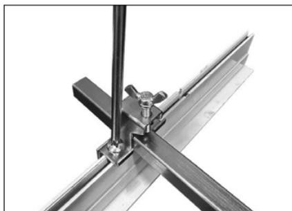
2. Coloque el soporte de extremo del soporte Estilo VB6 en la estructura del centro de datos y apriete los tornillos de máquina en el canal roscado de la estructura del centro de datos, como se muestra en la foto. Hay dos tornillos por lado o sea, cuatro en total. **NOTA:** Use los tornillos suministrados por el fabricante de la estructura de cielorraso.
