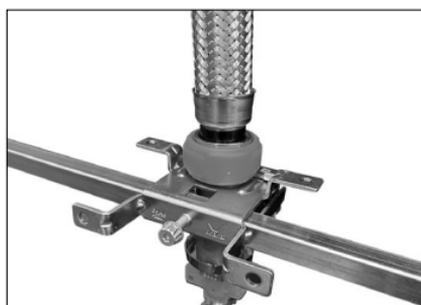
3. Deslice la boquilla reductora del rociador en el cuerpo del soporte, luego cierre la compuerta. Cierre la compuerta alrededor de la boquilla reductora del rociador. **NOTA:** La compuerta se asegurará firmemente alrededor de la boquilla reductora del rociador.
