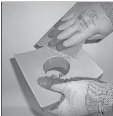
**2.** Con papel de lija, lije la superficie de acoplamiento del bloque de montaje hasta que quede áspera. La superficie debe quedar suficientemente áspera para favorecer la adhesión adecuada al conducto. Retire el polvo de lijado.
