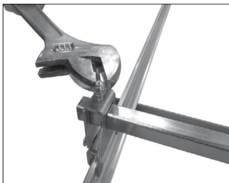
**NOTA:** Para fines de ajuste, puede aflojarse el tornillo de mariposa de la parte superior de cada soporte de extremo para poder deslizar el soporte de extremo por la barra cuadrada. Apriete el tornillo de mariposa en la parte superior de cada conjunto de soporte de extremo a un par de 36 pulg.-lb/ 4 N•m (entre ½ y ¾ de vuelta después de apretar a mano) para fijar el soporte de extremo a la barra cuadrada.
