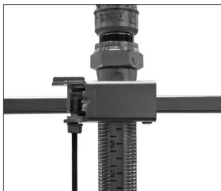
2. Cierre la compuerta alrededor de la boquilla reductora del rociador. La compuerta se asegurará firmemente alrededor de la boquilla reductora del rociador. Con una broca T25, apriete el tornillo de ajuste a un par de 75 pulg.-lb/8,5 N•m (hasta que el tornillo de ajuste haga contacto metal con metal con la parte inferior de la compuerta).
