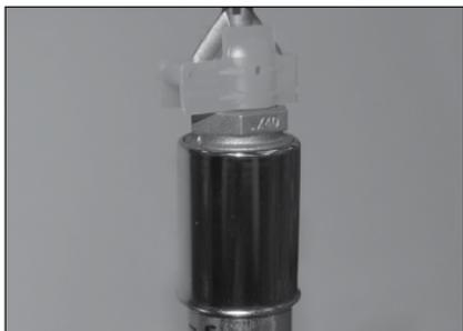
**4.** Vuelva a instalar el protector de ampolla en el rociador. Proceda con precaución al reinstalar el protector de ampolla para no dañar la ampolla, el deflector ni los brazos del marco. NO use herramientas para poner el protector de ampolla. **Los rociadores que muestren indicios de daños se deben reemplazar de inmediato.**
