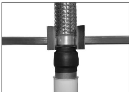
**1b. (VB4/VB6)** Quite el tornillo de cabeza redondeada del conjunto de compuerta central. Encaje el soporte en la conexión soldada, como se ve arriba. Compruebe que la ranura del soporte se alinee con el labio de la conexión soldada.
