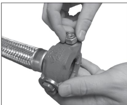
10. Coloque el perno y enrosque una tuerca a mano. **NOTA:** Verifique que el cuello oval del perno asiente correctamente en su sitio. NO apriete la tuerca por completo. Los cierres de pernos deben estar separados para instalar el acoplamiento. La tuerca debe estar enrasada con la parte superior del perno para obtener la separación adecuada.
