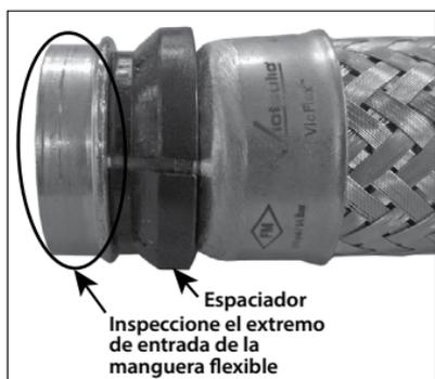
5. Examine la entrada de la conexión flexible Serie AH1-CC, AH1-CC-LP, AH2-CC, AH2-CC-LP, AH2-CC-300 o GH1-C2C por si tuviera daños (muescas, bordes aplastados, etc.). Utilice una manguera flexible nueva de Victaulic® si hubiera algún daño.
