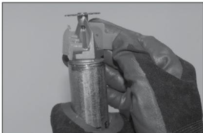
**1.** Retire temporalmente el protector de ampolla del rociador. Proceda con precaución al retirar el protector de ampolla para no dañar la ampolla, el deflector ni los brazos del marco. NO use herramientas para retirar el protector de ampolla.
