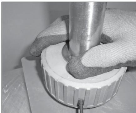
**8a.** Con una llave hexagonal de 3 mm, apriete el tornillo de bloqueo en la unión girándolo en sentido horario.
