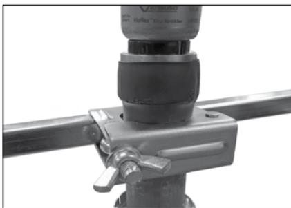
**3a. (VB2/VB3)** Cierre el conjunto de la compuerta central alrededor de la boquilla reductora del rociador. Gire el tornillo pivote y la arandela en la ranura de la compuerta. Apriete la tuerca de mariposa a un par de 50 pulg.-lb/6 N•m (a mano más de  $\frac{1}{2}$  a  $\frac{3}{4}$  de vuelta), como en la imagen.
