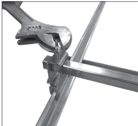
Para fines de ajuste, se puede aflojar el tornillo de mariposa de la parte superior del conjunto del extremo para poder deslizarlo por la barra cuadrada. Apriete el tornillo de mariposa en la parte superior de cada conjunto del soporte de extremo a un par de 36 pulg.-lb/4 N•m (entre  $\frac{1}{2}$  y  $\frac{3}{4}$  de vuelta después de apretar a mano) para fijar el soporte de extremo a la barra cuadrada.
