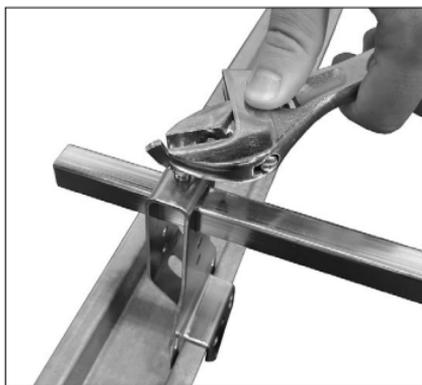
**NOTA:** Para fines de ajuste, se puede aflojar el tornillo de mariposa de la parte superior del conjunto del soporte de extremo Estilo AB2 para poder deslizarlo por la barra cuadrada. Apriete el tornillo de mariposa en la parte superior de cada conjunto de soporte de extremo a un par de 36 pulg.-lb/4 N•m (entre ½ y ¾ de vuelta después de apretar a mano) para fijar el soporte de extremo a la barra cuadrada.
