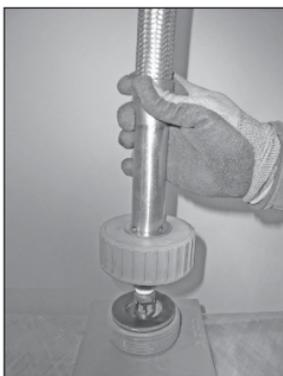
2. Con una llave hexagonal de 3 mm, afloje el tornillo de bloqueo en la unión girándolo en sentido antihorario.
