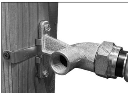
2. Instale el codo en el montante de la pared con dos tornillos de diámetro #12 x 1 pulg./25 mm adecuados para el sustrato. El codo debe estar en pleno contacto con el montante de la pared.
