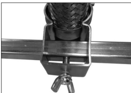
**3c. (VB4/VB6)** Apriete completamente el tornillo de mariposa a un par de 15 pulg.-lb/6 N•m (entre  $\frac{1}{2}$  y  $\frac{3}{4}$  de vuelta después de apretar con la mano).
