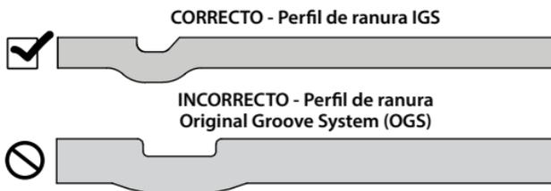
*Las tuberías y las ranuras no se muestran a escala*
