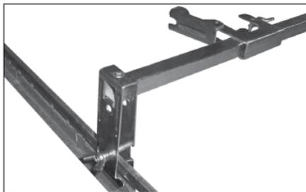
3. Fije los soportes de extremo del soporte Estilo AB7 a los raíles de la barra “T” de un sistema de cielorrasos suspendidos ASTM C635 instalado conforme a las normas ASTM C636. Compruebe que los extremos del soporte Estilo AB7 entran en los raíles.
