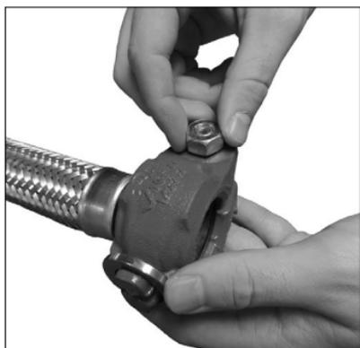
1. Afloje la tuerca del acoplamiento Estilo 108. Quite el acoplamiento Estilo 108 de la manguera flexible Serie AH1-CC, AH1-CC-LP, AH2-CC, AH2-CC-LP o AH2-CC-30.
