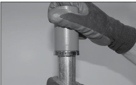
**3.** Con la herramienta suministrada, presione hacia abajo el manguito o el collarín hasta que quede retenido en el cilindro. Proceda con precaución al usar esta herramienta para no dañar la ampolla, el deflector ni los brazos del marco.
