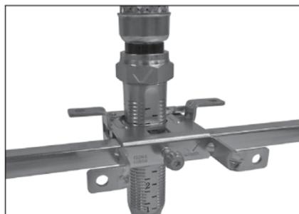
3. Deslice la boquilla reductora del rociador en el cuerpo del soporte, luego cierre la compuerta. Cierre la compuerta alrededor de la boquilla reductora del rociador. **NOTA:** La compuerta se asegurará firmemente alrededor de la boquilla reductora del rociador.
