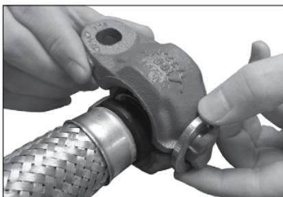
9. Instale la unión en las carcasas, como en la ilustración de la izquierda.
