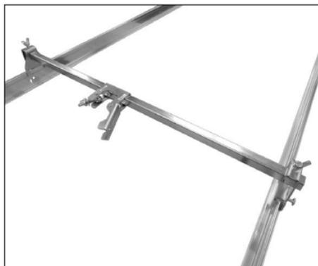
2. Fije los soportes de extremo del soporte Estilo AB11 a los raíles de la barra "T" de un sistema de cielorrasos suspendidos ASTM C635 instalado conforme a las normas ASTM C636. Asegúrese de que los extremos del soporte Estilo AB11 se enganchen en los raíles.
