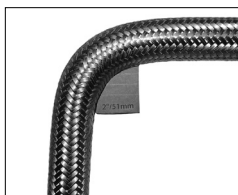
RADIO DE CURVATURA MÍNIMO DE 2 PULG./51 MM
