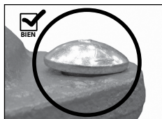
CUELLO OVAL DEL PERNO ASENTADO CORRECTAMENTE
