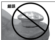
螺栓橢圓頭 錯誤放置
