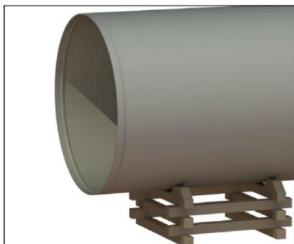
**1. PREPARE LA TUBERÍA:** Prepare la tubería siguiendo las instrucciones en la sección correspondiente "Inspección y preparación de extremos de tubería" en las páginas 2 – 4 de este manual. **Apoye de manera segura ambas tuberías en toda su longitud. El soporte para tuberías debe mantenerse durante todo el proceso de instalación.**
