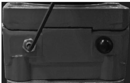
**2b.** Con una llave hexagonal, suelte el tornillo de ajuste interno aproximadamente tres vueltas (en sentido antihorario).
