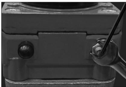
**4a.** Con una llave hexagonal, apriete el tornillo de ajuste interno (en sentido horario) hasta que haga contacto con el engranaje de cuadrante interno.
