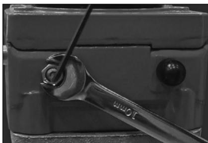
**4b.** Mientras sostiene el tornillo de ajuste interno en posición con la llave hexagonal, apriete la contratuerca hexagonal (en sentido horario).
