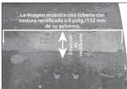
1. Antes de soldar un anillo *Vic-Ring* al extremo de la tubería, se deben rectificar las costuras soldadas a ras con la superficie de la tubería (diámetro exterior). Esmerile la costura soldada de la tubería a una distancia mínima de 6 pulg./152 mm de su extremo. Esta área debe estar en general libre de abolladuras, salientes y estampado de laminación.
