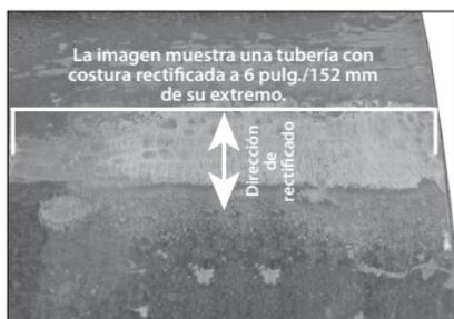
2. Antes del ranurado, los cordones y costuras soldados levantados, internos y externos, se deben rectificar a ras de la superficie en un área mínima de 6 pulg./152 mm del extremo de las tuberías. Esta área debe estar en general libre de abolladuras, salientes, anomalías de costuras soldadas y estampado de laminación a fin de garantizar un sello hermético.
