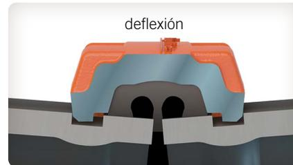
**Flexibilidad:** con las propiedades inherentes de movimiento axial y deflexión de los acoples flexibles en un sistema ranurado. Se podrían utilizar para acomodar la expansión y contracción térmica, el desalineamiento y asentamiento, y las tensiones sísmicas.
