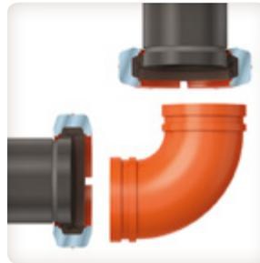
**Fácil sistema de manutenção e expansão** – através de simples desmontagem de acoplamento que permite o fácil acesso.
