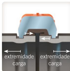
**Junções de tubulações auto-limitadoras** – acoplamentos engatam ranhuras das tubulações para prender os tubos contra pressão total de cargas de impulso sem a necessidade de limitadores complementares.
