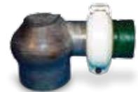
Los acoples FGN Estilo 220/221 ofrecen una junta mecánica para unir tuberías de aleación con reborde y tuberías reforzadas con fibra de vidrio utilizadas en recipientes de desulfurización de gases de combustión. El diseño liviano de un solo perno permite una instalación más sencilla y más rápida que la de las conexiones bridadas tradicionales. Elimina el torque excesivo y el posible "agrietamiento" de las boquillas.
