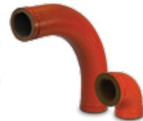
Las conexiones con extremos ranurados pesan mucho menos que los codos bridados y se instalan en un tercio del tiempo necesario para los codos soldados. Se puede aplicar una variedad de revestimientos y recubrimientos a los codos ranurados estándares, 3D, 5D y 6D. Las conexiones con revestimientos y recubrimientos no se ven afectadas durante la instalación, ya que no se genera calor en el proceso de unión.
