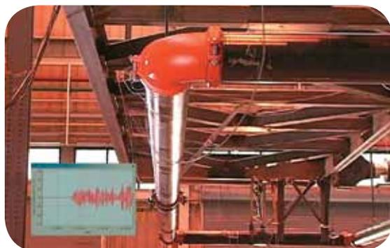
Essais sismiques utilisant des systèmes de tuyauterie Victaulic menés au centre de recherche ATLSS (Advanced Technology for Large Structural Systems) à Bethlehem, Pennsylvanie, États-Unis.
