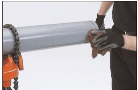
10. Después de que la tubería es ranurada y la herramienta es retirada, limpie cuidadosamente las virutas de la ranura con un paño suave o aire comprimido.
