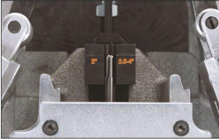
**9c.** Compruebe la alineación de la punta de la fresa de corte con la línea correspondiente en el bloque de alineación. La fresa de corte en la imagen de arriba está ajustada para una tubería de 2.5 a 4 pulg.
