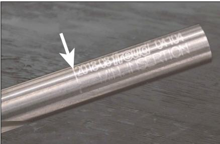
2b. Tome nota de la línea grabada en la base de la fresa. Esta marca la profundidad mínima de inserción al instalar la fresa en la herramienta.
