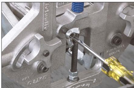
2. Utilizando un destornillador de cabeza plana, gire el tornillo de ajuste "A" en sentido antihorario a fin de ajustar la ubicación de la ranura.
