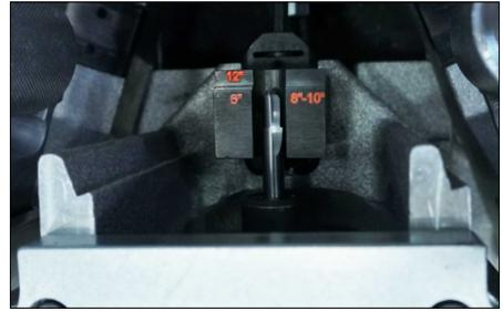
9c. Compruebe la alineación de la punta de la fresa de corte con la línea correspondiente en el bloque de alineación. La fresa de corte en la imagen de arriba está ajustada para una tubería de 6 pulg.
