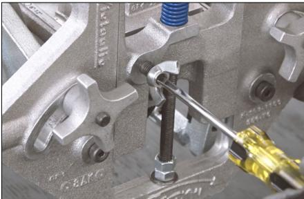
2. Utilizando un desarmador de cabeza plana, gire el tornillo de ajuste "A" en sentido horario a fin de ajustar la ubicación de la ranura.
