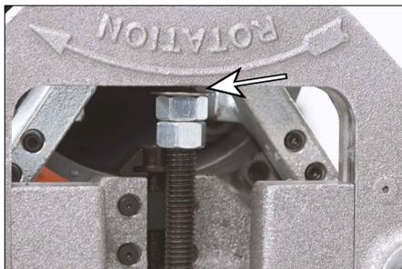
4. Gire la perilla de ajuste del carro del motor en sentido horario a fin de elevar la fresa en la tubería hasta que el tope de profundidad se apoye sobre esta. Cuando el tope de profundidad quede apoyado sobre la tubería, la perilla de ajuste girará fácilmente y la arandela se alejará del cuerpo de la herramienta dejando una separación.
