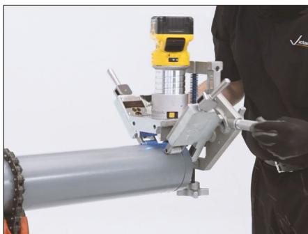
5. Sujete ambas manijas y empuje lentamente la herramienta una rotación completa en sentido horario. Al final de la rotación, empuje la herramienta poco más allá de la posición vertical para asegurar que la ranura esté completa.
