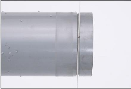
**11.** Una vez que la ranura esté limpia, compruebe su diámetro (dimensión “C”). Un cable de diámetro de tubería, suministrado con la herramienta, es el método recomendado para comprobar la dimensión “C”.
