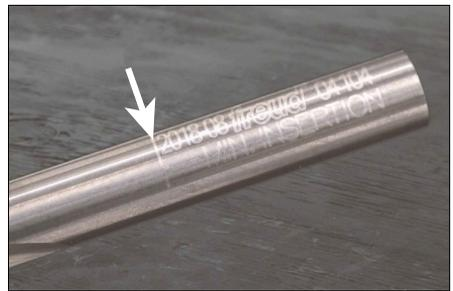
2b. Tome nota de la línea grabada en la base de la fresa. Esta marca la profundidad mínima de inserción al instalar la fresa en la herramienta.
