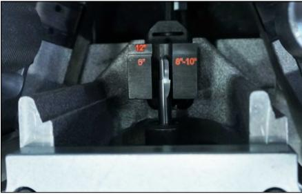
9a. Seleccione la ubicación apropiada de la fresa de corte haciendo coincidir el tamaño de la tubería con la línea correspondiente en el bloque de alineación.
