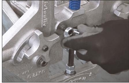
4. Apriete la tuerca mariposa en el tornillo de ajuste "A", situado en la parte frontal de la herramienta.
