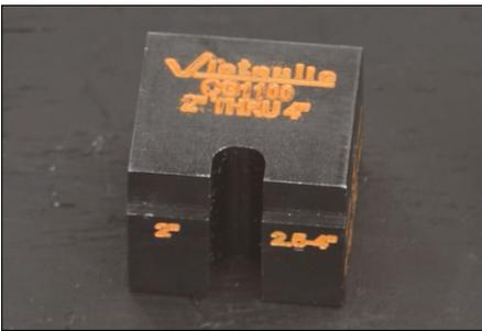
1. Extraiga el bloque de alineación de 2" HASTA 4". Los bloques de alineación están grabados con el tamaño de la tubería en pulgadas.
