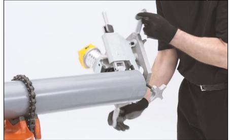
7a. Empuje la herramienta en una rotación completa en sentido horario para comprobar si hay obstrucciones y para permitir que la herramienta se acomode a la tubería. Verifique que la herramienta se mueva libremente durante toda la rotación.
