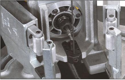
7. Use la llave hexagonal con mango "T" de  $\frac{5}{4}$  pulg. suministrada para aflojar el tornillo de ajuste. Esto permitirá mover el tope de profundidad.
