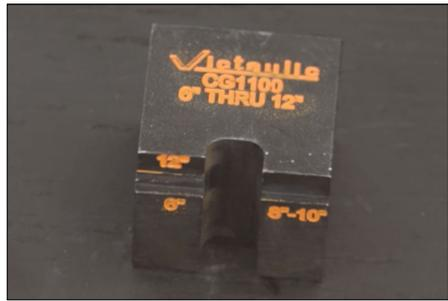
1. Extraiga el bloque de alineación de 6" HASTA 12". Los bloques de alineación están grabados con el tamaño de la tubería en pulgadas.
