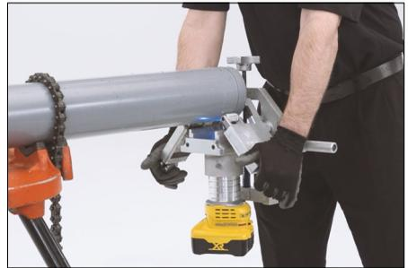
8. Ponga las abrazaderas de palanca en la posición desenganchada.
