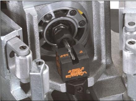
8. Alinee la muesca en la parte posterior del bloque de alineación con el tope de profundidad detrás de la fresa. Deslice el bloque de alineación sobre el tope de profundidad hasta que quede completamente asentado.
