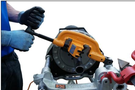
1. Empleando la palanca, haga descender la herramienta PC3110 sobre el extremo de la tubería.
