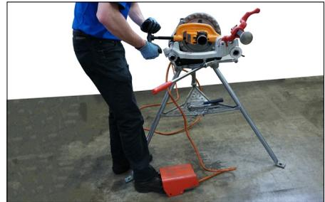
3a. Presione el pedal de accionamiento seguro para arrancar el accionamiento motorizado.
