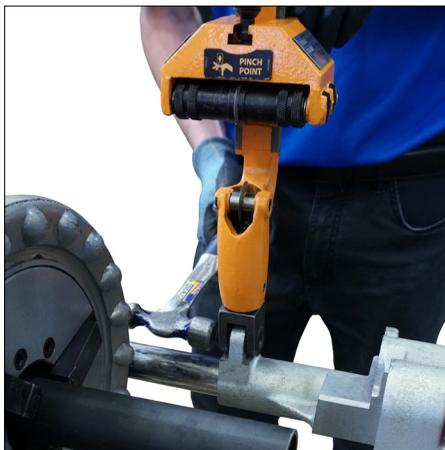
3. Usando un martillo o un mazo, golpee suavemente el pasador de bisagra en la ranura del soporte hasta que quede firme. No fuerce el pasador de bisagra más adentro de la ranura que lo necesario para asegurar la herramienta PC3110.
