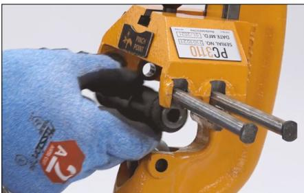
2. Instale el rodillo aplanador nuevo en la parte posterior del cuerpo de la herramienta, como se muestra, y luego inserte el eje de rodillo aplanador nuevo del kit. Golpee ligeramente el eje del rodillo aplanador nuevo para introducirlo en el cuerpo de la herramienta y fijar el rodillo aplanador nuevo.
