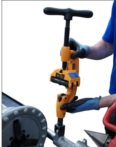
1. Para rotar la herramienta PC3110 para guardarla en el carro, levante el cuerpo de la herramienta PC3110 alejándolo del eje.
