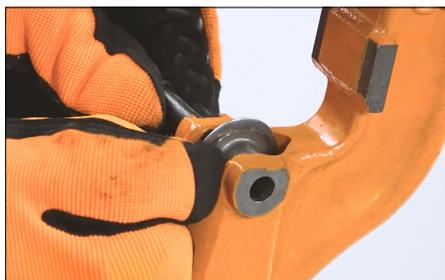
**2.** Instale el disco de corte nuevo e inserte el eje del disco de corte (utilice el eje del disco de corte nuevo si pidió el kit de disco de corte).
