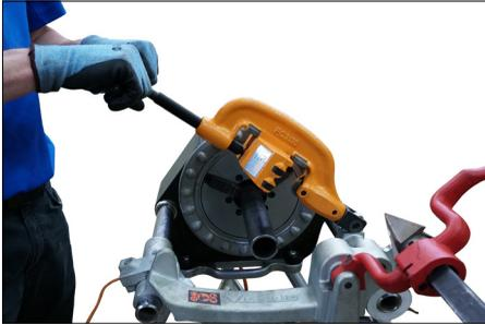
4. Usando la palanca, levante la herramienta PC3110 otra vez a su posición de almacenamiento.
