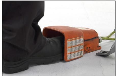
1. Conecte el cable del accionamiento motorizado en un pedal de accionamiento seguro, como se muestra arriba. Consulte el manual de operaciones del fabricante del accionamiento motorizado para ver más información.
