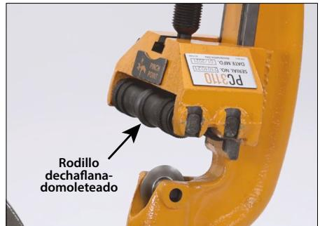
4. Siempre verifique que el rodillo de chaflanado esté instalado en la parte delantera del cuerpo de la herramienta, como se muestra arriba.
