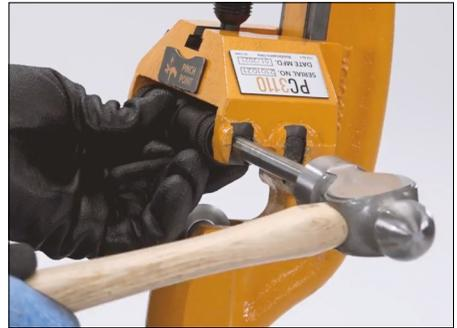
3. Instale el rodillo de chaflanado nuevo en la parte delantera del cuerpo de la herramienta, como se muestra, y luego inserte el eje de rodillo de chaflanado nuevo del kit. Golpee ligeramente el eje del rodillo de chaflanado nuevo para introducirlo en el cuerpo de la herramienta y fijar el rodillo de chaflanado nuevo.
