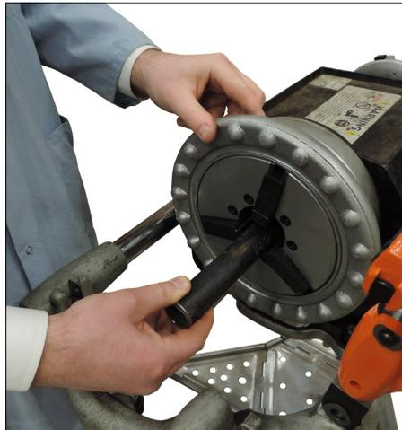
5. Inserte la tubería en el accionamiento motorizado y apriete el mandril a la longitud de tubería adecuada.
