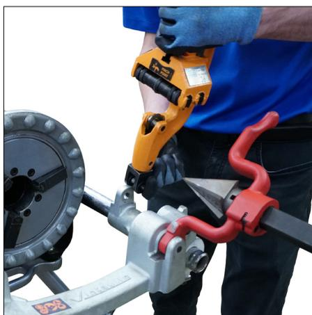
1. Coloque la herramienta PC3110 sobre el soporte en el conjunto del carro.
