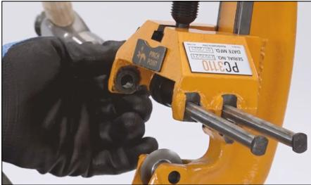
1. Con un martillo y un punzón, golpee cada eje de rodillo para sacarlo del cuerpo de la herramienta. Retire y descarte los rodillos y ejes de rodillo desgastados.
