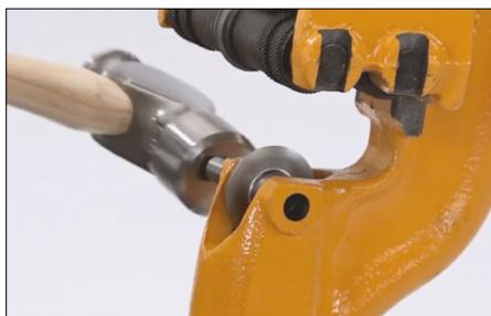
**3.** Golpee suavemente el eje del disco de corte para insertarlo en el cuerpo de la herramienta y asegurar el disco de corte nuevo.
