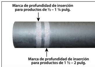
La marca más cercana al extremo de la tubería indica la profundidad de inserción requerida para los productos de tamaños de 1/2 - 1 1/4 pulg., como se muestra.
