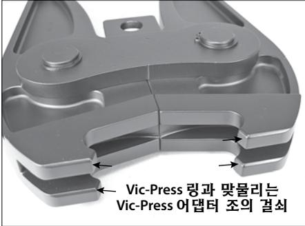
7a. 표준형 Vic-Press 어댑터 조 및 Vic-Press 링의 위치를 정할 때, 배관이 피팅에 완전히 삽입된 상태인지 확인하십시오. 피팅의 끝단이 배관상 표시와 반드시 수평을 이루어야 합니다. 배관 준비 가공 및 표시 요건에 관해서는 항상 I-P500 현장설치핸드북을 참조하시기 바랍니다.
