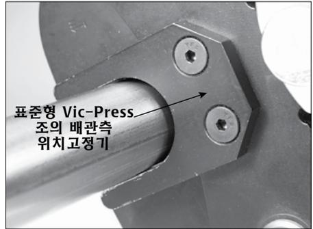
3. 표준형 Vic-Press조를 Vic-Press 스케줄 10S 피팅 위에 놓으십시오. 표준형 Vic-Press 조의 공동(움푹 들어간 부위) 부분이 피팅의 실 포켓 비드와 정렬되어 있는지 확인하십시오. 위 사진에서와 같이 표준형 Vic-Press 조의 배관측 위치고정기가 배관을 감싸도록 해야 합니다. **비고:** 항상 공구/표준형 Vic-Press 조가 배관 측에 직각으로 피팅에 놓이도록 해야 합니다. 표준형 VIC-PRESS 조에서, 배관측 위치고정기를 분리하지 마십시오. 공구의 구성품을 변경하면, 제품을 올바르게 설치할 수 없고 VICTAULIC의 제품 보증을 받을 수 없습니다.
