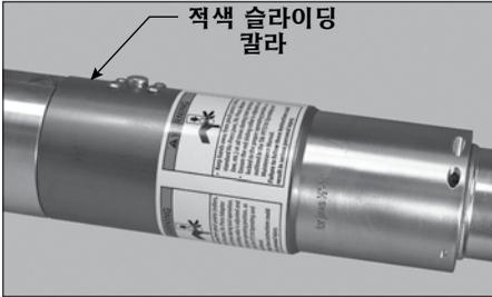
위 사진에서의 위치(적색 슬라이딩 칼라가 상단/앞 부분에 맞물림)는 반드시 1/2 inch / 21.3 mm 및 3/4 inch / 26.9 mm 규격에 적용해야 합니다.
