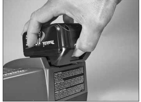
2. 위 사진에서와 같이, 배터리의 버튼을 누르면 배터리 충전기에서 배터리를 빼낼 수 있습니다.
