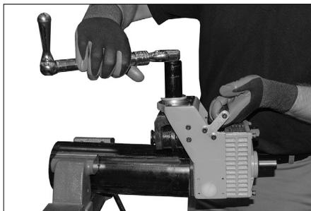
4. Monter l'outil sur le tuyau, puis tourner l'écrou de réglage du diamètre de rainure dans le sens horaire pour abaisser le rouleau supérieur jusqu'à ce que l'outil soit bien appuyé sur le tuyau.
