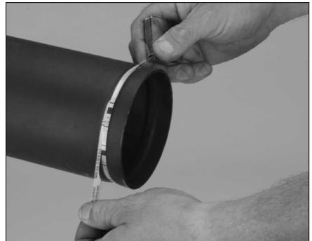
6. Vérifier avec soin le diamètre de la rainure du tuyau (dimension « C ») à l'aide du ruban de vérification Go/No-Go fourni.
