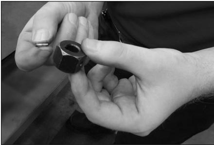
Retirer la goupille de cisaillement à l'aide du poinçon de goupille de cisaillement, puis insérer une goupille de cisaillement neuve. Si toutes les goupilles de cisaillement ont été utilisées, communiquer avec Victaulic pour en commander d'autres.
