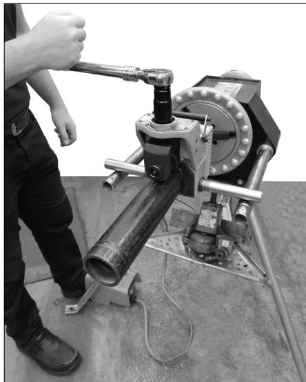
5. Alternier entre tourner l'écrou de réglage du diamètre de rainure et appuyer sur la pédale de sécurité. Ne PAS tourner l'écrou de réglage de diamètre de rainure plus de 0.4 mm (0.016 po) (une ligne) à la fois.
