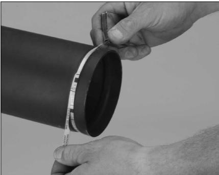
8. Vérifier avec soin le diamètre de la rainure du tuyau (dimension « C ») à l'aide du ruban de vérification Go/No-Go fourni.
