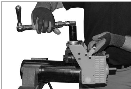
4. Montez l'outil sur le tube, puis tournez l'écran de réglage du diamètre de rainure dans le sens horaire pour abaisser la molette supérieure jusqu'à ce que l'outil repose de manière ajustée sur le tube.
