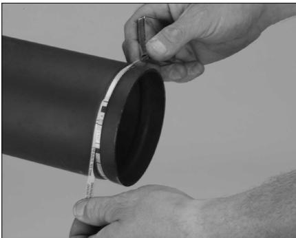
8. Vérifiez avec soin le diamètre de rainurage du tube (dimension « C ») à l'aide du ruban de mesure des rainures Go/No-Go fourni.
