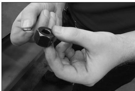
Retirez la goupille de cisaillement à l'aide du chasse-goupille et remplacez-la par une goupille de cisaillement intacte. Si toutes les goupilles de cisaillement fournies ont été utilisées, contactez Victaulic pour commander des pièces de rechange.
