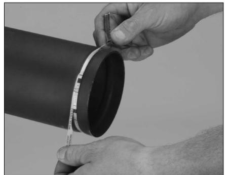
6. Vérifiez avec soin le diamètre de rainurage du tube (dimension « C ») à l'aide du ruban de mesure des rainures Go/No-Go fourni.
