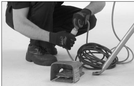
3. Raccordez le cordon d'alimentation du bloc d'entraînement à la commande au pied fournie, comme illustré ci-dessus. Pour en savoir plus, reportez-vous au manuel d'utilisation du fabricant du bloc d'entraînement.
