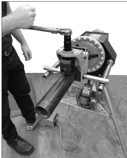
5. Alternez la rotation de l'écrou de réglage du diamètre de rainure avec la pression sur la commande au pied. NE tournez PAS l'écrou de réglage du diamètre de rainure de plus de 0.016 po/0,4 mm (une ligne) à la fois.
