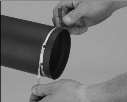
8. Revise cuidadosamente el diámetro de la ranura de la tubería (dimensión "C") con la cinta de diámetro de tubo suministrada.
