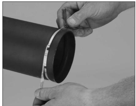
6. Revise cuidadosamente el diámetro de la ranura de la tubería (dimensión "C") con la cinta de diámetro de tubo suministrada.
