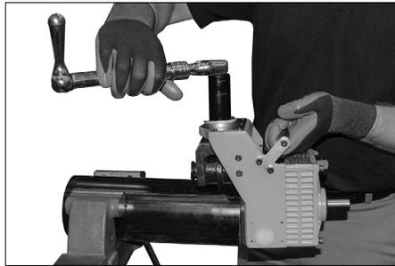
4. Monte la herramienta en el tubo, gire la tuerca de ajuste del diámetro de ranura en sentido horario para bajar el rodillo superior hasta que la herramienta apoye firmemente en el tubo.
