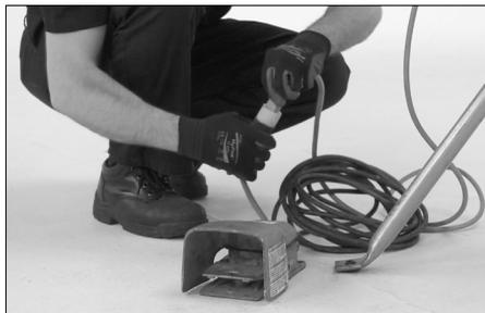
3. Enchufe el cable de la unidad de alimentación en el pedal de seguridad suministrado, como se muestra arriba. Consulte el manual de funcionamiento del fabricante de la unidad de alimentación para información adicional.
