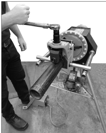
5. Alterne el giro de la tuerca de ajuste del diámetro de ranura con la presión sobre el pedal de seguridad. NO gire la tuerca de ajuste del diámetro de ranura más de 0.016 pulg/0,4 mm (una línea) cada vez.
