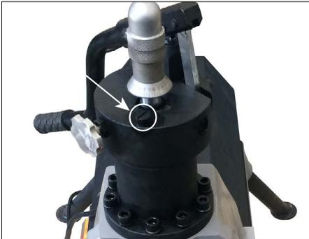
Alivie la presión del sistema hidráulico abriendo la válvula de la bomba hidráulica, y quite el tapón indicado arriba para añadir fluido hidráulico.
