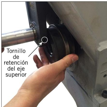
2. Afloje el tornillo de retención del eje superior.
