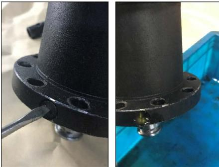
3. Quite la toma de la parte inferior del cilindro. Vacíe el aceite del depósito.
