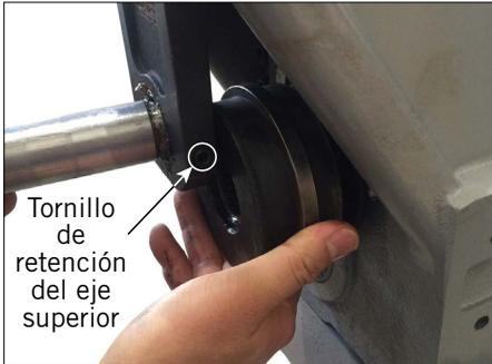
1. Inserte con cuidado el rodillo superior del tamaño deseado tras el portarrodillos superior/corredera con las marcas del rodillo superior hacia fuera.
