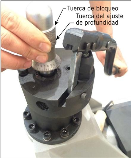
5. Afloje la contratuercas de la tuerca ajustadora de la profundidad. Apriete la tuerca ajustadora de la profundidad hacia abajo contra el tope del cabezal de la herramienta.
