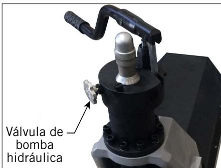
5. Abra la válvula de la bomba hidráulica girando el pomo hacia la izquierda. Esta operación levantará la corredera y el rodillo superior hasta sus posiciones más altas.
