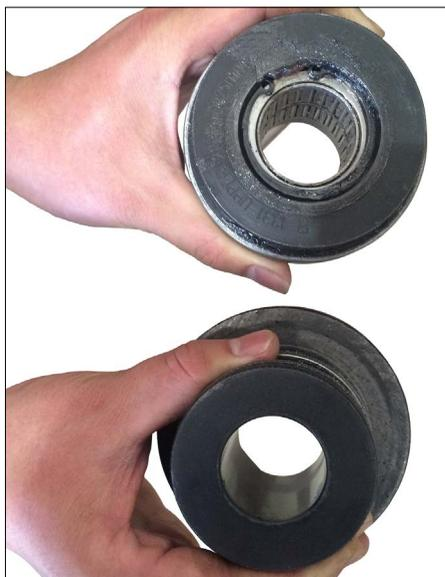
1. Verifique que se ha montado el juego de rodillos correcto en la herramienta. Los rodillos están marcados con el tamaño de tubería y el número de pieza. Si no se han montado los rodillos correctos, se debe cambiar el juego de rodillos según las indicaciones de las páginas 14 y 15.
