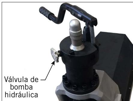
1. Abra la válvula de la bomba hidráulica girando el pomo hacia la izquierda. Esta operación levantará la corredera y el rodillo superior hasta sus posiciones más altas.
