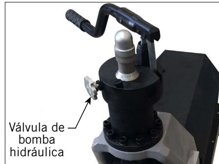
14. Para extraer el tubo, abra la válvula de la bomba hidráulica girando el pomo hacia la izquierda (prepárese para sujetar los tramos cortos de tubería cuando abra la válvula de la bomba hidráulica). Saque el tubo de la herramienta.
