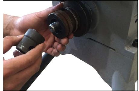
1. Inserte el rodillo inferior del tamaño deseado en el eje principal con el lado marcado hacia fuera.
