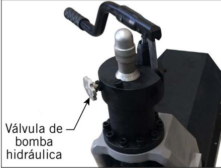
1. Abra la válvula de la bomba hidráulica girando el pomo hacia la izquierda.
