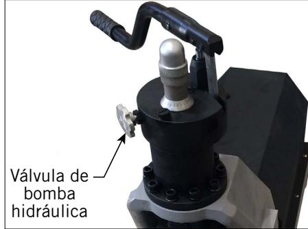
1. Abra la válvula de la bomba hidráulica girando el pomo hacia la izquierda.
