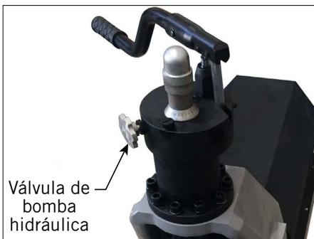
7. Cierre la válvula de la bomba hidráulica girando el pomo hacia la derecha.
