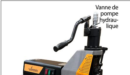
**12.** Pour libérer le tube, ouvrir la vanne de la pompe hydraulique en tournant le bouton dans le sens contraire des aiguilles d'une montre (se préparer à soutenir les tubes courts à l'ouverture de la vanne de la pompe hydraulique). Retirer le tube de l'outil.
