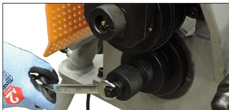
2a. Pour retirer la molette inférieure, la desserrer en tournant dans le sens des aiguilles d'une montre avec une clé de 14 mm (incluse).
