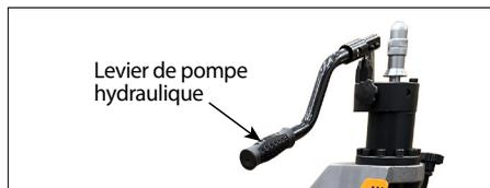
7. Le commutateur de l'opérateur et la pédale doivent être positionnés sur le côté gauche de l'outil avec le levier de la pompe hydraulique.
