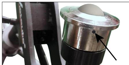
Le support de tube doit être lubrifié régulièrement. Chaque semaine, appliquer une huile légère pour machine à l'endroit indiqué ci-dessus sur chaque unité à bille universelle. Étaler l'huile légère pour machine en faisant tourner les unités à bille universelles.
