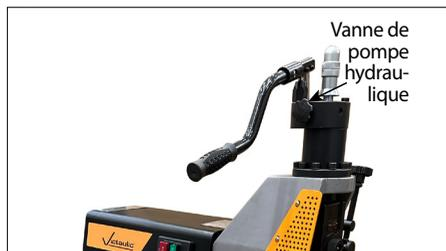
1. Ouvrir la vanne de la pompe hydraulique en tournant le bouton dans le sens contraire des aiguilles d'une montre. Ceci mettra la glissière et la molette supérieure dans leurs positions les plus hautes.
