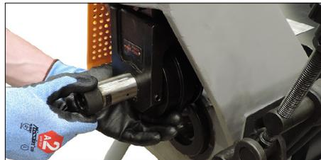
3. Tout en maintenant la molette supérieure, retirer la tige supérieure du support de la glissière en la tirant directement hors de l'outil. Retirer la molette supérieure et la stocker dans un endroit sûr pour une utilisation ultérieure.
