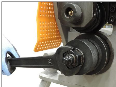
2. Desserrer l'écrou de maintien de la molette inférieure avec une clé de 38 mm (incluse).
