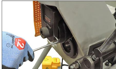
2. Desserrer la vis de maintien de la tige supérieure avec la clé hexagonale de 5 mm (incluse). NE PAS retirer complètement cette vis.
