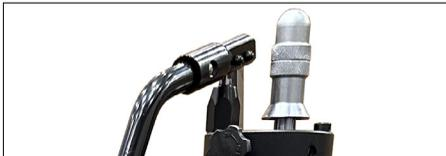
2. Régler l'écrou de réglage de la profondeur et l'écrou de blocage assez haut pour que la glissière ait suffisamment d'espace pour aller jusqu'au tube.
