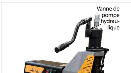
1. Ouvrir la vanne de la pompe hydraulique en tournant le bouton dans le sens contraire des aiguilles d'une montre. Ceci mettra la glissière et la molette supérieure dans leurs positions les plus hautes.
