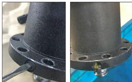
3. Remettre en place le bouchon en bas du vérin. Vidanger l'huile dans le bac.
