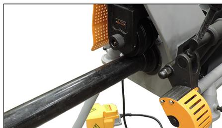
5. Insérer un bout de tube de diamètre et épaisseur adéquats sur la molette inférieure.
