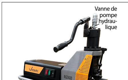
4. Ouvrir la vanne de la pompe hydraulique en tournant le bouton dans le sens contraire des aiguilles d'une montre. Ceci mettra la glissière et la molette supérieure dans leurs positions les plus hautes.
