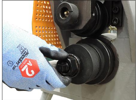
**5.** Placer l'écrou de retenue de la molette inférieure sur l'adaptateur de la molette inférieure et le serrer à la main.
