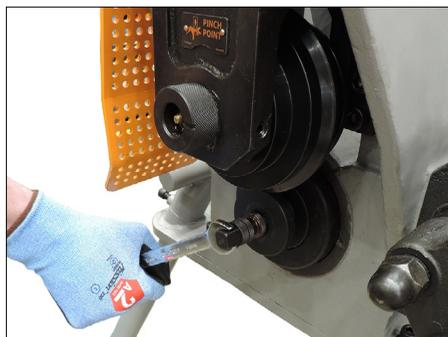
2. Pour retirer la molette inférieure, desserrer en tournant dans le sens contraire des aiguilles d'une montre avec une clé de 14 mm (incluse).
