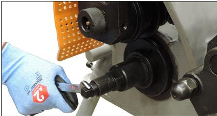
**2.** Serrer l'adaptateur de la molette inférieure en tournant dans le sens contraire des aiguilles d'une montre avec une clé de 14 mm (incluse).
