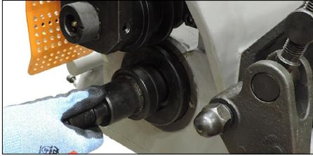
**1.** Insérer l'adaptateur de la molette inférieure requis pour les molettes de plus grande dimension dans l'alésage de la molette inférieure jusqu'à ce qu'il soit en contact avec le corps de l'outil.
