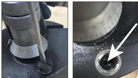
2. Desserrer le bouchon du réservoir et le mettre de côté. Remplir jusqu'à ce que le niveau d'huile atteigne presque l'orifice d'entrée. **REMARQUE :** Pour éviter tout déversement d'huile par l'orifice de débordement du bouchon du réservoir, maintenir la pompe hydraulique de niveau et **NE PAS** remplir excessivement le réservoir.
