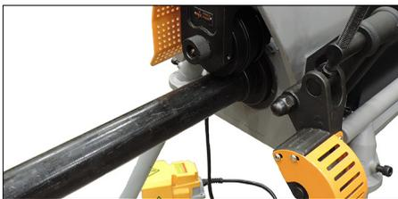
3. Insérer un bout de tube de diamètre et épaisseur adéquats sur la molette inférieure.
