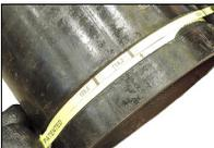
9. Après avoir préparé la rainure d'essai et avoir retiré le tube de l'outil, vérifier minutieusement le diamètre de rainure « C ».
