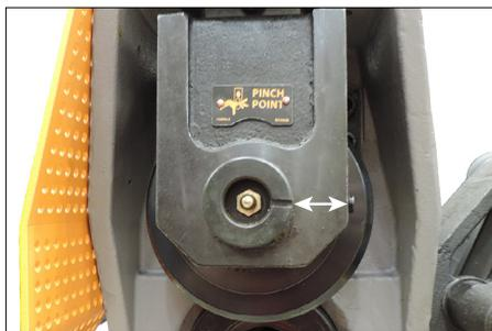
3. Aligner la fente sur la tige supérieure avec la vis de retenue de la tige supérieure.
