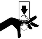
**Les molettes de rainurage risquent d'écraser ou de sectionner les doigts et les mains.**
