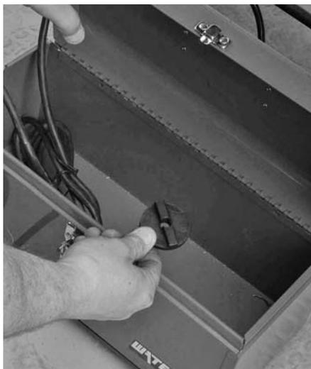
**4.** Legen Sie Antriebskeil, Sechskantschraube und Sicherungsscheibe in das Aufbewahrungsfach für den Sicherheitsfußschalter, damit diese Teile immer verfügbar sind.
