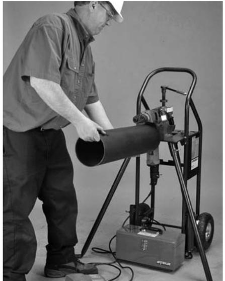
3. Führen Sie eine Rohrlänge der richtigen Größe und Dicke über die untere Rolle ein.
