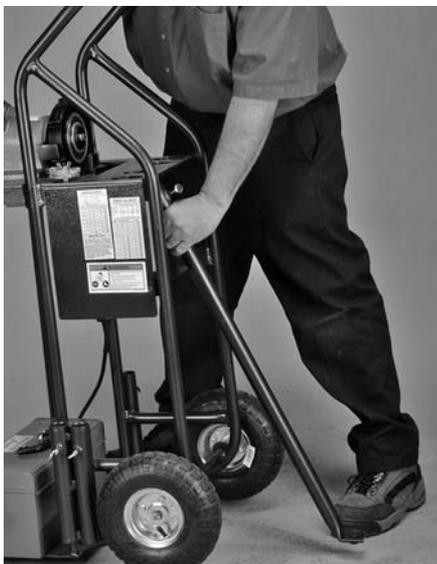
**6.** Wenn sich das Werkzeug in der vertikalen (aufrechten) Position befindet, montieren Sie das dritte Bein in den Sockel neben dem Antriebsmotor. Drehen Sie das Bein so, dass der Fuß vom Werkzeug weg zeigt. Ziehen Sie mit Hilfe eines Schraubenschlüssels  $\frac{1}{2}$  Zoll die Sechskantschraube  $\frac{5}{16}$  bis 18 fest, um das Bein am Werkzeug zu sichern.
