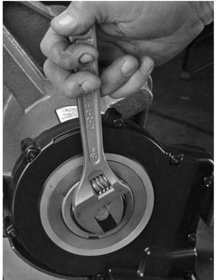
1. Heben Sie den Arm der oberen Rolle in die höchstmögliche Position, indem Sie die Vorschubschraube **entgegen dem Uhrzeigersinn** drehen.
