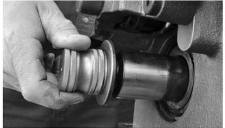
**4.** Bauen Sie die untere Rolle/Hauptwelle in den Werkzeugkopf ein. Halten Sie das gerändelte Ende (untere Rolle) der Hauptwelle fest und stellen Sie sicher, dass die Flächen am Antriebsende der Hauptwelle mit den Flächen am Antriebsmotor ausgerichtet sind.
