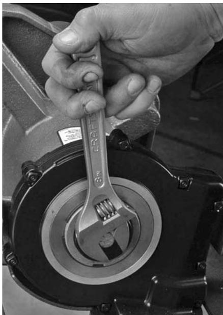
**6.** Bauen Sie die Sicherungsscheibe an und ziehen Sie die  $\frac{3}{8}$ -Zoll-Sechskantschrauben fest, um den Antriebskeil zu sichern.
