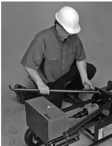
**4.** Entnehmen Sie die Beine aus den Beinablagern. Montieren Sie die beiden Vorderbeine. Führen Sie dazu die Beine in die Sockel an der Unterseite des Werkzeugkopftisches ein. Stellen Sie sicher, dass jedes Bein ordnungsgemäß in seinem Sockel sitzt. Drehen Sie die Beine so, dass die Füße vom Werkzeug weg zeigen. Ziehen Sie mit Hilfe eines Schraubenschlüssels  $\frac{1}{2}$  Zoll die einzelnen Sechskantschrauben  $\frac{5}{16}$  bis 18 fest, um die Beine am Werkzeug zu sichern.
