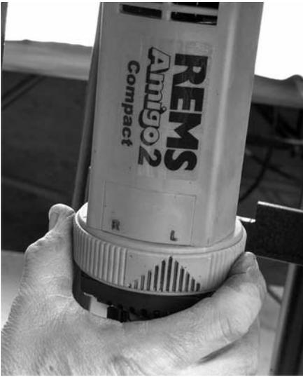
**10.** Drehen Sie den Schalter des Antriebsmotors in den Position „L“, um, wie oben dargestellt, eine Drehung von unterer Rolle/Hauptwelle und Rohr **ENTGEGEN DEM UHRZEIGERSINN** zu erreichen.
