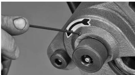
**1.** Lösen Sie mit Hilfe eines Innensechskantschlüssels  $\frac{3}{32}$  Zoll (nicht mitgeliefert) die Einstellschraube oben vorn am Gesenkarm.
