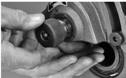
**2.** Bereiten Sie sich auf das Abstützen der oberen Rolle vor und schieben Sie die obere Welle aus dem Gesenkarm.
