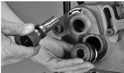
**3.** Entnehmen Sie die obere Rolle. Lagern Sie die obere Rolle im Aufbewahrungsfach für den Sicherheitsfußschalter.
