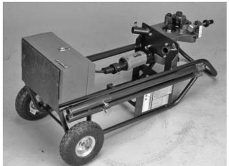
3. Stellen Sie sicher, dass das Werkzeug sicher in horizontaler Lage steht (liegt), wobei der Griff des Wagens wie oben dargestellt auf dem Fußboden aufliegen muss.
