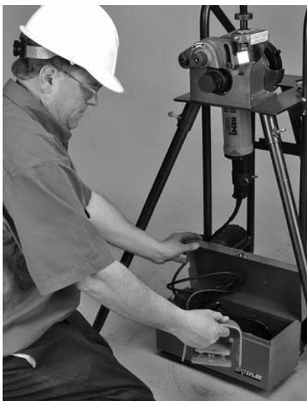
**9.** Entnehmen Sie den Sicherheitsfußschalter aus dem Aufbewahrungsfach.
