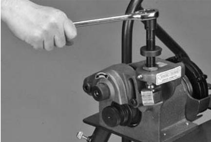
2. Ziehen Sie mit Hilfe des mitgelieferten Ratschenschlüssels  $\frac{3}{8}$  Zoll die Vorschubschraube / obere Rolle zurück (entgegen dem Uhrzeigersinn drehen), bis das Rohr vollständig über die untere Rolle geschoben werden kann.
