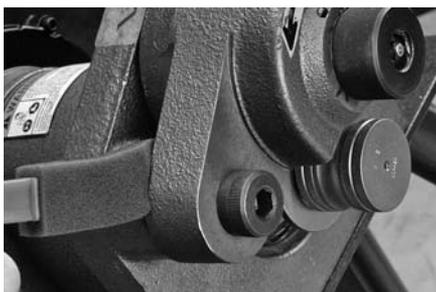
**4** Fetten Sie alle Positionen, an denen der Rollenarm am Werkzeuggestell gleitet.
