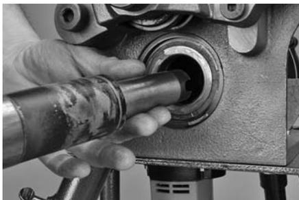
**6.** Nehmen Sie die untere Rolle/Hauptwelle von vorn aus dem Werkzeugkopf. Entfernen Sie mit Hilfe eines weichen Tuches Schmutz und überflüssiges Fett von der unteren Rolle/Hauptwelle.
