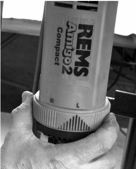
**3.** Stellen Sie den Schalter am Antriebsmotor auf die Position, in der sich die untere Rolle/Hauptwelle und das Rohr von vorne betrachtet **entgegen dem Uhrzeigersinn** drehen. Durch das Schalten des Schalters in die Position „L“ drehen sich untere Rolle/Hauptwelle und das Rohr entgegen dem Uhrzeigersinn.
