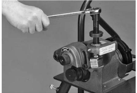
**5.** Drehen Sie mit Hilfe des Ratschenschlüssels  $\frac{3}{8}$  Zoll (mitgeliefert) die Vorschubschraube **entgegen dem Uhrzeigersinn**, um die obere Rolle in die Position ganz oben zu bringen.
