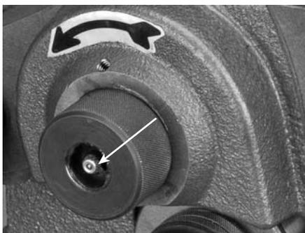
**5** Fetten Sie nach 8 Betriebsstunden die Schmierstelle der Welle der oberen Rolle.
