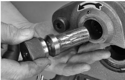
**3.** Setzen Sie die obere Welle in den Gesenkarm und die obere Rolle ein.
