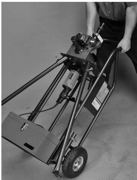
**5.** Stellen Sie sicher, dass die Vorderbeine sicher in den Sockeln befestigt sind. Heben/Kippen Sie das Werkzeug wie oben dargestellt in die vertikale (aufrechte) Position.
