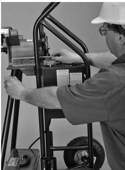
**7.** Richten Sie das Werkzeug von vorne nach hinten waagrecht aus. **HINWEIS:** Im oberen Bereich des Werkzeugkopftisches können Sie eine Wasserwaage aufsetzen (siehe Abbildung). Wenn das Werkzeug nicht waagrecht steht, fahren Sie mit Schritt 7a fort.
