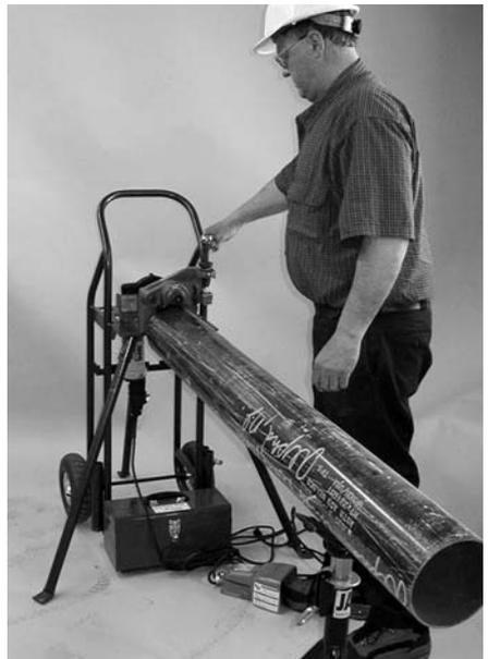
**10.** Stellen Sie bei langen Rohren, die durch einen Rohrbock gestützt werden, sicher, dass das Rohr ein Gefälle aufweist und ordnungsgemäß positioniert ist. Siehe Abschnitt „Lange Rohrlängen“ auf Seite 11.
