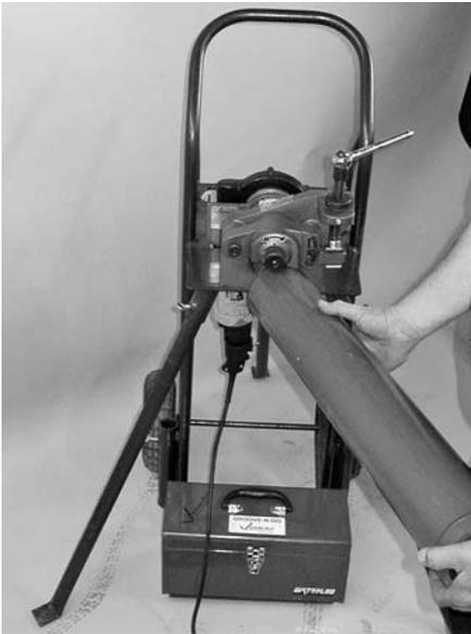
**6.** Führen Sie eine Rohrlänge der richtigen Größe und Dicke über die untere Rolle ein.
