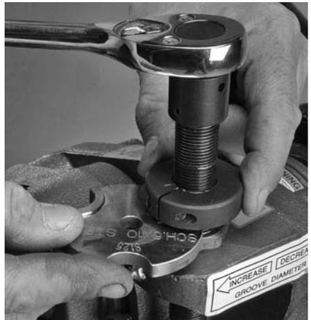
**7.** Stellen Sie den Nuttiefenanschlag mit Hilfe des Nuttiefenmessers als „Fühlerle“ zwischen Nuttiefenanschlag und Gehäusemutter so ein, dass der Nuttiefenanschlag den Nuttiefenmesser wie oben dargestellt berührt.
