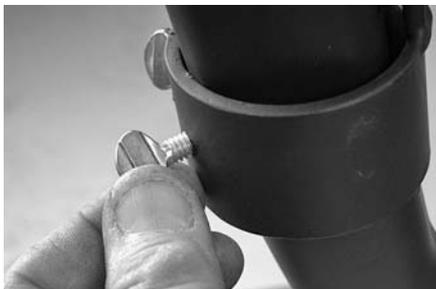
**8a.** Ziehen Sie die beiden Rändelschrauben des Auslöseschalters fest, um den Schalter in dieser Position zu arretieren.
