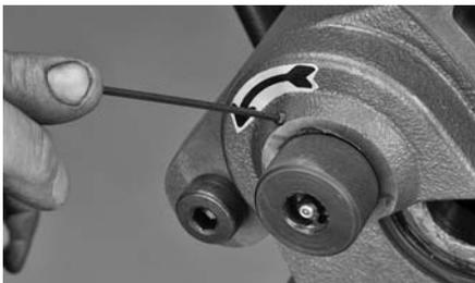
**4.** Ziehen Sie die Einstellschraube fest, um die obere Welle in ihrer Position zu sichern. Stellen Sie sicher, dass sich die obere Rolle frei dreht.
