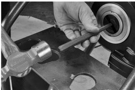
**5.** Schlagen Sie mit Hilfe eines Dorns und eines Hammers (beides nicht mitgeliefert) die untere Rolle/Hauptwelle wie oben dargestellt aus dem Werkzeug.
