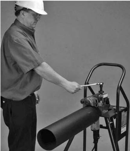
**5.** Stützen Sie das Rohr weiterhin von Hand. Drehen Sie mit Hilfe des Ratschenschlüssels  $\frac{3}{8}$  Zoll die Vorschubschraube heran (im Uhrzeigersinn drehen), um die obere Rolle in leichten Kontakt mit dem Rohr zu bringen.
