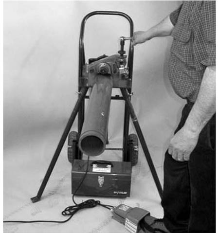
**8.** Drehen Sie die Vorschubschraube **im Uhrzeigersinn**, um die obere Rolle so nach unten zu bringen, dass diese fest am Rohr anliegt. Halten Sie das Rohr weiterhin von Hand fest oder verwenden Sie bei langen Rohren einen Rohrbock. Siehe Abschnitt „Lange Rohrlängen“ auf Seite 11.
