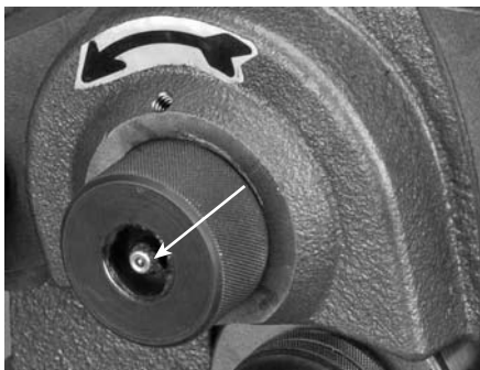
5. Ogni otto ore di funzionamento applicare del grasso sull'ingrassatore dell'albero del rullo superiore.
