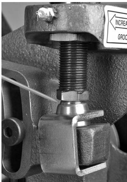
3. Applicare del grasso sul giunto sferico dello snodo a ginocchiera.
