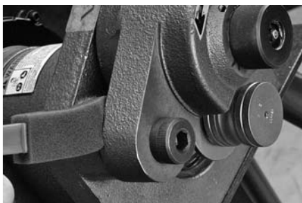
4. Lubrificare i punti in cui il braccio del rullo scivola sul corpo utensile.
