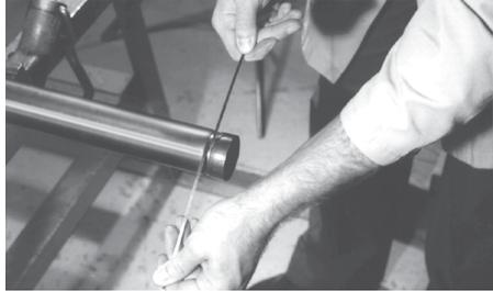
4. Après avoir retiré la rainureuse du tube, vérifiez le diamètre de la rainure pour vérifier que la rainure corresponde à la spécification.
