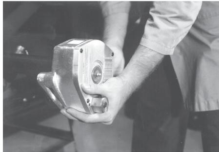
**2.** Avec l'écrou d'entraînement en position basse, insérez la molette de rainurage inférieure dans l'extrémité du tube. Poussez la rainureuse sur le tube jusqu'à ce que la butée d'extrémité de tube se positionne sur l'extrémité du tube.
