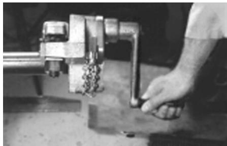
**4.** Placez la manivelle sur l'écrou hexagonal d'entraînement. Tournez l'écrou d'entraînement dans le sens des aiguilles d'une montre ou dans le sens inverse jusqu'à ce que la rainureuse se déplace d'un tour complet autour du tube.
