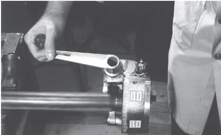
2. Tournez l'écrou sans fin dans le sens inverse des aiguilles d'une montre afin de rétracter le bras supérieur de la molette jusqu'à l'obtention de la position complètement ouverte.
