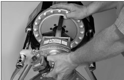
8. Ziehen Sie das Spannfutter an. Vergewissern Sie sich, dass die Spannbacken an den flachen Stellen an der Antriebswelle eingreifen.
