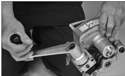
3. Drehen Sie die Vorschubmutter **gegen den Uhrzeigersinn**, um den Rollenarm vollständig einzuziehen.
