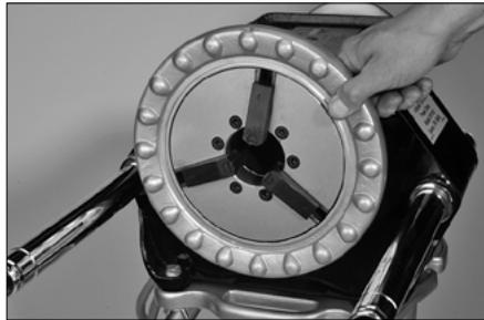
5. Öffnen Sie das Spannfutter des Motorantriebs vollständig. Siehe dazu die Anweisungen des Motorantriebsherstellers.
