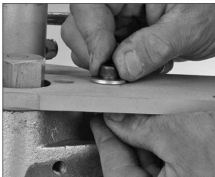
**5a.** Stecken Sie eine Sechskantschraube in ein Loch an der Montageplatte und am Werkzeuggehäuse. Bringen Sie eine Sicherungsscheibe am Ende der Sechskantschraube an und schrauben Sie eine Sechskantmutter auf das Ende der Sechskantschraube. Wiederholen Sie diesen Vorgang am anderen Loch an der Montageplatte und am Werkzeuggehäuse.
