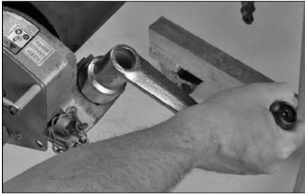
5. Drehen Sie die Vorschubmutter **im Uhrzeigersinn**, um die Rollen zusammen zu ziehen. Drehen Sie die Vorschubmutter weiter **im Uhrzeigersinn**, bis die Nutrollen in festem Kontakt mit dem Rohr sind.
