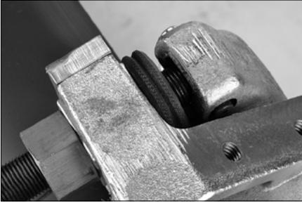
**11.** Fahren Sie mit dem Nuten fort, indem Sie die Vorschubmutter drehen, um die Nutrolle vorzuschieben, bis der Tiefenanschlagring den Drehzapfen berührt. Zu diesem Zeitpunkt kann die Vorschubmutter nicht weiter vorgeschoben werden.
