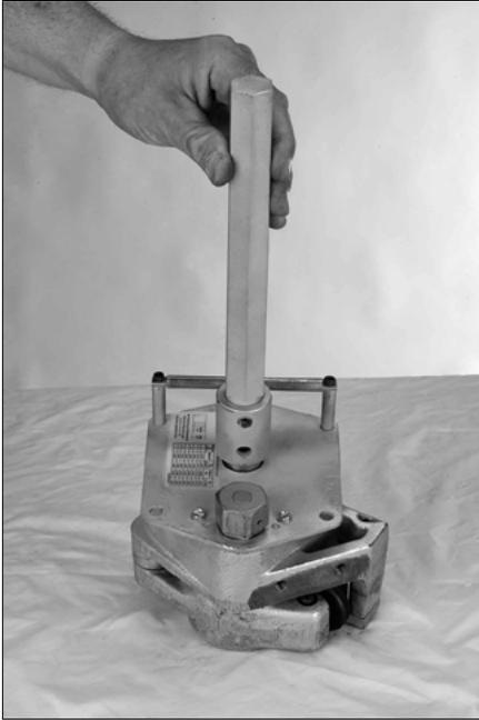
1. Bringen Sie die Baugruppe aus Antriebswelle/ Antriebsadapter wie oben abgebildet am Ende der unteren Welle an. **ANMERKUNG:** Vergewissern Sie sich, dass die Löcher in der Baugruppe aus Antriebswelle/Antriebsadapter mit den Löchern in der inneren Nutrollenwelle ausgerichtet sind.
