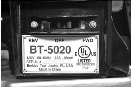
10. Stellen Sie den Schalter des Motorantriebs auf die Position, die von der Vorderseite des Werkzeugs aus gesehen eine Rotation des Spannfutters **im Uhrzeigersinn** bewirkt. Wenn der Schalter am Victaulic Motorantrieb VPD752 oder am Ridgid 300 auf die Position **REVERSE** (Rückwärts) gestellt wird, bewirkt dies eine Rotation des Spannfutters, der unteren Rolle und des Rohrs **im Uhrzeigersinn**.
