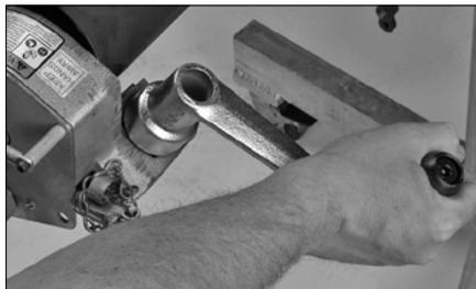
2. Drehen Sie die Vorschubmutter im Uhrzeigersinn, um das Rohr im Werkzeug einzuspannen. Drehen Sie die Vorschubmutter weiter im Uhrzeigersinn, bis die Nutrollen in festem Kontakt mit dem Rohr sind.
