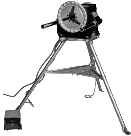
Der Victaulic Motorantrieb VPD752 kann als Motorantriebsaggregat für mehrere unterschiedliche Rollnutwerkzeugmodelle mit der richtigen Grundplatte verwendet werden. Der Motorantrieb verfügt über einen 60-Hz-Universalmotor und benötigt eine einphasige Stromversorgung mit 115 V/15 A. Für den ordnungsgemäßen Betrieb ist ein Sicherheitsfußschalter enthalten. Wenden Sie sich für Einzelheiten bitte an Victaulic.
