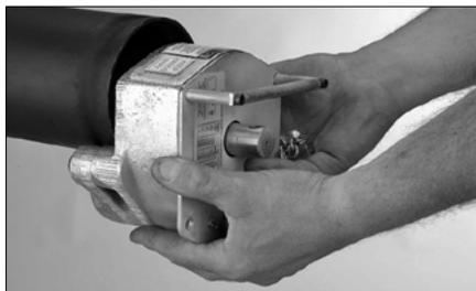
4. Stecken Sie den Ansatz des Werkzeuggehäuses mit nach unten gerichteter Antriebsmutter (untere Position) in das Rohrende. Schieben Sie das Werkzeug auf das Rohr, bis das Rohrende die beiden Rohrendanschläge berührt.
