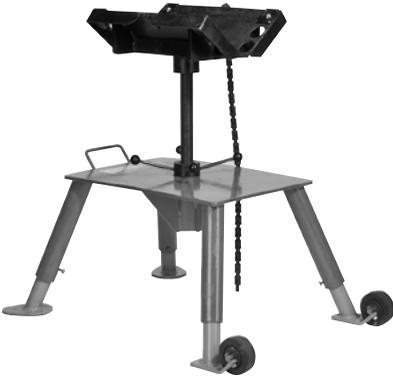
Der Victaulic VAPS 112 ist ein tragbarer, verstellbarer Rohrständer mit Rollen, der für zusätzliche Stabilität mit vier Beinen ausgestattet ist. Für ¾- bis 12-Zoll-Rohre einstellbare Kugelbahnrollen gleichen lineare und Drehbewegungen aus. Die Drehkreuzkonstruktion ermöglicht ein einfaches Nuten beider Rohrenden. Wenden Sie sich für Einzelheiten bitte an Victaulic.
