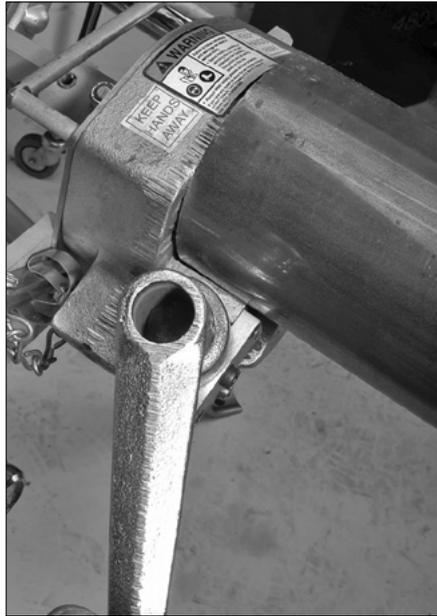
7a. Drehen Sie die Vorschubmutter **im Uhrzeigersinn**, um die Rollen zusammen zu ziehen. Drehen Sie die Vorschubmutter weiter **im Uhrzeigersinn**, bis die Nutrollen in festem Kontakt mit dem Rohr sind.
