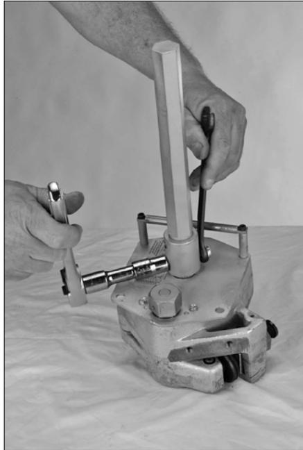
3. Ziehen Sie die Sechskantmutter mit Nyloneinsatz an, um die Baugruppe aus Antriebswelle/Antriebsadapter an der inneren Nutrollenwelle zu sichern.
