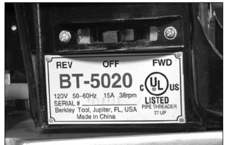
9. Vergewissern Sie sich, dass der Schalter am Motorantrieb auf der Position „OFF“ steht. Schließen Sie den Motorantrieb an eine intern geerdete Steckdose an. Die Steckdose muss die Anforderungen für den Motorantrieb erfüllen (siehe die Anweisungen des Motorantrieberstellers). Falls ein Verlängerungskabel verwendet wird, siehe dazu den Abschnitt „Anforderungen an Verlängerungskabel“.
