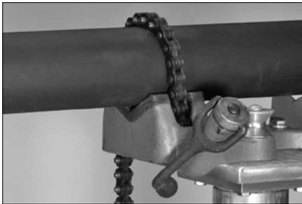
3. Spannen Sie ein Stück Rohr in den Rohrschraubstock ein. Das Rohr muss so positioniert und der Schraubstock so befestigt werden, dass das Gewicht des Werkzeugs (10 kg) zuzüglich des zur Betätigung des Werkzeugs nötigen Kraftaufwands (ca. 27 N•m Drehmoment) sicher gehalten wird. Positionieren Sie das Rohr so, dass es wie abgebildet um ca. 125–300 mm aus dem Schraubstock ragt, damit sich das Werkzeug frei drehen kann.
