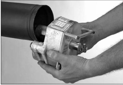
2. Stützen Sie das Werkzeug ab und drehen Sie die Vorschubmutter **gegen den Uhrzeigersinn**, um die Nutrolle und den Arm auf die ganz geöffnete Position zurückzuziehen.
