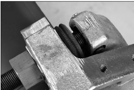
11. Fahren Sie mit dem Nuten fort, indem Sie die Nutrolle vorschieben und das Werkzeug um das Rohr drehen, bis der Tiefenanschlagring den Drehzapfen berührt. An diesem Punkt kann die Nutrolle nicht weiter vorgeschoben werden.
