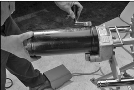
**14.** Stützen Sie das Rohr von Hand ab, wenn sich ein kurzes Rohrstück im Werkzeug befindet.
