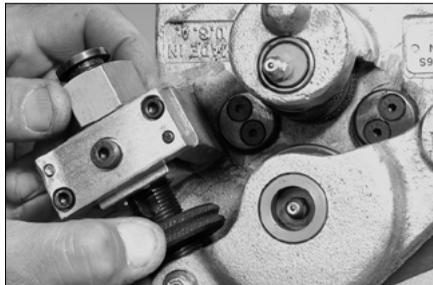
1. Drehen Sie die Tiefenanschlagringe in entgegengesetzte Richtungen, um sie zu lösen und voneinander zu trennen.
