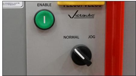
12. Placer le sélecteur de mode de fonctionnement sur le côté de l'outil à la position « NORMAL ».
