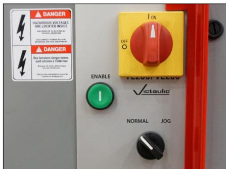
3. Placer le commutateur d'alimentation sur le côté de l'outil à la position « ON ». Placer le sélecteur de mode de fonctionnement sur le côté de l'outil à la position « NORMAL ».
