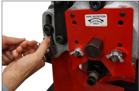
4. Dévisser le bouton de butée du corps de l'outil en le tournant dans le sens antihoraire. Ranger le bouton de butée dans l'armoire à outils.
