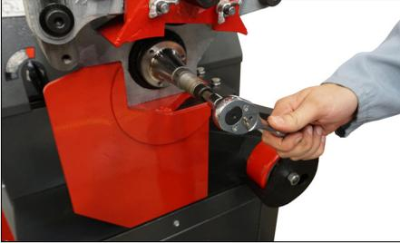
2. Placer une clé sur la vis d'assemblage du goujon, desserrer le goujon en tournant en **sens antihoraire**. Le mandrin devrait se déplacer vers l'extérieur lorsque le goujon est desserré.
