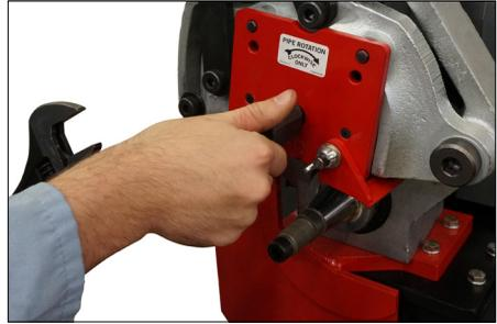
4. Poser le boulon du rouleau supérieur, puis le serrer fermement à l'aide d'une clé.
