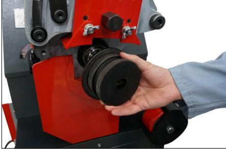
1. Poser le rouleau inférieur sur le mandrin. Au besoin, repositionner les protecteurs de rouleau pour faciliter l'installation. Aligner la prise carrée du rouleau inférieur avec celle du mandrin.
