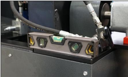
2. L'outil VE268 est conçu pour être fixé de manière permanente et doit être placé sur un plancher ou une dalle en béton au niveau. Lorsque l'emplacement d'installation sera choisi, l'outil devra être mis au niveau et solidement ancré. Un outil qui n'est pas au niveau peut nuire considérablement au fonctionnement et à la sécurité du rainurage. Lors de la vérification du niveau de l'outil, placer le niveau directement sur le cadre de l'outil, comme montré ci-dessus.
