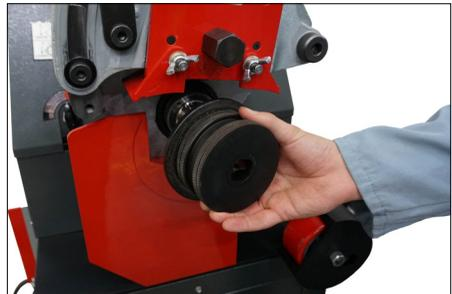
4. Retirer l'écrou, la rondelle et le rouleau inférieur. Ranger ces composants dans l'armoire à outils.
