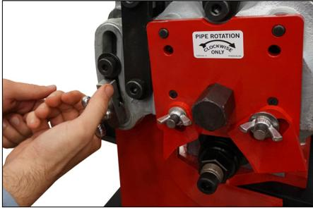
5. Visser le bouton de butée en aluminium sur le trou taraudé de  $\frac{3}{8}$  - 16 UNC situé sur la face de la glissière.
