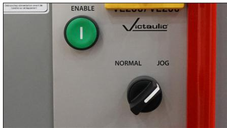
8b. Placer le sélecteur de mode de fonctionnement sur le côté de l'outil à la position « JOG » (marche pas-à-pas). La tête de l'outil devrait s'abaisser lorsque la pédale est enfoncée, puis demeurer en place lorsque la pédale est relâchée.
