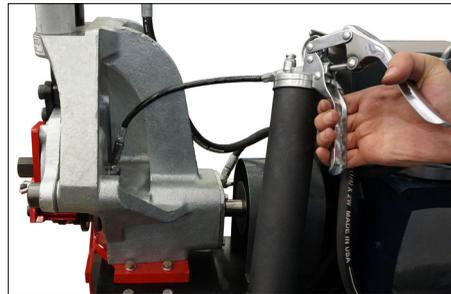
1. Graisser les roulements du rouleau supérieur chaque fois que les rouleaux sont changés ou après 8 heures d'utilisation. L'outil comprend un raccord de graissage, montré ci-dessus. Se reporter au chapitre « Lubrifiants recommandés » pour connaître la graisse à utiliser.
