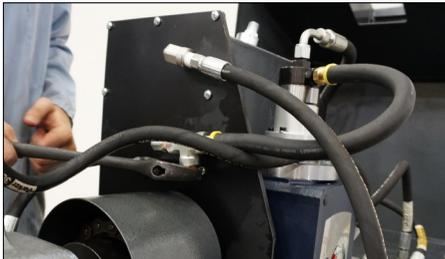
2. Retirer le bouchon de vidange situé dans la canalisation hydraulique à côté du réservoir. Laisser l'huile s'écouler dans un contenant d'une contenance minimale de 1,5 gallon/6 litres.
