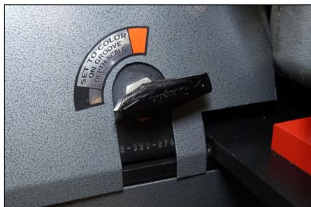
4. Régler le sélecteur sur l'avant de l'outil avec la couleur qui correspond au diamètre et au calibre de tuyau (ROUGE ou NOIR) sur l'étiquette de diamètre de tuyau.
