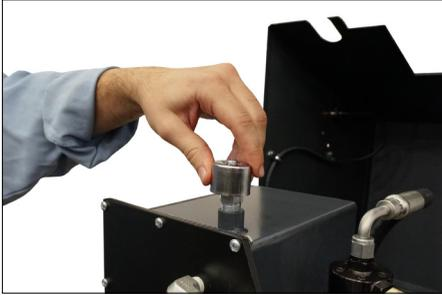
9. Le niveau d'huile ne doit pas être à moins de  $\frac{1}{2}$  po/13 mm sous le dessus du réservoir. Se reporter au tableau « Lubrifiants recommandés » pour connaître l'huile hydraulique à utiliser. Réinstaller le capuchon du renflard hydraulique situé sur le dessus du réservoir hydraulique.
