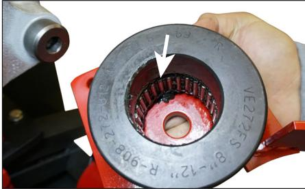
2. Contrôler la lubrification et la libre rotation du roulement à rouleaux à l'intérieur du rouleau supérieur. Vérifier si les protecteurs du rouleau sont usés et s'ils se déplacent librement. Au besoin, réparer ou remplacer les composants endommagés.
