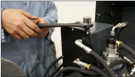
1. Retirer le capuchon du renflard hydraulique situé sur le dessus du réservoir hydraulique.
