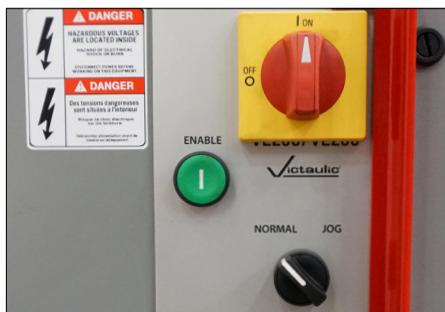
3. Placer le commutateur d'alimentation sur le côté de l'outil à la position « ON ». S'assurer que le sélecteur de mode de fonctionnement sur le côté de l'outil à la position « NORMAL ». L'ensemble du bras et du rouleau supérieurs retourne à sa position la plus élevée.
