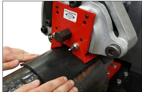
8. Retirer le gabarit de garde du tuyau de son crochet de rangement. Tenir le gabarit fermement contre le tuyau tout en poussant le tuyau sous les protecteurs réglables jusqu'à ce qu'il s'appuie contre le rouleau supérieur.
