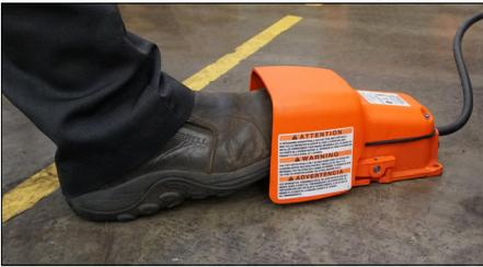
11. Pour commencer le rainurage, maintenir la pédale de sécurité enfoncée. Cela permet de faire avancer le rouleau supérieur pour qu'il entre en contact avec le tuyau. Le tuyau et le rouleau inférieur commenceront à tourner et la rainure sera formée.
