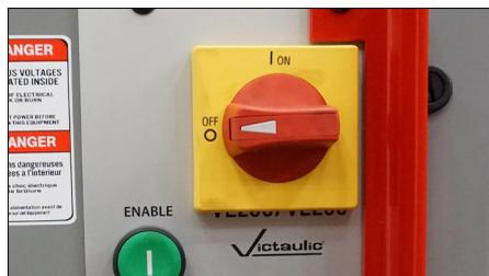
1. Placer le commutateur d'alimentation sur le côté de l'outil à la position « OFF ».
