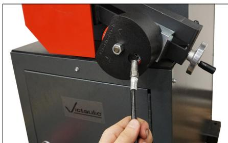
4. Lubrifier la roue stabilisatrice par l'intermédiaire du raccord de graissage, montré ci-dessus. Se reporter au chapitre « Lubrifiants recommandés » pour connaître la graisse à utiliser.
