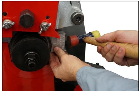
3. Pour desserrer le rouleau inférieur du mandrin, utiliser le coin en aluminium fourni avec l'outil. Placer la cale derrière le rouleau inférieur et frapper la cale à l'aide d'un marteau à tête douce pour détacher le rouleau inférieur de l'arbre fuseau. NE PAS frapper directement sur le rouleau inférieur avec le marteau.
