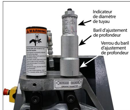
2. Situer le diamètre et l'épaisseur sur l'indicateur de diamètre de tuyau. Tourner le baril de l'indicateur de diamètre de tuyau pour faciliter la lecture.
