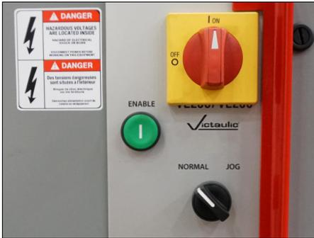
7. Placer le commutateur d'alimentation sur le côté de l'outil à la position « ON ». S'assurer que le sélecteur de mode de fonctionnement sur le côté de l'outil à la position « NORMAL ».
