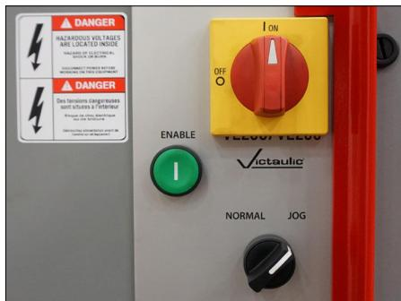
6. Placer le commutateur d'alimentation sur le côté de l'outil à la position « ON ». Placer le sélecteur de mode de fonctionnement sur le côté de l'outil à la position « JOG » (marche pas-à-pas).
