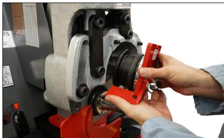
3. Glisser avec soin l'ensemble de rouleau supérieur sur l'arbre supérieur en positionnant la plaque rouge vers l'extérieur. Au besoin, desserrer les protecteurs de rouleau pour faciliter l'installation. S'assurer que la plaque rouge s'imbrique dans les deux goupilles du bras et qu'elle s'appuie sur le devant de l'arbre supérieur.
