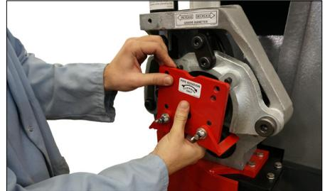
2. Retirer l'ensemble de rouleau supérieur en le tirant bien droit de l'outil. Ranger l'ensemble de rouleau supérieur dans l'armoire à outils.
