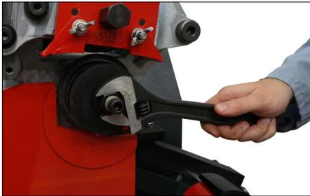
2. Utiliser une clé pour desserrer le grand écrou sur le mandrin, puis le reculer de ¼ po/6 mm. NE PAS retirer le grand écrou. NE PAS enlever le grand écrou.
