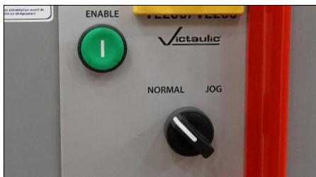
11. Se préparer à soutenir le tuyau. Placer le sélecteur de mode de fonctionnement sur le côté de l'outil à la position « NORMAL ». L'ensemble du bras et du rouleau supérieurs retourne à sa position la plus élevée et le tuyau est libéré.
