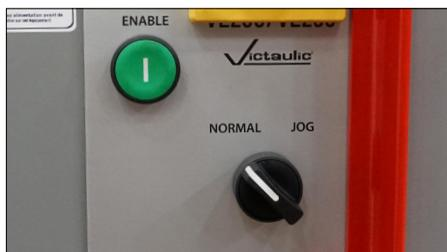
8a. Placer le sélecteur de mode de fonctionnement sur le côté de l'outil à la position « NORMAL ». La tête de l'outil devrait s'abaisser lorsque la pédale est enfoncée, puis se soulever jusqu'en position de repos lorsque la pédale est relâchée.
