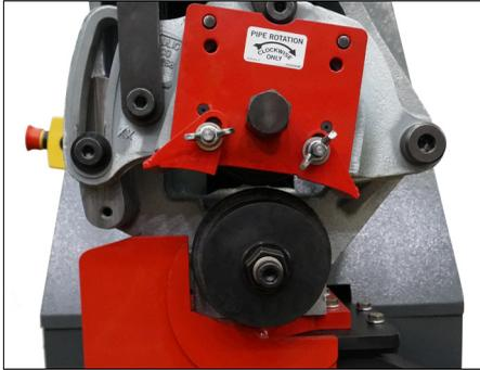
1. S'assurer que l'ensemble de rouleaux installé sur l'outil convient au diamètre de tuyau à rainurer. Les rouleaux sont marqués du diamètre et du numéro de pièce. De plus, ils comportent un code de couleur en fonction du matériau de tuyau. Se reporter aux tableaux de la page 46.
