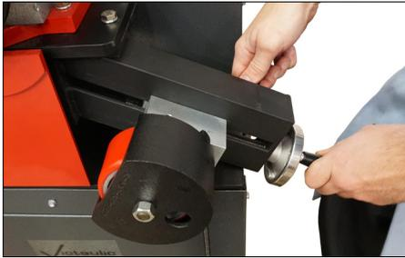
4. Au besoin, rétracter le stabilisateur de tuyau pour insérer le tuyau sur le rouleau inférieur en desserrant la poignée de blocage et en rétractant le rouleau stabilisateur à l'aide du volant.
