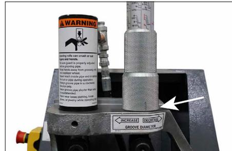
13. Maintenir la pédale de sécurité enfoncée et observer le déplacement du vérin hydraulique. Le vérin hydraulique devrait s'abaisser rapidement de  $\frac{1}{4}$  po/6 mm. Relâcher la pédale de sécurité. Le vérin hydraulique devrait reprendre sa position complètement relevée. Répéter cette procédure à plusieurs reprises.
