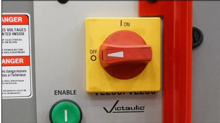
1. Placer le commutateur d'alimentation sur le côté de l'outil à la position « OFF ».
