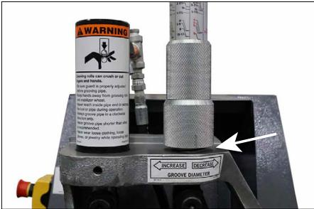
10. Régler la butée de profondeur de l'outil de manière à obtenir un espace de  $\frac{1}{4}$  po/6 mm entre la butée et l'outil.
