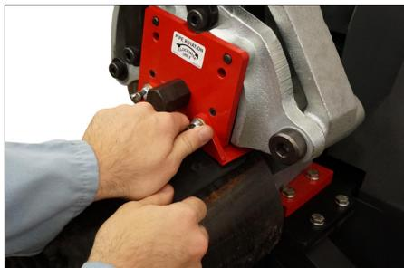
9. Desserrer les écrous à oreilles, puis régler chaque protecteur de manière à ce qu'il « pince » légèrement le gabarit contre le tuyau. Serrer les écrous à oreilles pour bloquer chaque protecteur en place. Retirer le gabarit de réglage du protecteur.
