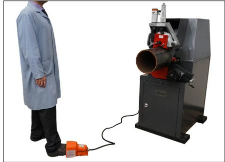
6. En soutenant manuellement le tuyau, maintenir la pédale de sécurité enfoncée. Le rouleau supérieur avance et entre en contact avec le tuyau. Retirez vos mains du tuyau. L'opérateur doit s'installer comme montré ci-dessus.
