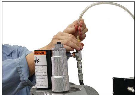
3. Installer à la main le tube de purge fourni avec l'outil sur le raccord en té.
