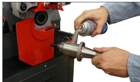
2. Enduire légèrement l'ensemble du roulement inférieur avec le vaporisateur pour assemblage mécanique (fourni avec l'outil).
