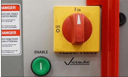
1. Placer le commutateur d'alimentation sur le côté de l'outil à la position « ON ».
