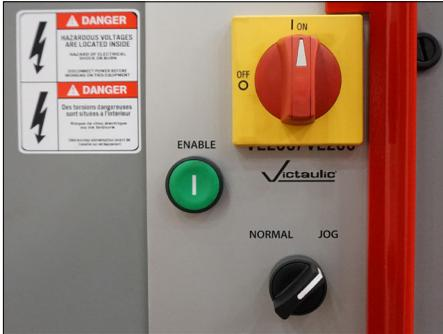
2. Placer le commutateur d'alimentation sur le côté de l'outil à la position « ON ». Placer le sélecteur de mode de fonctionnement sur le côté de l'outil à la position « JOG » (marche pas-à-pas).
