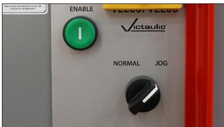
2. Placer le sélecteur de mode de fonctionnement sur le côté de l'outil à la position « JOG » (marche pas-à-pas).
