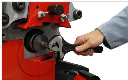
2. Placer une clé sur l'extrémité carrée du rouleau inférieur, puis desserrer l'ensemble de rouleau inférieur en tournant en **sens horaire** et le retirer. Ranger l'ensemble de rouleau inférieur dans l'armoire à outils.
