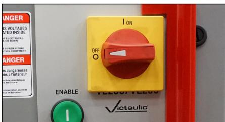
5. Si le rouleau inférieur tourne en sens antihoraire, couper le courant en plaçant le commutateur d'alimentation sur le côté de l'outil à la position OFF et suivre les étapes ci-dessous.
