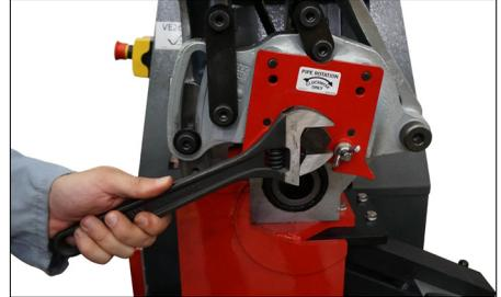
1. Utiliser une clé pour desserrer, puis retirer le boulon du rouleau supérieur. Mettre le boulon du rouleau supérieur à un endroit sûr.
