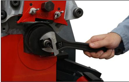
2. Poser la rondelle plate et le grand écrou sur le goujon fileté du mandrin. Serrer fermement le grand écrou à l'aide d'une clé pour fixer le rouleau inférieur. NE PAS serrer le grand écrou outre mesure.
