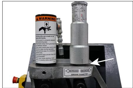
7. Continuer le processus de rainurage jusqu'à ce que la butée de profondeur entre en contact avec la partie supérieure du corps de l'outil. Continuer de faire tourner le tuyau durant 1 ou 2 tours pour assurer une rainure complète.
