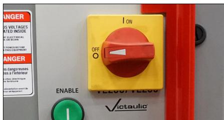
10. Si l'opération de rainurage est terminée pour le moment, mettre le commutateur d'alimentation sur le côté de l'outil à la position « OFF ».
