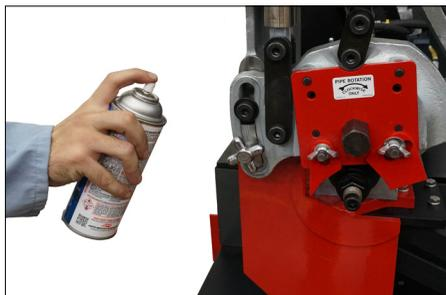
3. Lubrifier la tringlerie, la rotule du bras et les surfaces coulissantes du bras. Il est possible d'utiliser un lubrifiant de service intense vaporisé ou d'appliquer de la graisse à la main. Se reporter au chapitre « Lubrifiants recommandés » pour connaître la graisse à utiliser.
