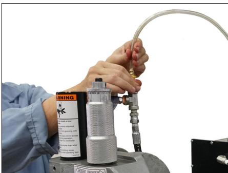
8. Retirer le tube de purge transparent du raccord en té et du réservoir hydraulique. Poser le bouchon sur le raccord en té. Prendre soin de ne pas laisser l'air s'infiltrer par le raccord en té en posant le bouchon.
