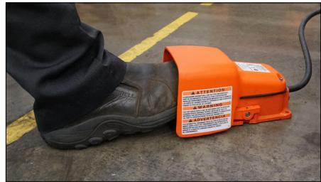
7. En étant placé du côté de la pédale de sécurité, utiliser la pédale de sécurité pour activer le moteur de l'outil et pour abaisser le rouleau supérieur afin de créer un contact ferme avec le tuyau. Retirer le pied de la pédale de sécurité.
