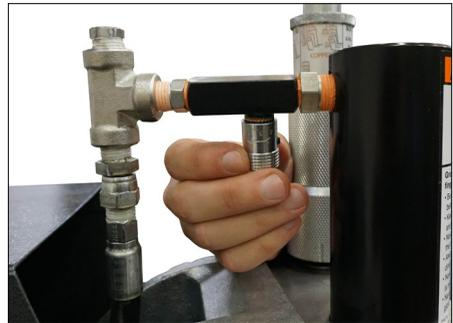
2. Ruotare la manopola della valvola di controllo velocità stelo in senso orario per 2-3 giri per ridurre il flusso.
