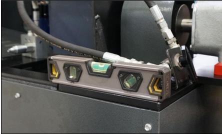
2. La macchina VE268 è progettata per l'uso in una posizione permanente e deve essere ubicata su un basamento o una pavimentazione in calcestruzzo in piano. Dopo aver scelto una posizione appropriata, la macchina deve essere livellata e fissata saldamente. Una macchina non in piano può compromettere gravemente l'operazione di scanalatura e la sicurezza. Per controllare la messa in piano della macchina, posizionare una livella a bolla direttamente sul telaio della stessa, come mostrato in alto.
