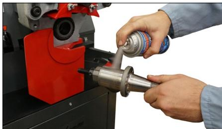
2. Applicare un leggero strato di spray per montaggio meccanico (in dotazione con la macchina) al gruppo rullo inferiore.
