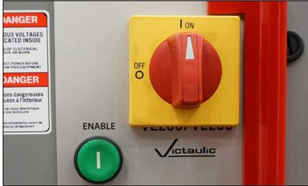
1. Portare l'interruttore di alimentazione a lato della macchina sulla posizione "ON".
