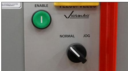
11. Prepararsi a sostenere il tubo. Portare il selettore a lato della macchina sulla posizione "NORMAL". Il gruppo braccio/ruolo superiore tornerà alla posizione in alto e il tubo verrà rilasciato.
