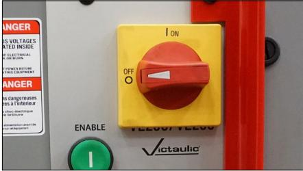
1. Portare l'interruttore di alimentazione a lato della macchina sulla posizione "OFF".
