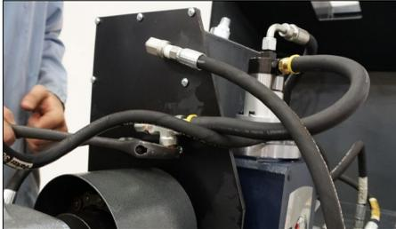
2. Rimuovere il tappo di drenaggio nella linea idraulica accanto al serbatoio. Lasciare drenare l'olio in un contenitore con una capacità di almeno 6 litri/1 1/2 gallone.
