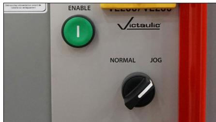
8b. Portare il selettore a lato della macchina sulla posizione "JOG". La testa della macchina dovrà scendere mentre viene premuto l'interruttore a pedale e restare in quella posizione quando si rilascia tale interruttore.
