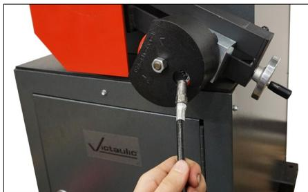
4. Lubrificare il volantino dello stabilizzatore tramite l'ingrassatore, come mostrato nella figura in alto. Per informazioni sul grasso da utilizzare, consultare la Tabella "Lubrificanti raccomandati" applicabile.
