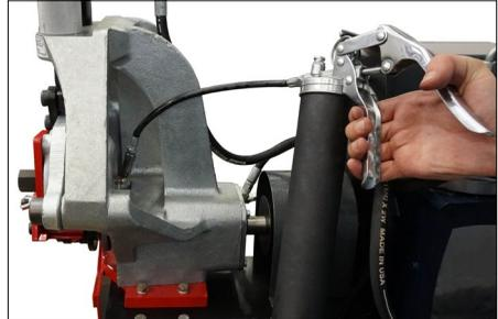
5. Lubrificare il cuscinetto del rullo superiore. Per il lubrificante raccomandato, consultare la sezione "Manutenzione".
