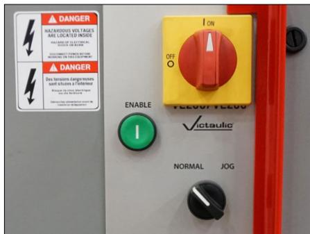
3. Portare l'interruttore di alimentazione a lato della macchina sulla posizione "ON". Portare il selettore a lato della macchina sulla posizione "NORMAL".
