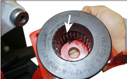
2. Ispezionare il cuscinetto del rullo all'interno del rullo superiore per verificare che sia lubrificato e possa muoversi correttamente. Ispezionare le protezioni del rullo per verificare l'eventuale presenza di usura e la libertà di movimento. Se necessario, riparare o sostituire eventuali componenti danneggiati.
