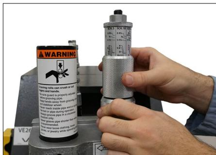
3. Impostare il fermo del diametro della scanalatura alla dimensione del tubo e alla schedula/spessore da scanalare. Per eseguire questa operazione, svitare il blocco del regolatore di profondità, quindi allineare quest'ultimo al corretto diametro e spessore. Bloccare il regolatore di profondità in posizione utilizzando il relativo fermo.
