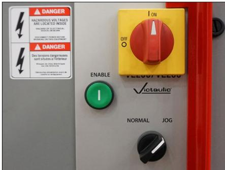
2. Portare l'interruttore di alimentazione a lato della macchina sulla posizione "ON". Portare il selettore a lato della macchina sulla posizione "JOG".
