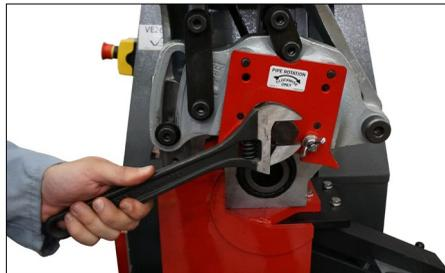
1. Utilizzando una chiave, allentare e rimuovere il bullone del rullo superiore. Posizionare il bullone del rullo superiore in un punto sicuro.
