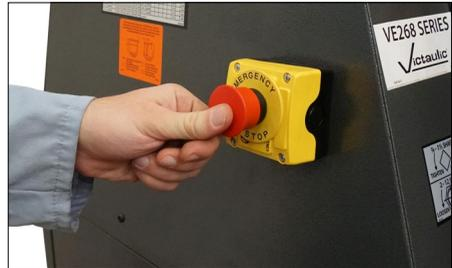
4. Premere il pulsante di arresto di emergenza e verificare che questa azione abbia sezionato l'alimentazione al motore. La pressione dell'interruttore a pedale, del pulsante Enable o del selettore non dovranno avere alcun effetto sullo stato della macchina. Tutti i componenti devono rimanere allo stato "Off".
