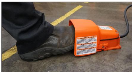
11. Per avviare la scanalatura, tenere premuto l'interruttore di sicurezza a pedale. In questo modo il rullo superiore avvanzerà fino a toccare il tubo. Il rullo inferiore inizierà a ruotare e inizierà a formarsi la scanalatura.
