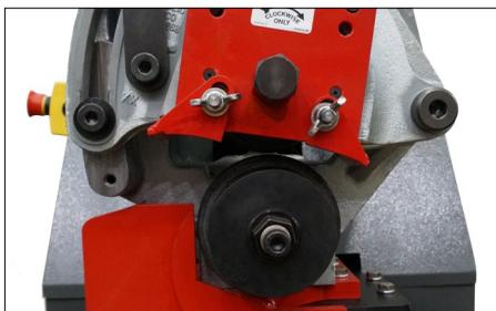
4. La corretta rotazione del rullo inferiore è **in senso orario** se visto dal lato frontale della macchina. Se la rotazione avviene in senso orario, il collegamento di alimentazione è stato completato.
