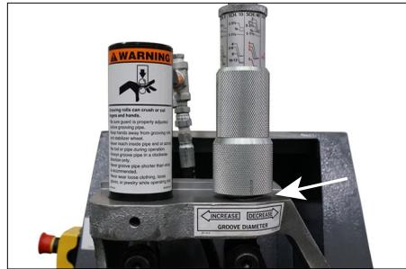
7. Continuare l'operazione di scanalatura fino a quando il fermo di regolazione della profondità non tocca la parte superiore del corpo della macchina. Continuare la rotazione del tubo per 1 – 2 giri per garantire il completamento della scanalatura.
