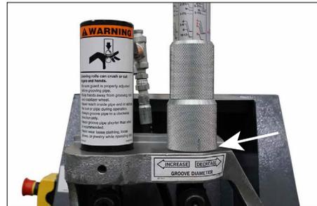
13. Tenere premuto l'interruttore di sicurezza a pedale e osservare il movimento dello stelo idraulico. Lo stelo idraulico deve spostarsi verso il basso rapidamente di 6 mm/¼". Rilasciare l'interruttore di sicurezza a pedale. Lo stelo idraulico deve ritornare nella posizione completamente sollevata. Ripetere la procedura più volte.
