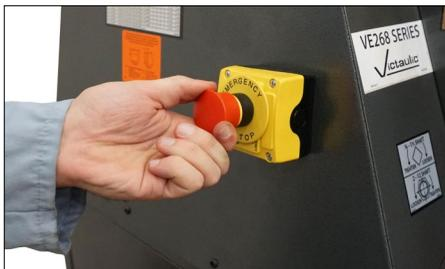
5. Tirare il pulsante di arresto di emergenza e verificare che il motore non venga alimentato. La pressione dell'interruttore a pedale, del pulsante "Enable" o del selettore non dovranno avere alcun effetto sullo stato della macchina. Tutti i componenti devono rimanere allo stato "Off".
