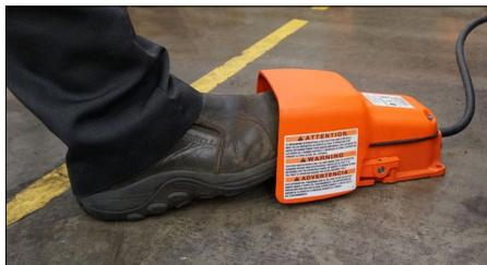
5. Con l'operatore sul lato interruttore di sicurezza a pedale, utilizzare tale interruttore per azionare il motore e abbassare il rullo superiore fino a portarlo saldamente a contatto col tubo. Togliere il piede dall'interruttore di sicurezza.
