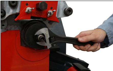
2. Inserire la rondella piatta e il dado grande sul perno filettato del codolo. Fissare saldamente il dado grande con una chiave per fissare il rullo inferiore. **NON** serrare eccessivamente il dado grande.
