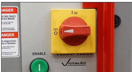
5. Se la rotazione del rullo inferiore avviene in senso antiorario, portare l'interruttore di alimentazione sul lato della macchina sulla posizione "OFF" e procedere nel modo seguente.
