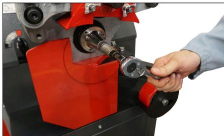
2. Con una chiave applicata alla porzione con la vite a brugola del travetto, allentare il travetto ruotando in **senso antiorario**. Il codolo deve muoversi verso l'esterno man mano che si allenta il travetto.
