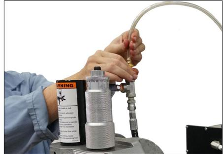
3. Montare il tubo di sfiato trasparente, in dotazione con la macchina, serrarlo a mano nel raccordo a T.
