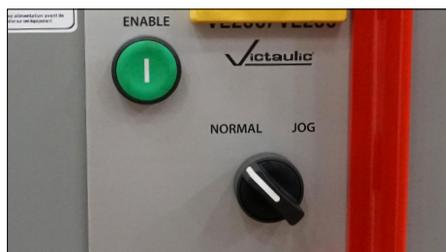
7. Prepararsi a sostenere il tubo. Portare il selettore a lato della macchina sulla posizione "NORMAL". Il gruppo braccio/rullo superiore tornerà alla posizione in alto e il tubo verrà rilasciato.
