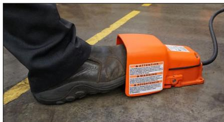
3. Premere l'interruttore di sicurezza a pedale, osservare il senso di rotazione del rullo inferiore, quindi rilasciare l'interruttore di sicurezza a pedale.
