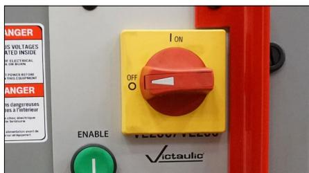
5b. Portare l'interruttore di alimentazione a lato della macchina sulla posizione "OFF".
