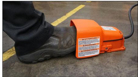
7. Con l'operatore sul lato interruttore di sicurezza a pedale, utilizzare tale interruttore per azionare il motore della macchina e abbassare il rullo superiore fino a portarlo saldamente a contatto col tubo. Togliere il piede dall'interruttore di sicurezza.
