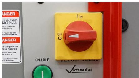
1. Portare l'interruttore di alimentazione a lato della macchina sulla posizione "OFF".
