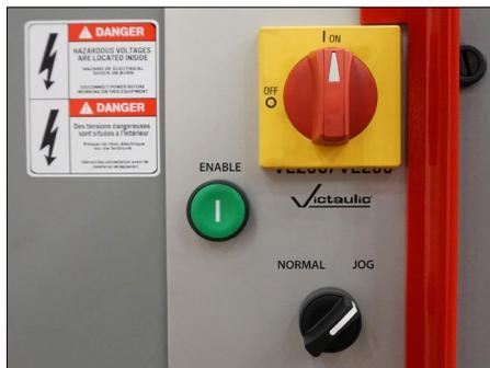
4. Portare l'interruttore di alimentazione a lato della macchina sulla posizione "ON". Portare il selettore a lato della macchina sulla posizione "JOG".
