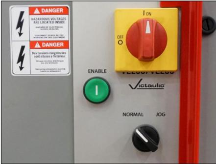
7. Portare l'interruttore di alimentazione a lato della macchina sulla posizione "ON". Assicurarsi che il selettore a lato della macchina sia sulla posizione "NORMAL".
