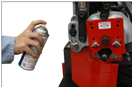
3. Lubrificare i cinematismi, il punto di articolazione e le superfici di scorrimento del braccio. Può essere utilizzato un lubrificante spray heavy-duty oppure può essere applicato manualmente del grasso. Per informazioni sul grasso da utilizzare, consultare la Tabella "Lubrificanti raccomandati" applicabile.
