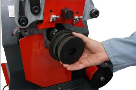
1. Installare il rullo inferiore sul codolo. Se necessario, riposizionare le protezioni del rullo per agevolare l'installazione. Allineare il quadro di manovra del rullo inferiore con quello del codolo.
