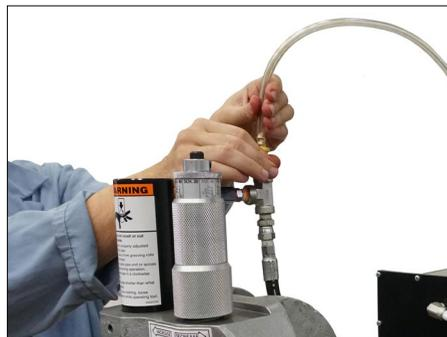
8. Rimuovere il tubo di sfiato trasparente dal raccordo a T e dal serbatoio idraulico. Montare il tappo sul raccordo a T. Assicurarsi che l'aria non possa rientrare nel raccordo a T mentre si applica il tappo.
