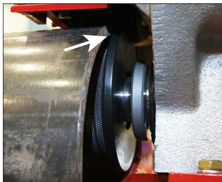
1. Inserire un tratto di tubo da da 26,9 a 101,6 mm/3/4 a 3 1/2", di diametro corretto, sul rullo inferiore. Assicurarsi che l'estremità del tubo sia completamente a contatto con il meccanismo antiretro del rullo inferiore.
