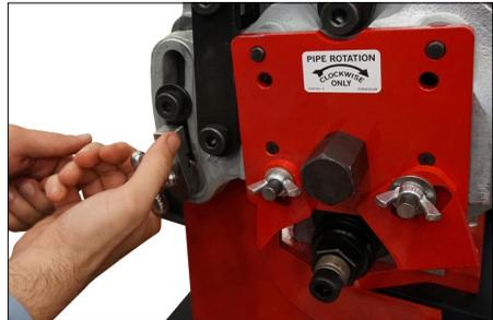
4. Svitare la manopola di arresto della corsa dal corpo della macchina ruotando in senso antiorario. Conservare la manopola di arresto della corsa nel portaoggetti della macchina.
