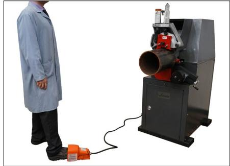
6. Mentre si sostiene manualmente il tubo, tenere premuto l'interruttore di sicurezza a pedale. Il rullo superiore avvanzerà fino a toccare il tubo. Togliere le mani dal tubo. L'operatore deve trovarsi nella posizione mostrata nella figura.
