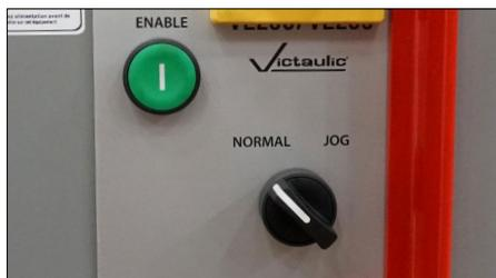
5a. Portare il selettore a lato della macchina sulla posizione "NORMAL". Il gruppo braccio/ruolo superiore tornerà alla posizione più in alto.
