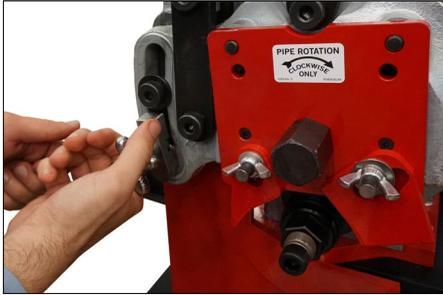
5. Avvitare la manopola di arresto della corsa nel foro maschiato da  $\frac{3}{8}$  - 16 UNC ubicato sulla superficie dello scivolo.
