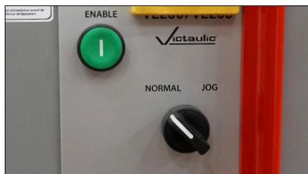
8a. Portare il selettore a lato della macchina sulla posizione "NORMAL". La testa della macchina dovrà scendere mentre viene premuto l'interruttore a pedale e salire fino alla posizione di riposo quando si rilascia tale interruttore.
