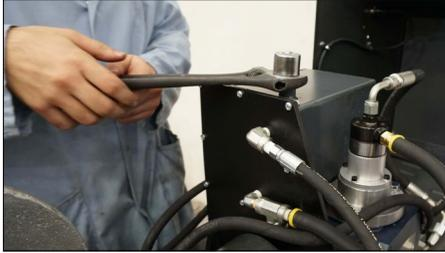
1. Rimuovere il tappo di sfiato idraulico nella parte superiore del serbatoio idraulico.
