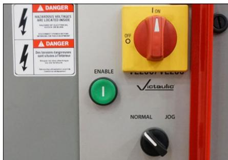
3. Portare l'interruttore di alimentazione a lato della macchina sulla posizione "ON". Assicurarsi che il selettore a lato della macchina sia sulla posizione "NORMAL". Il gruppo braccio/rullo superiore tornerà alla posizione più in alto.
