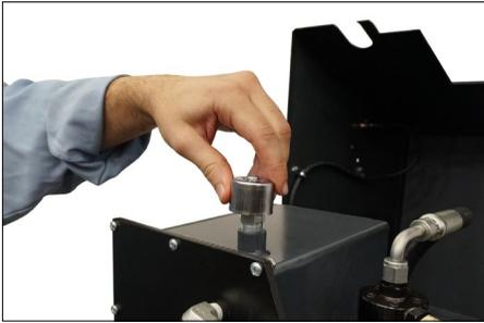
9. Il livello consigliato dell'olio idraulico non deve essere superiore a 13 mm/½" dal bordo superiore del serbatoio. Per informazioni sull'olio idraulico corretto, consultare la Tabella "Lubrificanti raccomandati". Rimontare il tappo di sfiato idraulico nella parte superiore del serbatoio idraulico.
