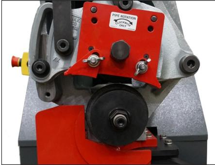
1. Assicurarsi che sulla macchina sia montata la serie di rulli corretta per le dimensioni della tubazione e per il materiale da scanalare. I rulli sono contrassegnati con le indicazioni delle dimensioni del tubo e il codice, oltre a essere codificati per colore in base al materiale del tubo. Fare riferimento alle tabelle a pagina 46.
