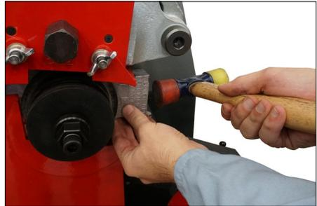
3. Per allentare il rullo inferiore dal codolo conico, utilizzare il cuneo in alluminio in dotazione con la macchina. Posizionare il cuneo dietro il rullo inferiore e colpirlo con un martello con lato battente morbido per staccare il rullo inferiore dal cono. Non colpire direttamente il rullo inferiore con il martello.
