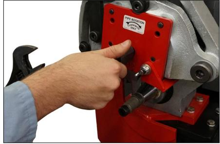
4. Inserire il bullone del rullo superiore e serrarlo saldamente con una chiave.
