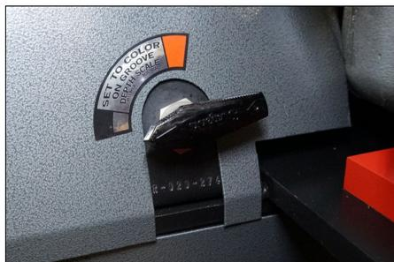
4. Impostare la valvola selettore sul lato anteriore della macchina sul colore corrispondente alla dimensione e alla scheda del tubo (ROSSO o NERO) sull'etichetta dell'indicatore delle dimensioni del tubo.
