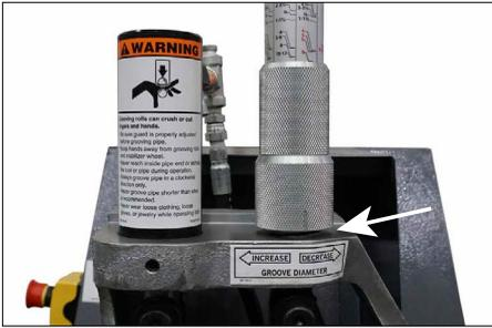
10. Impostare il blocco del regolatore di profondità della macchina in modo da ottenere uno spazio di 6 mm/¼" tra quest'ultimo e il corpo della macchina.
