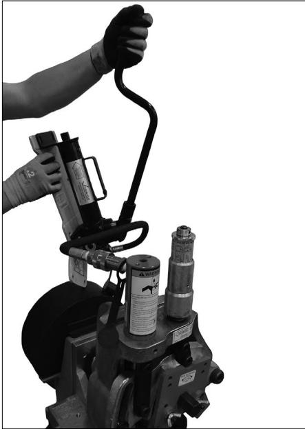
3. Pour purger l'air du système, maintenir l'ensemble de la pompe à main hydraulique pour que l'extrémité du bouchon de remplissage de liquide hydraulique soit AU-DESSUS du vérin hydraulique. Cela évitera de siphonner du liquide du vérin hydraulique par la pompe à main hydraulique.
