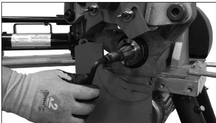
2. À l'aide d'une clé hexagonale insérée dans la partie hexagonale du goujon, desserrer le goujon en tournant **dans le sens inverse des aiguilles d'une montre**. Le mandrin devrait se déplacer vers l'extérieur une fois le goujon desserré.
