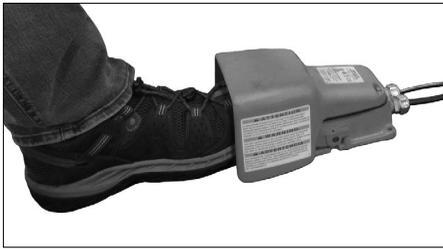
3. Actionner brièvement la commande au pied de sécurité pour s'assurer que l'outil est fonctionnel. La molette inférieure doit tourner dans le sens des aiguilles d'une montre (vu depuis l'avant de la rainureuse). Retirer le pied de la commande au pied de sécurité.
