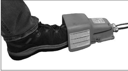
**8.** Appuyer sur la commande au pied de sécurité et la maintenir enfoncée. Le tube commence à tourner dans le sens des aiguilles d'une montre (vu depuis l'avant de la rainureuse). Pendant que le tube tourne, commencer le rainurage en actionnant lentement le levier de la pompe à main hydraulique.
