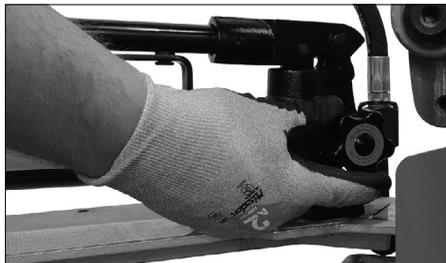
**1.** Ouvrir la vanne de la pompe à main hydraulique en la tournant dans le sens inverse des aiguilles d'une montre.
