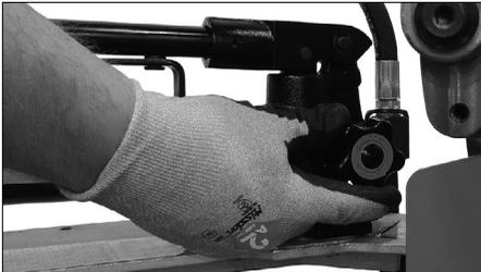
**4.** Fermer la vanne de la pompe à main hydraulique en la tournant dans le sens des aiguilles d'une montre.
