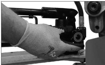
11. Ouvrir la vanne sur la pompe à main hydraulique en la tournant dans le sens inverse des aiguilles d'une montre pour pouvoir amener la molette supérieure et le bras en position complètement relevée.
