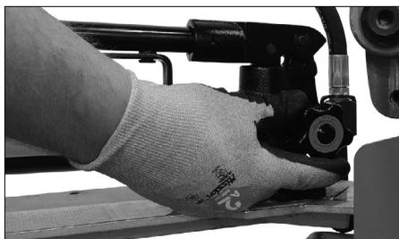
**10.** Fermer la vanne de la pompe à main hydraulique en la tournant dans le sens des aiguilles d'une montre.
