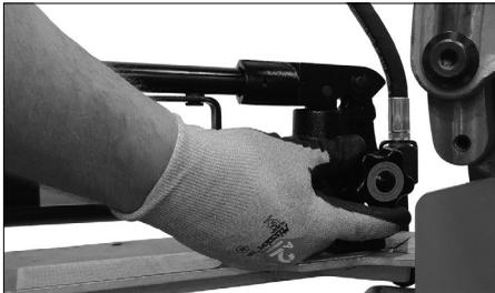
8. Ouvrir la vanne sur la pompe à main hydraulique en la tournant dans le sens inverse des aiguilles d'une montre pour pouvoir remonter complètement la molette supérieure et le bras.
