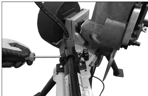
4. Visser la poignée de la pompe à main dans le bras de levier de la pompe à main hydraulique en tournant dans le sens des aiguilles d'une montre. Placer la poignée de la pompe à main de sorte que la poignée soit tournée vers le bas. Verrouiller la poignée dans cette position à l'aide de la vis de réglage, tel qu'illustré ci-dessus.
