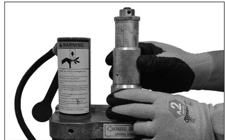
**2. Situer le diamètre et l'épaisseur appropriés sur l'indicateur de diamètre de tube. Il est possible de faire tourner le barillet indicateur de diamètre de tube pour faciliter la lecture.**
