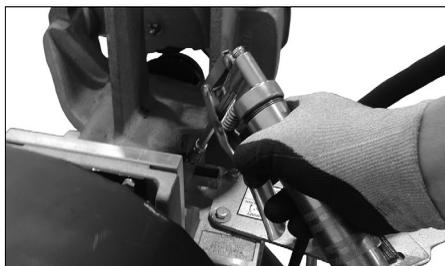
2. Graisser les roulements de l'arbre principal via le raccord de graissage situé sur le côté de l'outil, comme illustré. Se reporter au tableau « Lubrifiants recommandés » pour savoir quel lubrifiant utiliser.
