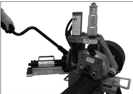
**5.** Actionner le levier de la pompe à main hydraulique pour abaisser la molette supérieure jusqu'à ce qu'elle touche le tube.
