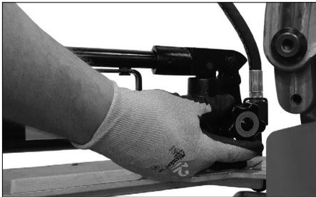
**10.** Se préparer à soutenir le tube. Ouvrir la vanne de la pompe à main hydraulique en la tournant dans le sens inverse des aiguilles d'une montre pour libérer le tube. Retirer le tube de l'outil.
