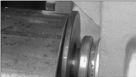
**3.** Insérer une longueur de tube de diamètre et de calibre appropriés sur la molette inférieure. Vérifier que l'extrémité du tube entre en contact avec la bride-butée arrière de la molette inférieure. Le tube doit s'appuyer contre le dessus de la molette et être perpendiculaire à cette dernière.
