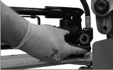
**6.** Fermer la vanne de la pompe à main hydraulique en la tournant dans le sens des aiguilles d'une montre.
