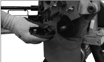
**2.** Poser le grand écrou sur le goujon fileté du mandrin. Serrer fermement le grand écrou avec une clé pour fixer la molette inférieure en position. **NE PAS** serrer le grand écrou de façon excessive.
