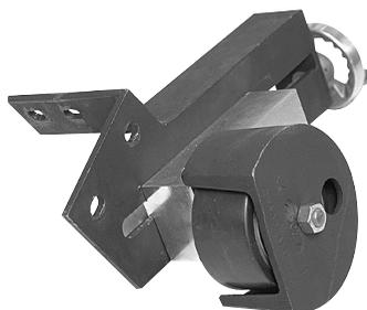
Le stabilisateur de tube de la rainureuse VE270FSD est conçu pour prévenir toute oscillation des tubes courts et longs de diamètre 8 – 12 po/DN200 – DN300. Le stabilisateur de tube est requis pour le rainurage de tubes en acier inoxydable à paroi mince et de tubes en cuivre de 8 po/DN200. Contacter Victaulic pour plus d'informations.
