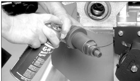
**2.** Enduire la molette inférieure d'une fine couche de produit à vaporiser pour ensembles mécaniques (fourni avec l'outil et vendu par Victaulic).
