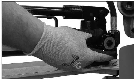
**2.** Fermer la vanne de la pompe à main hydraulique en la tournant dans le sens des aiguilles d'une montre.
