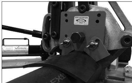
9. Desserrer les écrous à ailettes et régler chaque protecteur de manière à ce qu'il s'adapte et « pince » légèrement le patin contre le tube. Serrer les écrous à ailettes pour bloquer chaque protecteur en position. Retirer le patin de réglage de protecteur.
