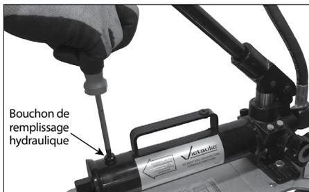
**2a.** Retirer le bouchon de remplissage du liquide hydraulique à l'extrémité de la pompe à main hydraulique.
