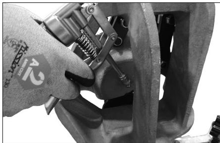
1. À chaque changement des molettes et toutes les huit heures de fonctionnement, lubrifier les roulements de la molette supérieure. L'outil est doté d'un raccord de graissage, comme illustré. Se reporter au tableau « Lubrifiants recommandés » pour savoir quel lubrifiant utiliser.
