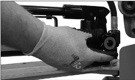
1. Ouvrir la vanne sur la pompe à main hydraulique en la tournant dans le sens inverse des aiguilles d'une montre pour pouvoir amener la molette supérieure et le bras en position complètement relevée.
