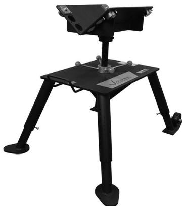
Le support de tube portable et réglable Victaulic VAPS112, du type à rouleau, comporte quatre pieds pour une stabilité renforcée. Les rouleaux de transfert à billes réglables pour tubes de 2 – 12 po/DN50 – DN300 et le support en « V » pour tubes de ¾ – 1 ½ po/DN20 – DN40 permettent un mouvement linéaire et rotatif. La conception à tourniquet facilite le rainurage des deux extrémités de tube. Contacter Victaulic pour plus d'informations.
