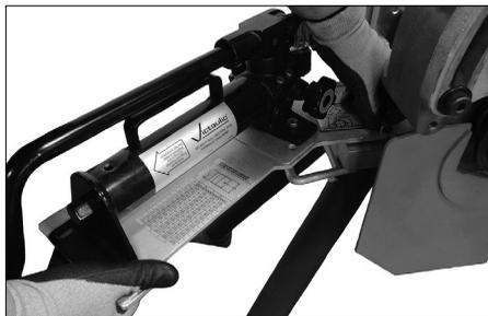
**1.** Retirer l'ensemble pompe à main hydraulique/ support de pompe de la base de l'outil.
