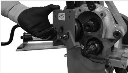
2. Retirer la molette supérieure en la tirant bien droite hors de l'outil. Stocker la molette supérieure dans le sac de stockage de molettes fourni avec l'outil.
