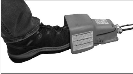
7. Actionner brièvement la commande au pied de sécurité pour s'assurer que l'outil est fonctionnel. La molette inférieure doit tourner dans le sens des aiguilles d'une montre (vu depuis l'avant de la rainureuse). Retirer le pied de la commande au pied de sécurité.
