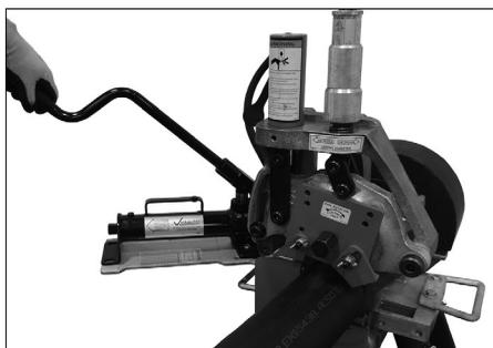
**7a.** L'opérateur doit se placer du côté de l'outil où se trouve la pompe à main hydraulique/ commande au pied de sécurité. Tout en tenant le tube, actionner le levier de la pompe à main hydraulique pour abaisser la molette supérieure jusqu'à ce qu'elle touche fermement le tube.
