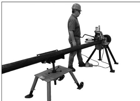
**11a.** L'opérateur doit se placer du côté de l'outil où se trouve la pompe à main hydraulique/ commande au pied de sécurité, comme indiqué ci-dessus. Actionner le levier de la pompe à main hydraulique pour abaisser la molette supérieure jusqu'à ce qu'elle touche le tube.
