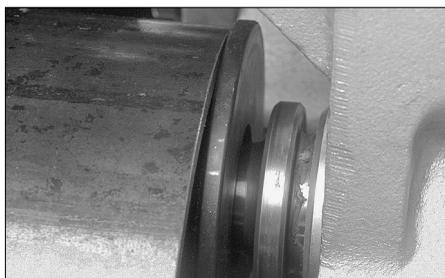
**5.** Insérer une longueur de tube de diamètre et d'épaisseur corrects sur la molette inférieure. Vérifier que l'extrémité du tube touche complètement la bride-butée de la molette inférieure.
