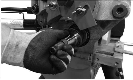
**3a.** Insérer avec soin le mandrin dans l'arbre principal, en veillant à ce qu'il soit complètement inséré. Il peut être nécessaire de faire tourner le mandrin pour aligner son ouverture arrière carrée sur l'arbre principal.
