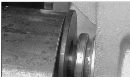
**9.** Insérer une longueur de tube de diamètre et d'épaisseur corrects sur la molette inférieure. Vérifier que l'extrémité du tube touche complètement la bride-butée de la molette inférieure. Retirer les mains du tube.
