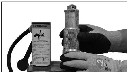
**3.** Régler la butée de diamètre de rainure sur le diamètre et le calibre/l'épaisseur du tube à rainurer. Pour ce faire, reculer le verrou du dispositif de réglage de la profondeur et aligner le dispositif de réglage de la profondeur sur le marquage du diamètre et de l'épaisseur de tube souhaités. Verrouiller le dispositif de réglage de la profondeur en position au moyen du verrou du dispositif de réglage de la profondeur.
