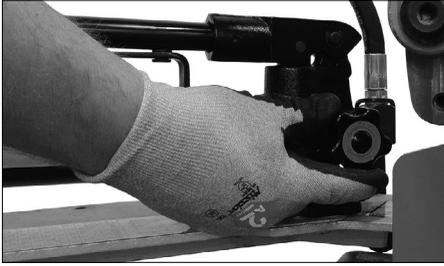
13. Ouvrir la vanne de la pompe à main hydraulique en la tournant dans le sens inverse des aiguilles d'une montre pour libérer le tube. Retirer le tube de l'outil.
