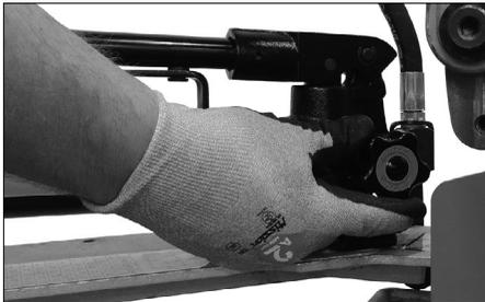
4. Ouvrir la vanne sur la pompe à main hydraulique en la tournant dans le sens inverse des aiguilles d'une montre pour pouvoir remonter complètement la molette supérieure et le bras.
