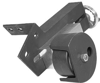
Die Rohrstütze für das Werkzeug VE270FSD ist so konzipiert, dass sie Hin- und Herbewegungen von kurzen und langen Rohrabschnitten der Größen 8 – 12 Zoll/DN200 – DN300 verhindert. Die Rohrstütze ist beim Nuten von dünnwandigen Edelstahlrohren und Kupferrohren mit 8 Zoll/DN200 Durchmesser erforderlich. Wenden Sie sich für weitere Informationen bitte an Victaulic.
