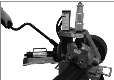
**5.** Bringen Sie die obere Rolle mit Pumpbewegungen des Hebels der Hydraulik-Handpumpe nach unten in festen Kontakt mit dem Rohr.
