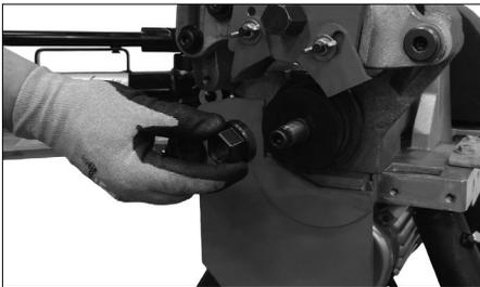
**2.** Bringen Sie die große Mutter auf dem Gewindebolzen der Spindel an. Ziehen Sie die große Mutter mit einem Schraubenschlüssel sicher fest, um die untere Rolle in ihrer Position zu halten. Ziehen Sie die große Mutter NICHT zu fest an.
