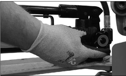
**2.** Öffnen Sie das Ventil an der Hydraulik-Handpumpe, indem Sie es gegen den Uhrzeigersinn drehen.
