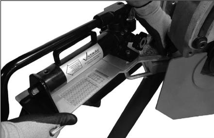
**1.** Nehmen Sie die Hydraulik-Handpumpe/ Pumpenhalterung von der Werkzeughalterung ab.
