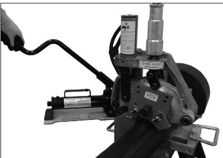
**7a.** Der Bediener sollte sich auf der Seite des Werkzeugs befinden, auf der sich auch der Sicherheitsfußschalter/ die Hydraulik-Handpumpe befindet. Bringen Sie die obere Rolle mit Pumpbewegungen des Hebels der Hydraulik-Handpumpe nach unten in festen Kontakt mit dem Rohr, während Sie das Rohr von Hand abstützen.
