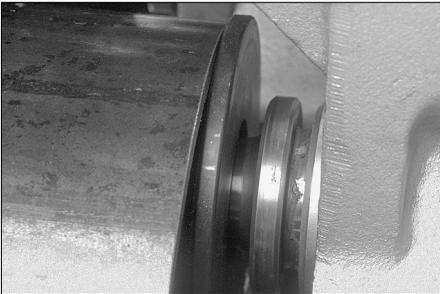
4. Führen Sie ein Rohrstück über die untere Rolle ein, so dass das Rohrende am hinteren Anschlagflansch der unteren Rolle anliegt.
