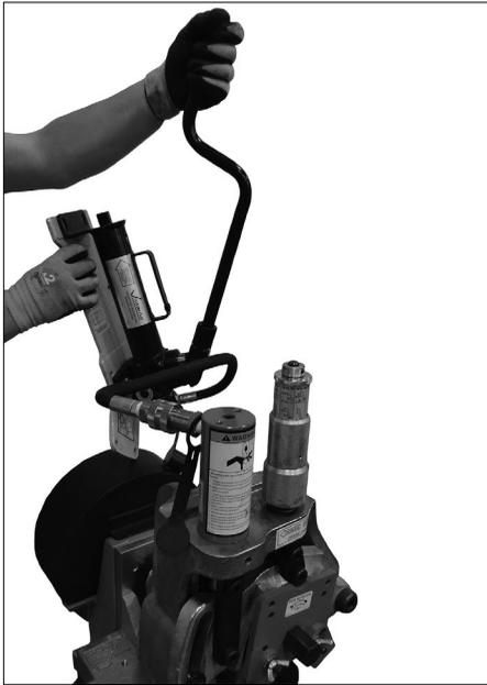
3. Halten Sie zur Entlüftung des Systems die ganze Hydraulik-Handpumpe so, dass das Ende mit dem Hydraulik-Einfüllstopfen ÜBER dem Hydraulikzylinder liegt. Dadurch wird Absaugung von Flüssigkeit aus dem Hydraulikzylinder durch die Hydraulik-Handpumpe verhindert.
