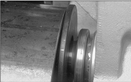
**5.** Führen Sie ein Rohr der richtigen Größe und Stärke über die untere Rolle ein. Vergewissern Sie sich, dass das Rohrende vollständig gegen den hinteren Anschlagflansch der unteren Rolle stößt.
