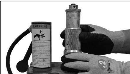
3. Stellen Sie den Nutdurchmesseranschlag auf die zu nutende Rohrgröße und -dicke ein, indem Sie die Tiefeneinstellungssperre lösen und die Tiefeneinstellung auf die entsprechende Markierung für Rohrdurchmesser und -dicke ausrichten. Verriegeln Sie die Tiefeneinstellung mit der Tiefeneinstellungssperre.
