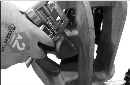
1. Schmieren Sie die Lager der oberen Rolle bei jedem Rollenwechsel und nach jeweils acht Betriebsstunden. Dazu steht wie dargestellt ein Schmiernippel zur Verfügung. Beziehen Sie sich hinsichtlich des richtigen Schmierfetts auf die maßgebliche Tabelle „Empfohlene Schmiermittel“.
