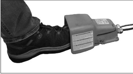
**8.** Treten Sie den Sicherheitsfußschalter herunter. Das Rohr beginnt, sich von der Vorderseite des Werkzeugs aus gesehen im Uhrzeigersinn zu drehen. Während sich das Rohr dreht, beginnen Sie den Nutvorgang, indem Sie langsam Pumpbewegungen mit dem Hebel der Hydraulik-Handpumpe ausführen.
