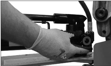
8. Öffnen Sie das Ventil an der Hydraulik-Handpumpe gegen den Uhrzeigersinn, damit sich die obere Rolle und der Arm auf die oberste Position bewegen können.
