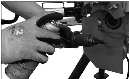
**2.** Tragen Sie eine dünne Schicht Montagespray (im Lieferumfang des Werkzeugs enthalten und von Victaulic erhältlich) auf die Spindelbaugruppe auf.
