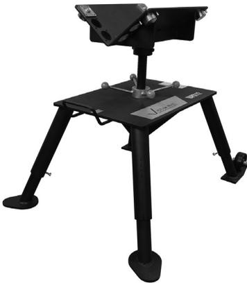
Der Victaulic VAPS112 ist ein tragbarer, verstellbarer Rohrständer mit Rollen, der für zusätzliche Stabilität mit vier Beinen ausgestattet ist. Kugelgelagerte Verfahrenrollen, einstellbar für Rohre der Größen 2 – 12 Zoll/DN50 – DN300, und die „V“-Stütze für Rohre der Größen  $\frac{3}{4}$  – 1  $\frac{1}{2}$  Zoll/DN20 – DN40 ermöglichen lineare und Drehbewegungen. Die Drehkreuzkonstruktion ermöglicht einfaches Nuten beider Rohrenden. Wenden Sie sich für weitere Informationen bitte an Victaulic.
