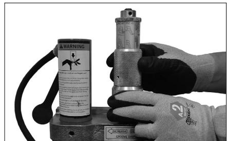
2. Suchen Sie den richtigen Durchmesser und die Stärke auf der Rohrgrößenanzeige. Der Zylinder der Rohrgrößenanzeige kann gedreht werden, um das Ablesen zu erleichtern.
