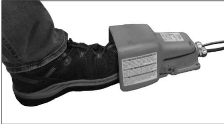
7. Treten Sie den Sicherheitsfußschalter vorübergehend herunter, um sich zu vergewissern, dass das Werkzeug funktionsbereit ist. Die untere Rolle muss sich von der Vorderseite des Werkzeugs aus gesehen im Uhrzeigersinn drehen. Nehmen Sie den Fuß vom Schalter.
