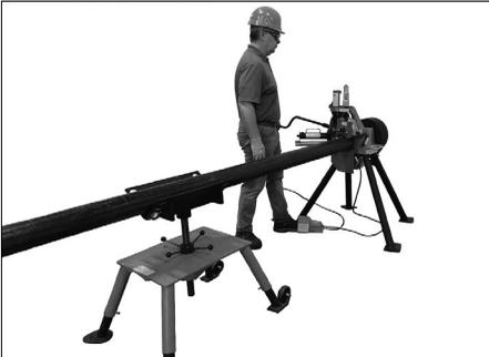
**11a.** Der Bediener sollte sich wie oben gezeigt an der Seite des Werkzeugs befinden, auf der sich auch der Sicherheitsfußschalter/die Hydraulik-Handpumpe befindet. Bringen Sie die obere Rolle mit Pumpbewegungen des Hebels der Hydraulik-Handpumpe nach unten in festen Kontakt mit dem Rohr.
