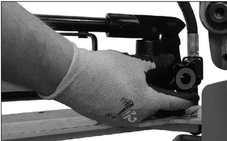
4. Öffnen Sie das Ventil an der Hydraulik-Handpumpe gegen den Uhrzeigersinn, damit sich die obere Rolle und der Arm auf die oberste Position bewegen können.
