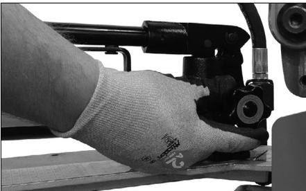
**6.** Schließen Sie das Ventil an der Hydraulik-Handpumpe, indem Sie es im Uhrzeigersinn drehen.
