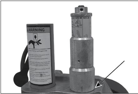
**9a.** Setzen Sie den Nutvorgang fort, bis die Tiefeneinstellsperre die Oberseite des Werkzeuggehäuses berührt. Setzen Sie die Rohrdrehung um zwei bis drei Umdrehungen fort, um sicherzustellen, dass die Nut fertiggestellt wird.
