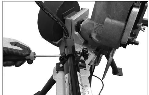
4. Führen Sie den Hebel der Handpumpe durch Drehen im Uhrzeigersinn in den Hebelarm der Hydraulik-Handpumpe ein. Positionieren Sie den Handpumpen-Hebel so, dass der Griff nach unten zeigt. Verriegeln Sie den Hebel wie oben gezeigt mit der Stellschraube in dieser Position.
