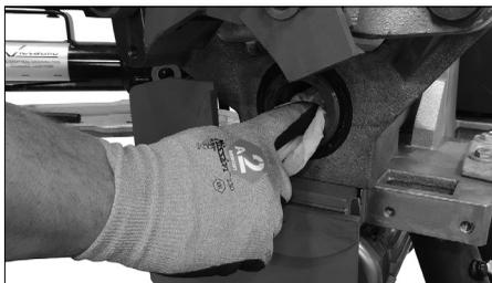
**1.** Reinigen Sie die Bohrung der Hauptwelle und die Spindel mit einem weichen Lappen.
