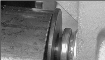
**3.** Führen Sie ein Stück Rohr der richtigen Größe ein und schieben Sie es über die untere Rolle. Vergewissern Sie sich, dass das Rohrende gegen den hinteren Anschlagflansch der unteren Rolle stößt. Das Rohr muss direkt auf der Rolle liegen und darf nicht schräg zu der einen oder anderen Seite zeigen.
