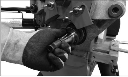
**3a.** Fügen Sie die Spindel vorsichtig in die Hauptwelle ein und vergewissern Sie sich, dass sie vollständig sitzt. Es kann nötig sein, die Spindel zu drehen, um ihr hinteres Vierkantende auf die Hauptwelle auszurichten.
