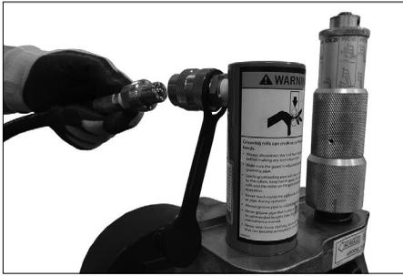
5. Schließen Sie die Hydraulikleitung von der hydraulischen Handpumpe mit den dafür vorgesehenen Steckverbindern am Hydraulikzylinder an.
