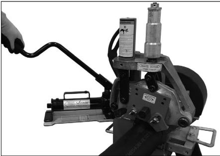
**7.** Bringen Sie die obere Rolle mit Pumpbewegungen des Hebels der Hydraulik-Handpumpe nach unten in festen Kontakt mit dem Rohr.
