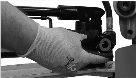
**4.** Schließen Sie das Ventil an der Hydraulik-Handpumpe, indem Sie es im Uhrzeigersinn drehen.
