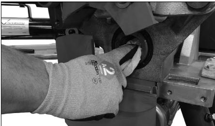
**1.** Reinigen Sie die Bohrung der Hauptwelle und die untere Rollenbaugruppe mit einem weichen Lappen.
