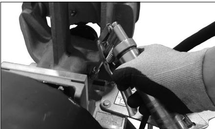
2. Schmieren Sie die Lager der Hauptwelle wie abgebildet durch den Schmiernippel an der Seite des Werkzeugs. Beziehen Sie sich hinsichtlich des richtigen Schmierfetts auf die maßgebliche Tabelle „Empfohlene Schmiermittel“.
