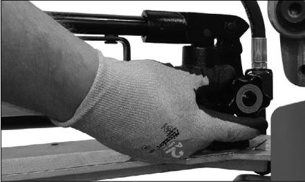
**10.** Schließen Sie das Ventil an der Hydraulik-Handpumpe, indem Sie es im Uhrzeigersinn drehen.
