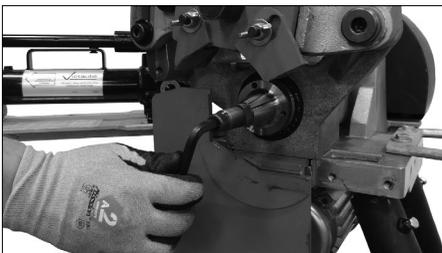
2. Setzen Sie einen Inbusschlüssel in der Sechskantöffnung des Bolzens an und lösen Sie den Bolzen durch Drehen **gegen den Uhrzeigersinn**. Die Spindel sollte herauskommen, wenn der Bolzen gelöst wird.
