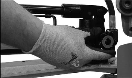
**1.** Öffnen Sie das Ventil an der Hydraulik-Handpumpe, indem Sie es gegen den Uhrzeigersinn drehen.
