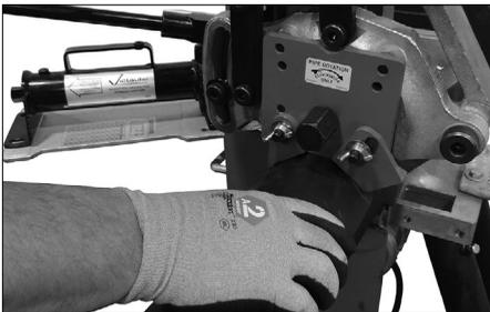
**8.** Nehmen Sie den Einstellblock für die Schutzvorrichtungen von seinem Aufbewahrungshaken unter der Halterung der Hydraulik-Handpumpe. Drücken Sie den Einstellblock für die Schutzvorrichtungen fest nach unten gegen das Rohr und schieben Sie ihn unter die verstellbaren Schutzvorrichtungen, bis er die obere Rolle berührt.
