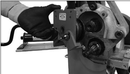
2. Entfernen Sie die obere Rollenbaugruppe, indem sie gerade aus dem Werkzeug herausgezogen wird. Bewahren Sie die obere Rollenbaugruppe im Rollenaufbewahrungsbeutel auf, der mit dem Werkzeug mitgeliefert wird.
