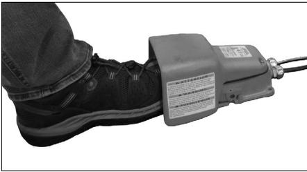
3. Treten Sie den Sicherheitsfußschalter vorübergehend herunter, um sich zu vergewissern, dass das Werkzeug funktionsbereit ist. Die untere Rolle muss sich von der Vorderseite des Werkzeugs aus gesehen im Uhrzeigersinn drehen. Nehmen Sie den Fuß vom Schalter.
