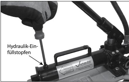
**2a.** Entfernen Sie den Einfüllstopfen am hinteren Ende der Hydraulik-Handpumpe.
