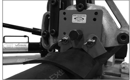
9. Lösen Sie die Flügelmutter und stellen Sie jede Schutzvorrichtung so ein, dass sie mit dem Block übereinstimmt und diesen leicht gegen das Rohr drückt. Ziehen Sie die Flügelmutter fest, um die Schutzvorrichtungen in ihrer Position zu sichern. Entfernen Sie den Einstellblock für die Schutzvorrichtungen.
