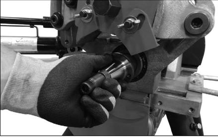
3. Wenn der Bolzen die Spindel nicht mehr weiter nach außen bewegt, ziehen Sie die Spindelbaugruppe aus der Hauptwelle des Werkzeugs heraus. Bewahren Sie die Spindelbaugruppe an einem sicheren Ort auf.
