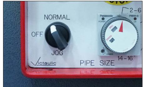
8a. Drehen Sie den Wahlschalter auf die „NORMAL“-Position. Der Werkzeugkopf sollte sich absenken, wenn der Fußschalter heruntergetreten wird, und sich auf Ruhstellung anheben, wenn der Fußschalter freigegeben wird.
