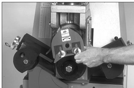
3. Schieben Sie die obere Rolle und die Halteplatte wie gezeigt von der oberen Welle herunter. Bewahren Sie diese Komponenten im Gehäuse auf.
