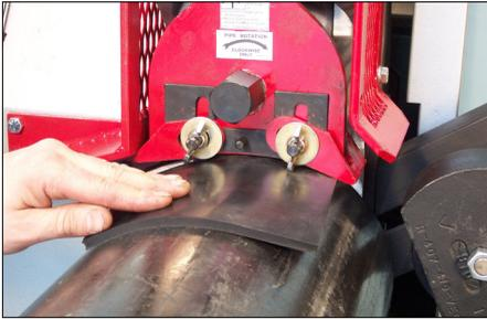
10. Halten Sie den Einstellblock für die Schutzvorrichtungen fest gegen das Rohr. Drücken Sie ihn unter die verstellbaren Schutzvorrichtungen.
