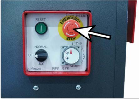
11. Ziehen Sie die „EMERGENCY STOP“-Taste am Bedienpult heraus.
