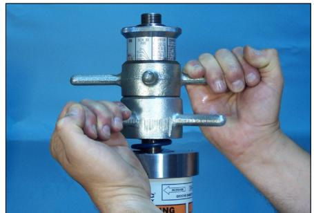
4. Drehen Sie die Tiefeneinstellsperre gegen den Uhrzeigersinn, um die Tiefeneinstellung in dieser Position zu verriegeln.
