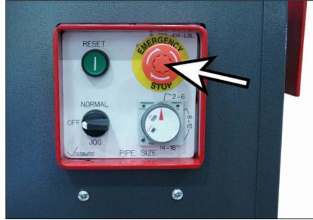
14. Schalten Sie das Hydrauliksystem durch Drücken der „EMERGENCY STOP“-Taste am Bedienpult ab.
