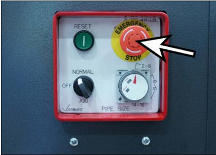
5. Ziehen Sie die „EMERGENCY STOP“-Taste und überzeugen Sie sich, dass die Stromversorgung zum Motor ausgeschaltet bleibt. Heruntertreten des Fußschalters oder Einstellung des Wahlschalters dürfen keine Auswirkungen auf den Zustand des Werkzeugs haben. Alle Komponenten müssen ausgeschaltet bleiben.
