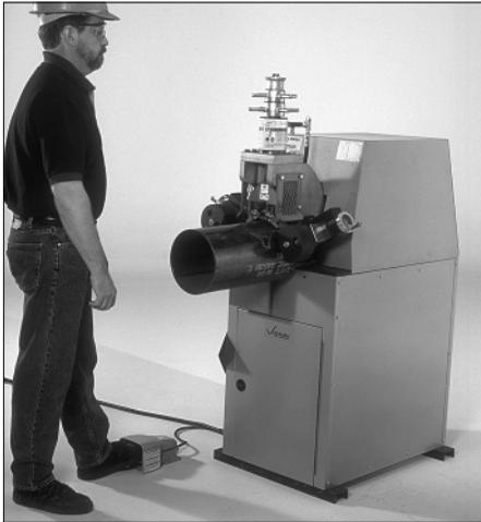
6. Betätigen Sie den Sicherheitsfußschalter, um die obere Rolle abzusenken und in festen Kontakt mit dem Rohr zu bringen. Nehmen Sie den Fuß vom Sicherheitsfußschalter.
