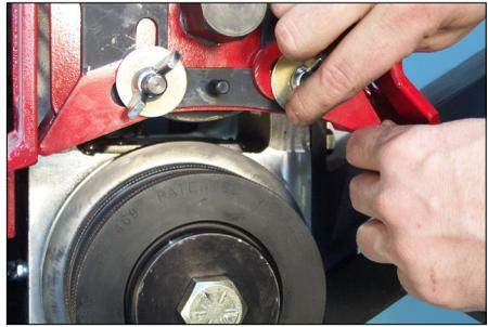
**2.** Lösen Sie die Flügelmuttern und schieben Sie die verstellbaren Schutzvorrichtungen ganz nach oben. Ziehen Sie die Flügelmuttern fest.
