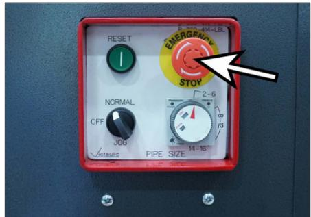
4. Drücken Sie die „EMERGENCY STOP“-Taste und überzeugen Sie sich, dass die Stromversorgung zum Motor dadurch unterbrochen wurde. Heruntertreten des Fußschalters, Drücken der Starttaste oder Einstellung des Wahlschalters dürfen keine Auswirkungen auf den Zustand des Werkzeugs haben. Alle Komponenten müssen ausgeschaltet bleiben.
