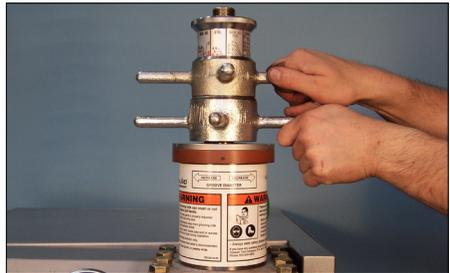
**3.** Stellen Sie den Nutdurchmesseranschlag für die zu nutende Rohrgröße und Schedule/Stärke ein. Drehen Sie die Tiefeneinstellsperre zurück und richten Sie die Tiefeneinstellung auf den richtigen Durchmesser und die richtige Stärke aus. Verriegeln Sie die Tiefeneinstellung mit der Tiefeneinstellsperre. Siehe Abschnitt „Nutbare Rohrlängen“.
