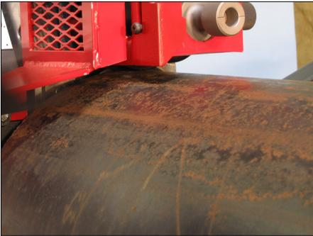
8. Treten Sie den Sicherheitsfußschalter herunter, während Sie das Rohr von Hand abstützen. Die obere Rolle schiebt sich bis zum Rohr vor. Nehmen Sie Ihre Hände vom Rohr.
