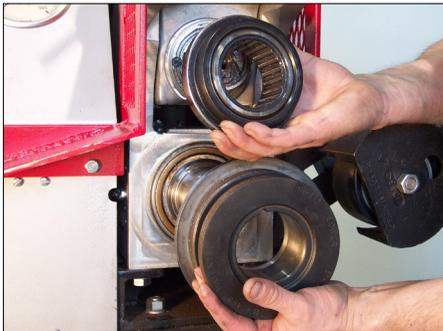
**1.** Vergewissern Sie sich, dass der für die Rohrgröße und das Material richtige Rollensatz am Werkzeug angebracht ist. Die Rollen sind mit Rohrgröße und Teilenummer versehen und weisen die Farbkennzeichnung des jeweiligen Rohrmaterials auf (siehe die Tabellen auf Seite 46). Falls nicht die richtigen Rollen am Werkzeug angebracht sind, lesen Sie den Abschnitt „Rollenwechsel!“.
