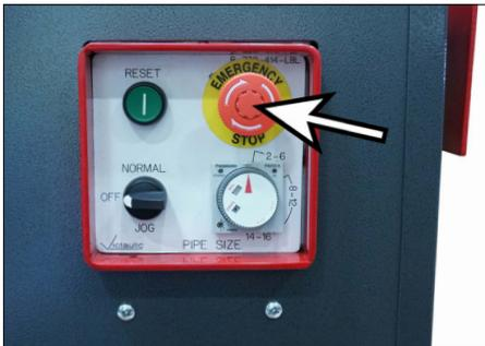
2. Ziehen Sie die „NOTSTOPPTASTE“ am Bedienpult heraus.
