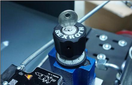
2. Stecken Sie den Schlüssel wie gezeigt in das Regelventil für die Kolbengeschwindigkeit. Drehen Sie den Schlüssel, um das Ventil zu entriegeln.
