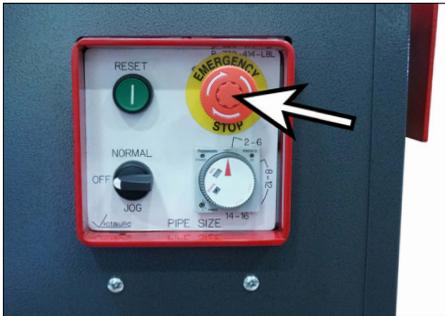
5. Ziehen Sie die „EMERGENCY STOP“-Taste am Bedienpult heraus.
