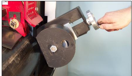
**4.** Ziehen Sie die Rohrstütze bei Bedarf zurück, um das Rohr über die untere Rolle einzuführen. Lösen Sie dafür den Verschlusshebel und betätigen Sie das Handrad, um die Rolle der Rohrstütze zurückzuziehen. Ziehen Sie den Verschlusshebel fest.
