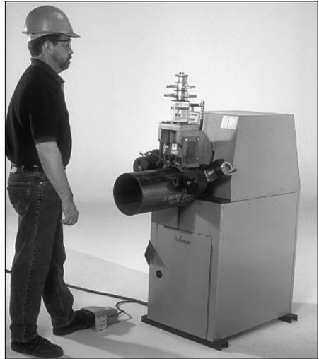
6. Betätigen Sie den Sicherheitsfußschalter, um das Werkzeug einzuschalten und die obere Rolle abzusenken und in festen Kontakt mit dem Rohr zu bringen.
