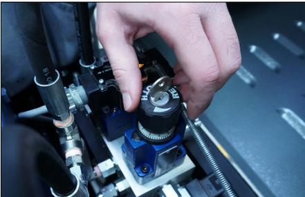
3. Wenn der Schlüssel im Ventil eingesetzt ist, drehen Sie den Knopf, bis er „einrastet“. Stellen Sie das Ventil wie in der Tabelle auf dieser Seite gezeigt richtig ein.
