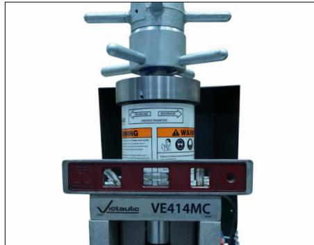
3. Das Werkzeug VE414MC ist für den Einsatz an einem festen Standort vorgesehen und muss auf einem ebenen Betonboden oder Sockel aufgestellt werden. Nachdem ein passender Standort gewählt wurde, muss das Werkzeug in Längs- und Querrichtung nivelliert und sicher verankert werden. Ein nicht nivelliertes Werkzeug kann sich stark negativ auf den Nutvorgang auswirken. Legen Sie die Wasserwaage zur Überprüfung der Nivellierung wie oben dargestellt direkt auf die Werkzeugflächen.
