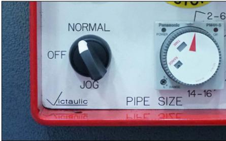
4. Vergewissern Sie sich, dass der Wahlschalter am Bedienpult auf der „NORMAL“-Position steht.
