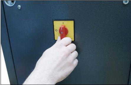
1. Stellen Sie den Hauptschalter an der Seite des Werkzeugs auf Position „ON“.
