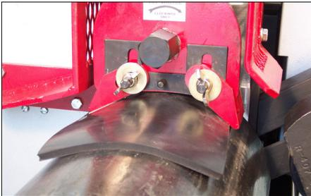
11. Lösen Sie die Flügelmutter und stellen Sie jede Schutzvorrichtung so ein, dass sie den Block leicht gegen das Rohr drückt. Ziehen Sie die Flügelmutter fest, um die Schutzvorrichtungen in ihrer Position zu sichern.
