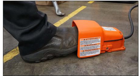
7. Treten Sie den Sicherheitsfußschalter herunter, überzeugen Sie sich davon, dass das Werkzeug läuft, und geben Sie dann den Sicherheitsfußschalter wieder frei.
