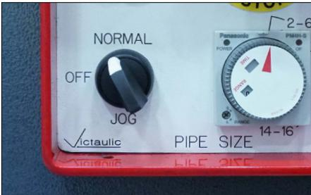
13. Seien Sie darauf vorbereitet, das Rohr abzustützen, und drehen Sie den Wahlschalter auf die „NORMAL“-Position. Die Baugruppe aus Arm/oberer Rolle kehrt zu ihrer oberen Position zurück, und das Rohr wird freigegeben.
