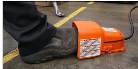
5. Betätigen Sie den Sicherheitsfußschalter und warten Sie, bis der Tiefenanschlag aufliegt und den Motor auslöst. Bestätigen Sie die Drehrichtung der unteren Rolle und geben Sie dann den Sicherheitsfußschalter frei.
