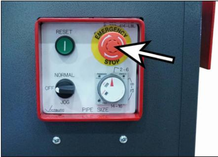
3. Ziehen Sie die „EMERGENCY STOP“-Taste am Bedienpult heraus.
