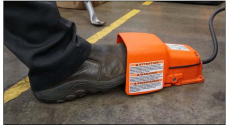
3. Treten Sie den Sicherheitsfußschalter herunter, überzeugen Sie sich davon, dass das Werkzeug läuft, und geben Sie dann den Sicherheitsfußschalter wieder frei.
