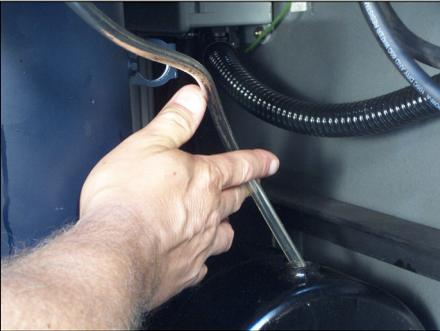
5. Stecken Sie das Ende des Entlüftungsschlauchs (durchsichtiger Schlauch) so in den Tank, dass es in die Hydraulikflüssigkeit eintaucht.
