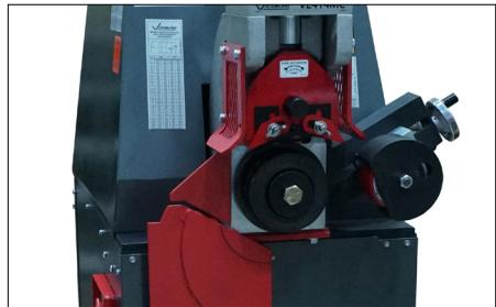
6. Die untere Rolle muss sich von der Vorderseite des Werkzeugs aus gesehen **im Uhrzeigersinn** drehen. Wenn die Drehung im Uhrzeigersinn erfolgt, ist der Stromanschluss abgeschlossen.
