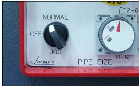
8. Seien Sie darauf vorbereitet, das Rohr abzustützen, und drehen Sie den Wahlschalter auf die „NORMAL“-Position. Die Baugruppe aus Arm/oberer Rolle kehrt zu ihrer oberen Position zurück, und das Rohr wird freigegeben.
