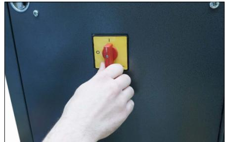
3. Stellen Sie den Hauptschalter an der Seite des Werkzeugs auf Position „ON“.
