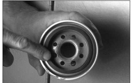
6. Schmieren Sie die Dichtung des neuen Hydraulikölfilters mit neuem Hydrauliköl. Bringen Sie den neuen Filter handfest im Werkzeug an.
