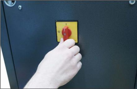
7. Stellen Sie den Hauptschalter an der Seite des Werkzeugs auf Position „ON“.
