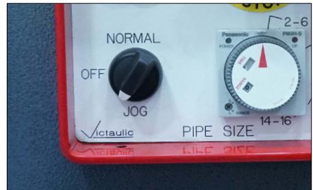
8b. Drehen Sie den Wahlschalter auf die „JOG“-Position. Der Werkzeugkopf sollte sich absenken, wenn der Fußschalter heruntergetreten wird, und in seiner Stellung bleiben, wenn der Fußschalter freigegeben wird.
