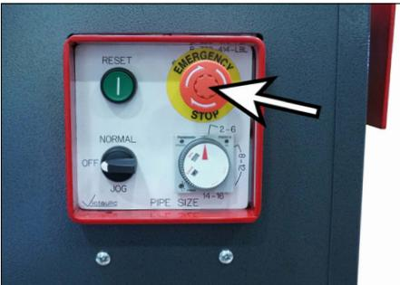
9. Ziehen Sie die „EMERGENCY STOP“-Taste am Bedienpult heraus.
