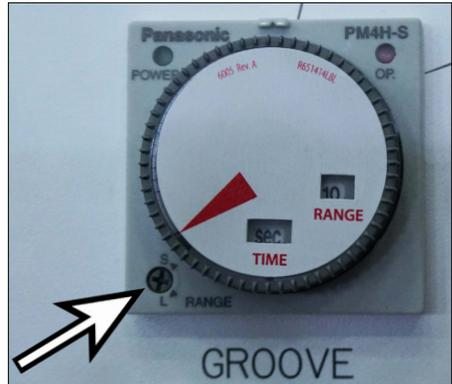
2. Drehen Sie die Zeitbereichsschraube in der Ecke unten links am Timer bei Bedarf auf den gewünschten, auf der Einstellscheibe gezeigten Bereich.
