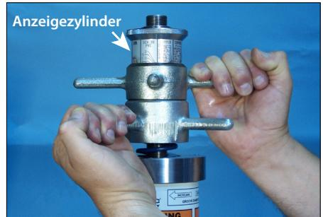
3. Lösen Sie die Tiefeneinstellung aus der Tiefeneinstellsperre. Richten Sie die Oberkante der Tiefeneinstellung auf die unterste Linie der richtigen Größen- und Schedule-Markierung am Anzeigezylinder aus. Halten Sie die Tiefeneinstellung fest, damit sie sich nicht drehen kann.
