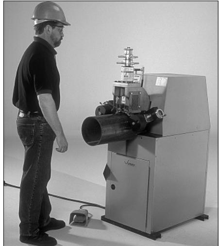
7. Nehmen Sie den Fuß vom Sicherheitsfußschalter. Seien Sie darauf vorbereitet, das Rohr abzustützen, weil die Schiebepatte/obere Rolle in die oberste Position zurückkehrt und das Rohr von den Rollen freigegeben wird.
