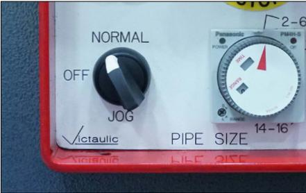
8. Vergewissern Sie sich, dass der Wahlschalter am Bedienpult auf der „NORMAL“-Position steht.
