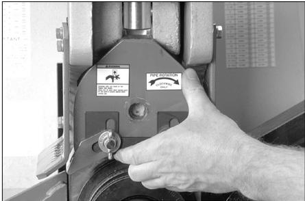
**2.** Bringen Sie die Halteplatte der oberen Rolle an. Richten Sie dafür wie oben gezeigt die Lasche an der Platte auf die Aussparung in der Schiebepatte aus.
