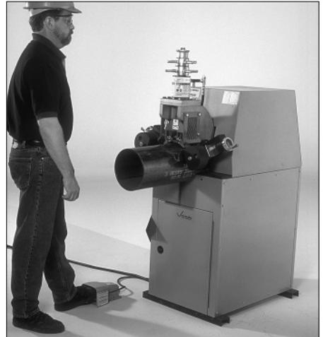
8. Betätigen Sie den Sicherheitsfußschalter, um die obere Rolle abzusenken und in festen Kontakt mit dem Rohr zu bringen. Nehmen Sie den Fuß vom Sicherheitsfußschalter.
