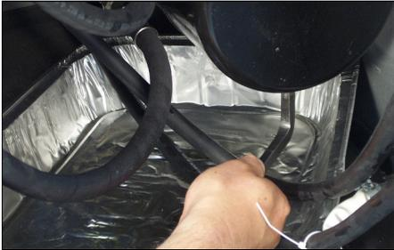
3. Stellen Sie einen Behälter, der groß genug für 1 ½ Gallonen/6 Liter Öl ist, unter den Ablassstopfen des Öltanks. Nehmen Sie den Ablassstopfen an der Unterseite des Hydrauliköltanks ab. Lassen Sie das Öl vollständig in den 1 ½-Gallonen/6-Liter-Behälter (oder größer) ablaufen.
