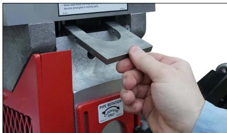
9. Lassen Sie das Schiebeplatten-Abstandsstück oben auf der Schiebeplatte einschnappen.
