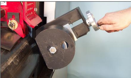
2. Lösen Sie den Verschlusshebel der Rohrstütze. Ziehen Sie die Rolle der Rohrstütze mit Hilfe des Handrads vollständig zurück.
