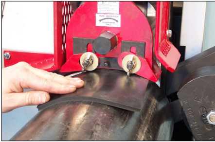
10. Przytrzymać podkładkę ustawiania osłony na rurze. Wepchnąć pod osłony regulowane.
