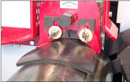
11. Poluzować nakrętki skrzydełkowe i wyregulować każdą osłonę, tak aby była ustawiona zgodnie z podkładką i lekko dociskała ją do rury. Dokręcić nakrętki skrzydełkowe, aby unieruchomić osłony na swoim miejscu.
