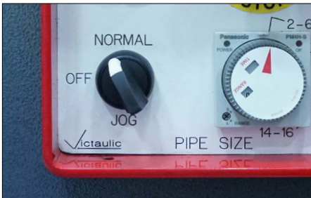
13. Przygotować się do podparcia rury i ustawić przełącznik wybierakowy w pozycji „NORMAL” (normalnej). Ramię/zespół walca górnego wróci do położenia górnego i nastąpi zwolnienie rury.
