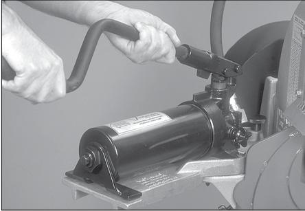
5. Introduire la poignée de la pompe manuelle dans le bras de levier de la pompe. Placer la poignée de sorte que la manette soit tournée vers le bas. Verrouiller la poignée dans cette position avec la vis de réglage ou l'écrou et le boulon fournis.
