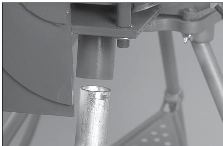
**10.** Insérer entièrement le dessus des pieds dans leurs logements sous la tête porte-outils. Faire pivoter le tout pour qu'il s'insère complètement dans le logement. Les boulons à tête hexagonale sur les pieds doivent être orientés vers l'arrière de la machine (vers le bloc d'entraînement). Serrer le boulon à tête hexagonale à l'aide d'une clé.
