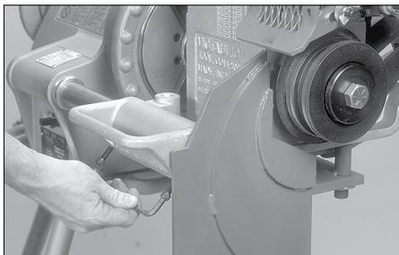
**8.** Serrer les quatre vis de réglage tel qu'indiqué, afin de fixer la rainureuse aux bras de support.
