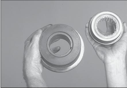
**1.** Vérifier que le jeu de molettes installé sur la rainureuse convient au matériau et au diamètre de tube à rainurer. Les molettes sont marquées du diamètre et de la référence du tube. De plus, elles comportent un code de couleur en fonction du matériau du tube à rainurer. Voir « Spécifications des rainures par moletage ». Si les molettes adéquates ne sont pas installées sur la rainureuse, se reporter à « Remplacement des molettes ».
