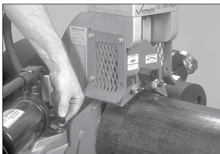
16. Ouvrir la vanne hydraulique pour libérer le tube. Retirer le tube de la rainureuse
