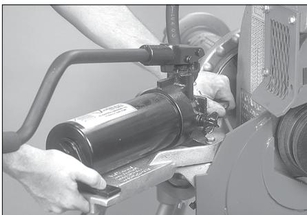
**7.** Replacer et fixer la pompe et la table sur le côté de la rainureuse.
