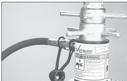
13. Poursuivre le processus de rainurage jusqu'à ce que la butée de profondeur entre complètement en contact avec le haut du vérin d'alimentation hydraulique. Continuer à faire tourner le tube de 2 à 3 tours pour assurer une rainure complète.
