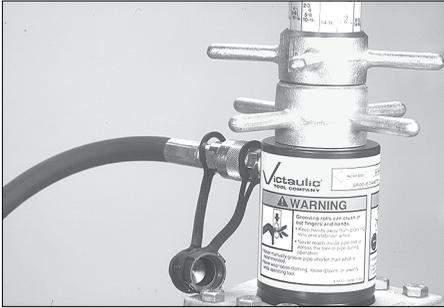
14. Raccorder le flexible hydraulique entre la pompe manuelle et le vérin de commande au moyen des raccords rapides fournis.
