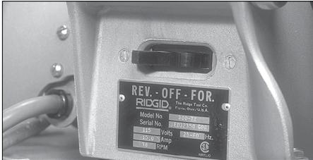
3. Pour l'utilisation de la rainureuse VE416FS, tourner l'interrupteur du bloc d'entraînement en vue d'une rotation **dans le sens des aiguilles d'une montre** de la molette inférieure et du tube, vue de face. Sur le Victaulic VPD752 ou Ridgid 300, si **l'interrupteur est réglé dans la position INVERSE, cela entraîne la rotation de la molette inférieure et du tube dans le sens des aiguilles d'une montre**.
