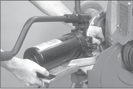
**2.** Retirer la pompe et la table de montage du côté de la rainureuse.
