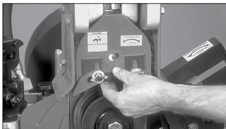
**2.** Installer la plaque de maintien et le boulon de la molette supérieure. Aligner la languette de la plaque sur l'encastrement de la glissière, comme indiqué. Avec une clé, serrer le boulon à fond.
