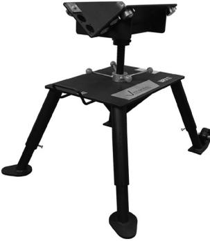
Le support de tube portable, réglable Victaulic VAPS112, du type à rouleau, comporte quatre pieds pour une stabilité renforcée. Les rouleaux de transfert à billes réglables pour tubes de 2 à 12 po/60,3 à 323,9 mm et le support « V » pour tubes de  $\frac{3}{4}$  à 1  $\frac{1}{2}$  po/26,9 à 48,3 mm permettent un mouvement linéaire et rotatif. La conception à tourniquet facilite le rainurage des deux extrémités de tube. Contacter Victaulic pour plus de détails.
