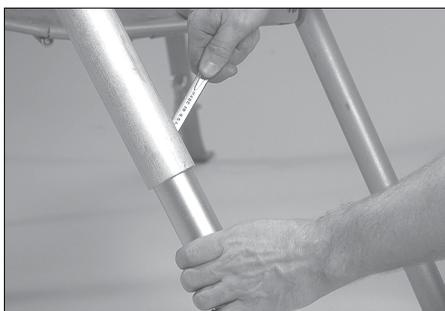
**12.** Desserrer les boulons à tête hexagonale pour libérer les pieds inférieurs et les laisser tomber sur le sol. Tourner les patins des pieds, en bas, jusqu'à ce qu'ils reposent à plat sur le sol et serrer les boulons à tête hexagonale avec la rainureuse pour amener le tout en position de niveau.
