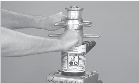
**3.** Régler la butée de diamètre de rainure en fonction du diamètre du tube et de l'épaisseur à rainurer. Pour cela, désactiver le verrouillage de la butée de profondeur et aligner la butée de profondeur au diamètre et à l'épaisseur appropriés. Verrouiller le réglage de la profondeur au moyen du verrou.
