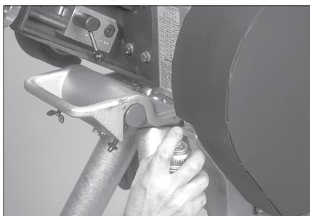
1. Lubrifier l'engrenage d'entraînement comme indiqué à l'aide d'un lubrifiant pour engrenages ouverts à usage intensif en aérosol. (Lubriplate Gear Shield Extra Heavy, ou équivalent). Pour une lubrification complète, brancher la rainureuse sur une prise de courant appropriée et faire tourner l'engrenage d'entraînement à plusieurs endroits en appuyant momentanément sur la commande au pied, puis en lubrifiant l'engrenage à chaque position.
