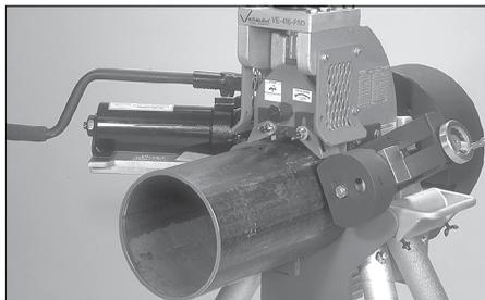
4. Introduire une chute qui correspond au diamètre et à l'épaisseur du tube à rainurer (se reporter au tableau 1), placer le tube sur la molette inférieure, extrémité du tube contre la bride-butée de la molette inférieure.
