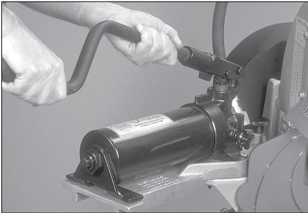
15. Introduire la poignée de la pompe manuelle dans le bras de levier de la pompe. Placer la poignée de sorte que la manette soit tournée vers le bas. Verrouiller la poignée dans cette position avec la vis de réglage ou l'écrou et le boulon fournis.
