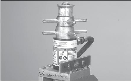
4. Mettre la rainureuse de niveau d'avant en arrière en plaçant un niveau sur le dessus du vérin hydraulique.
