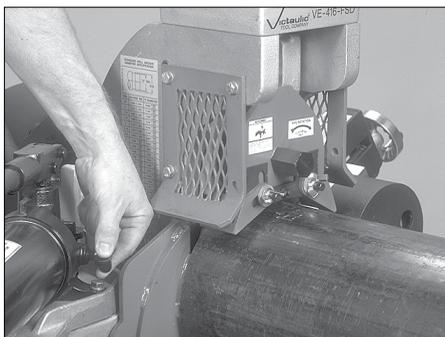
**3.** Ouvrir la vanne en la tournant dans le sens contraire des aiguilles d'une montre et laisser l'air s'échapper.
