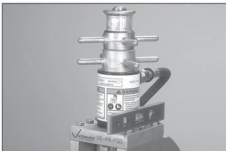
**11.** Mettre la rainureuse de niveau d'avant en arrière en plaçant un niveau sur le dessus de la plaque de montage du cylindre.
