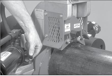
7. Schließen Sie das Druckentlastungsventil an der Pumpe durch Drehen im Uhrzeigersinn.
