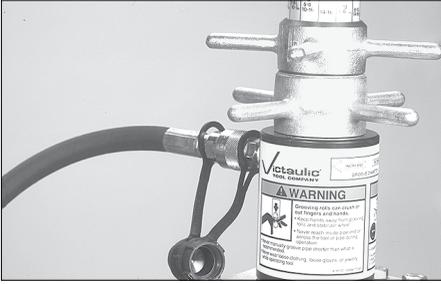
13. Fahren Sie mit dem Nuten fort, bis der Tiefenanschlag vollständigen und festen Kontakt mit der Oberseite des Hydraulikzylinders hat. Setzen Sie die Rohrdrehung um eine bis drei Umdrehungen fort, um sicherzustellen, dass die Nut fertiggestellt wird.
