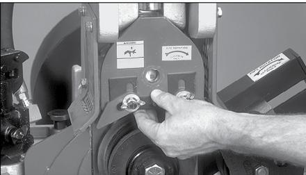
2. Bringen Sie die Halteplatte und Schraube der oberen Rolle an. Richten Sie den Vorsprung an der Platte wie gezeigt auf die Aussparung in der Schiebeplatte aus. Ziehen Sie die Schraube mit einem Schraubenschlüssel fest an.
