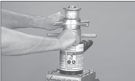
**3.** Stellen Sie den Nutdurchmesseranschlag für die zu nutzende Rohrgröße und Schedule/Stärke ein. Drehen Sie dafür die Tiefeneinstellsperre zurück und richten Sie die Tiefeneinstellung auf den richtigen Durchmesser und die richtige Stärke aus. Verriegeln Sie die Tiefeneinstellung mit der Tiefeneinstellsperre.
