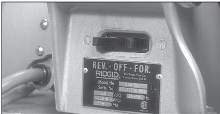
3. Stellen Sie bei Verwendung des VE416FS den Schalter des Motorantriebs so ein, dass von der Vorderseite des Werkzeugs aus gesehen eine Rotation der unteren Rolle und des Rohrs **im Uhrzeigersinn** erfolgt. Wenn der Schalter am Victaulic VPD752 oder Ridgid 300 **auf RÜCKWÄRTS-Position** gestellt wird, bewirkt dies eine Rotation der unteren Rolle und des Rohrs **im Uhrzeigersinn**.
