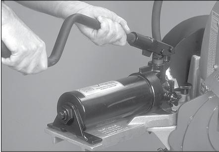
5. Führen Sie den Hebel der Handpumpe in den Hebelarm der Pumpe ein. Positionieren Sie den Hebel so, dass der Griff nach unten zeigt. Arretieren Sie den Hebel mit der Stellschraube oder der dafür vorgesehenen Mutter und Schraube in dieser Position.
