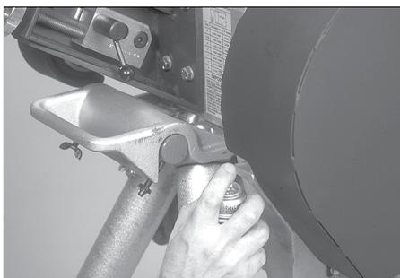
1. Schmieren Sie das Antriebsrad wie gezeigt mit einem Hochleistungsgetriebeöl in Sprayform für hohe Beanspruchung (Lubriplate Gear Shield Extra Heavy oder gleichwertig). Schließen Sie das Werkzeug zur gründlichen Schmierung an eine Steckdose an und rücken Sie das Antriebsrad durch kurze Betätigung des Fußschalters auf verschiedene Positionen vor, um es an jeder Position zu schmieren.
