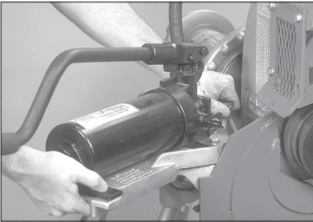
**7.** Bringen Sie die Pumpe und die Aufspannfläche wieder sicher an der Seite des Werkzeugs an.
