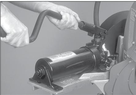
**15.** Führen Sie den Hebel der Handpumpe in den Hebelarm der Pumpe ein. Positionieren Sie den Hebel so, dass der Griff nach unten zeigt. Arretieren Sie den Hebel mit einer Stellschraube oder der dafür vorgesehenen Mutter und Schraube in dieser Position.
