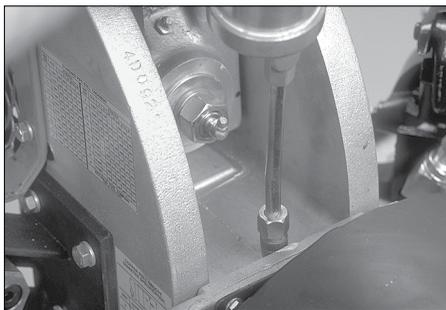
3. Schmieren Sie die Hauptwellenlager an den dafür vorgesehenen Schmiernippeln, siehe Abbildung.
