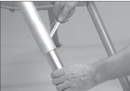
**12.** Lösen Sie die Sechskantschrauben, um die unteren Beine freizugeben, und lassen Sie sie auf den Boden herunter, bis sie flach auf dem Boden aufliegen, und ziehen Sie die Sechskantschrauben mit dem Werkzeug in waagerechter Position fest.
