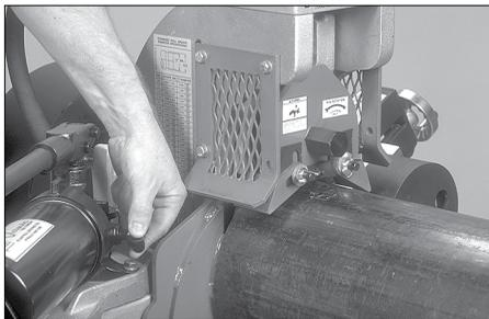
1. Drehen Sie das Entlastungsventil der Pumpe gegen den Uhrzeigersinn, um es vollständig zu öffnen.
