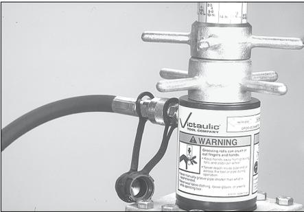
**14.** Schließen Sie den Hydraulikschlauch der Handpumpe mittels der mitgelieferten Schnellanschlüsse am Hydraulikzylinder an.
