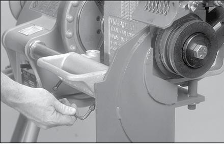
**8.** Ziehen Sie die vier Stellschrauben wie abgebildet an, um das Werkzeug an den Stützarmen zu befestigen.
