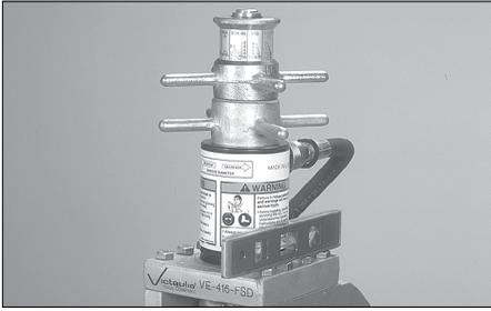
4. Richten Sie das Werkzeug von vorne nach hinten waagrecht aus. Legen Sie dafür eine Wasserwaage oben auf den Hydraulikkolben.
