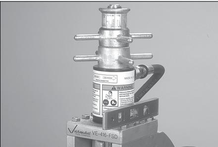
**11.** Richten Sie das Werkzeug von vorne nach hinten waagrecht aus. Legen Sie dafür eine Wasserwaage oben auf die Zylindermontageplatte.
