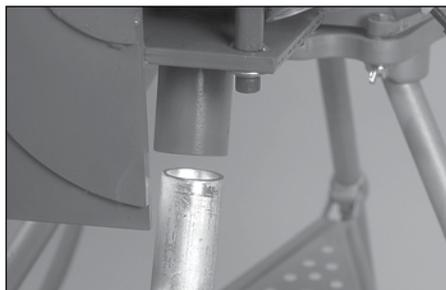
**10.** Inserire la parte superiore dell'assieme gamba completamente nell'incavo sotto l'assieme testa utensile. Ruotare l'assieme in modo da inserirlo completamente nell'incavo. Le viti a testa esagonale sulle gambe devono essere girate verso il retro della macchina (verso l'unità motrice). Serrare la vite a testa esagonale con una chiave.
