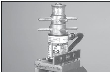
**11.** Livellare l'utensile dalla parte anteriore a posteriore. La parte superiore della piastra di supporto cilindro è una buona posizione da cui misurare il "livello".
