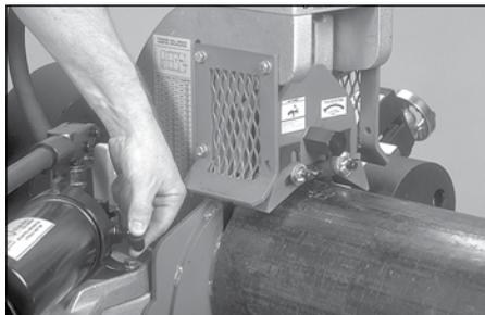
1. Aprire la valvola di rilascio della pressione della pompa idraulica, ruotandola completamente in senso antiorario.
