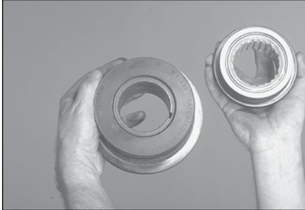
**1.** Verificare che il set di rulli installato sia adatto alle dimensioni e al materiale del tubo da scanalare. I set di rulli sono contrassegnati con dimensioni e numero di parte e sono codificati a colori per identificare il materiale del tubo per motivi di praticità. Fare riferimento alla sezione Valori nominali e selezione dei rulli alle pagine 28 e 29. Se sull'utensile non sono installati i rulli adeguati, fare riferimento alla sezione Sostituzione dei rulli a pagina 20.
