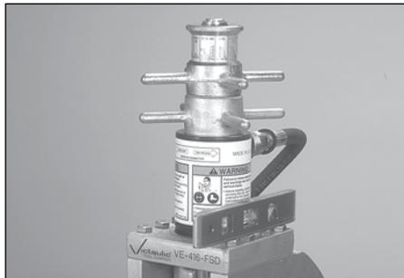
4. Livellare l'utensile dalla parte anteriore a posteriore. La parte superiore del pistone idraulico è una buona posizione da cui misurare il "livello".
