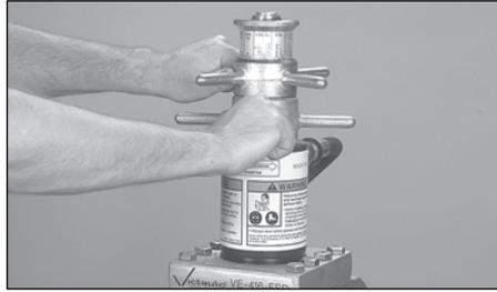
**3.** Impostare il diametro della scanalatura in modo che si fermi alla dimensione del tubo e alla schedule/spessore da scanalare. Per eseguire questa operazione, svitare il blocco per la regolazione di profondità, quindi allineare quest'ultimo al corretto diametro e spessore. Bloccare il regolatore di profondità in posizione, sfruttando l'apposito blocco.
