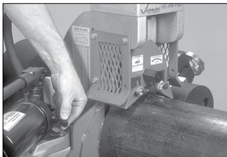
1. Aprire manualmente la valvola di rilascio della pompa a mano (ruotare la manopola in senso antiorario). In tal modo la slitta si sposta in posizione completamente aperta.
