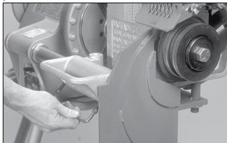
**8.** Serrare le quattro (4) viti di arresto come indicato per fissare l'utensile ai bracci di supporto.
