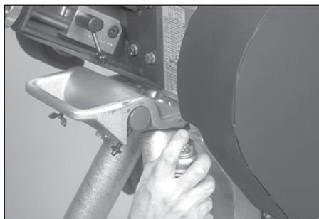
1. Lubrificare l'ingranaggio motore come raffigurato con un lubrificante per ingranaggi scoperti per servizio pesante, di tipo a spruzzo (Lubriplate Gear Shield Extra Heavy o equivalente). Per lubrificare accuratamente, collegare l'utensile a una presa adeguata e fare avanzare a scatti l'ingranaggio premendo l'interruttore a pedale momentaneamente e poi lubrificare l'ingranaggio in ogni posizione.
