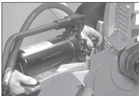
**13.** Montare l'assieme pompa a mano/supporto pompa. Serrare la manopola e quindi serrare la vite di arresto ad alette sul lato inferiore del supporto pompa come illustrato.
