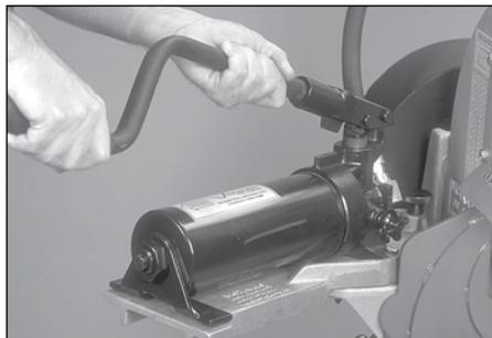
5. Inserire l'impugnatura della pompa nel braccio a leva della stessa. Posizionare l'impugnatura con la presa rivolta verso il basso. Bloccare l'impugnatura in posizione con la vite, il dado o il bullone in dotazione.
