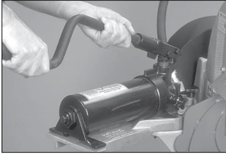
15. Inserire l'impugnatura della pompa a mano nel braccio a leva della stessa. Posizionare l'impugnatura con la presa rivolta verso il basso. Bloccare l'impugnatura in posizione con la vite, il dado o il bullone in dotazione.
