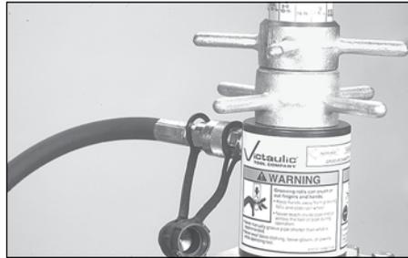
12. Continuare l'operazione di scanalatura fino a quando il blocco per la regolazione della profondità non entra in contatto fermo con la parte superiore del cilindro idraulico. Continuare la rotazione del tubo da una (1) a tre (3) rivoluzioni per assicurarsi che la scanalatura sia completa.
