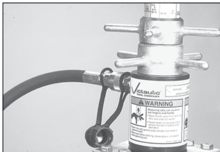
**14.** Collegare il tubo flessibile idraulico dalla pompa a mano al cilindro, sfruttando i giunti rapidi in dotazione.
