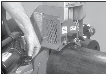
4. Aprire la valvola di rilascio della pressione della pompa idraulica, ruotandola in senso antiorario. Il rullo superiore e il braccio si spostano completamente in alto.
