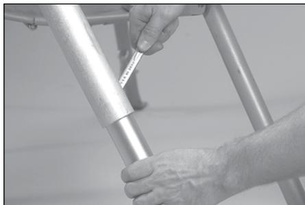
**12.** Allentare le viti esagonali in modo da disimpegnare le gambe inferiori (2) e permettere loro di cadere a terra. Ruotare i pattini delle gambe nel fondo finché non poggeranno sul pavimento e serrare le viti esagonali con l'utensile in posizione piana.
