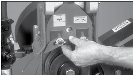
**2.** Installare la piastra di ritegno del rullo superiore e la vite. Allineare la linguetta sulla piastra con l'incavo nella slitta come raffigurato. Serrare saldamente la vite con una chiave.
