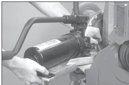
7. Ricollocare la pompa e l'assieme pompa in maniera salda a lato dell'utensile.
