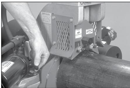
6. Chiudere la valvola di rilascio della pressione sulla pompa, ruotandola in senso orario.
