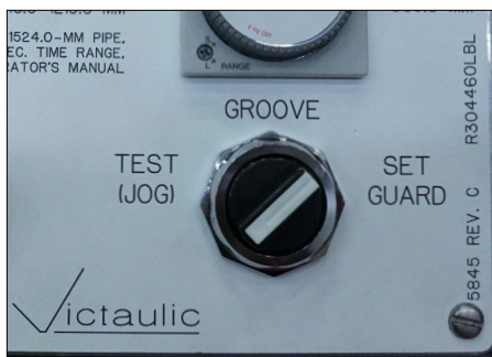
9. Mettre le sélecteur du panneau de commande en mode « SET GUARD » (RÉGLAGE DU GABARIT). Appuyer et maintenir la pédale de sécurité enfoncée. Le rouleau supérieur et le coulisseau commenceront à s'abaisser.
