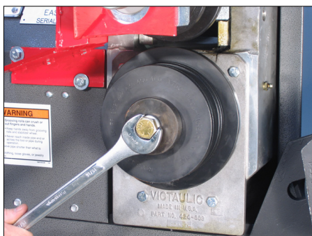
5. Serrer complètement le boulon de maintien du rouleau inférieur pour fixer le rouleau inférieur sur l'arbre principal.
