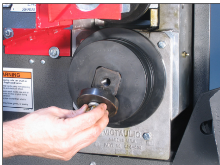
4. Installer la rondelle du rouleau inférieur et le boulon de maintien du rouleau inférieur.
