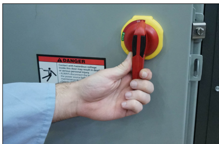
6. Mettre le commutateur d'alimentation principal sur le côté de l'outil à la position « ON ».
