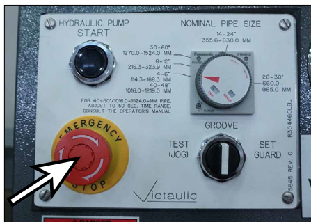
7. Tirer sur le bouton « EMERGENCY STOP » (ARRÊT D'URGENCE) du panneau de commande.
