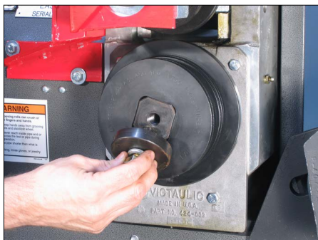
4. Wkręcić śrubę z podkładką mocującą dolny walec.
