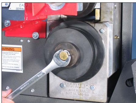
5. Dokręcić całkowicie śrubę mocującą dolny walec, aby zamocować dolny walec na głównym wale
