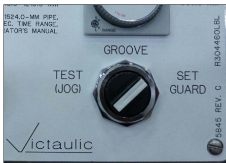
9. Ustawić przełącznik wybierakowy znajdujący się na panelu sterowania w tryb „SET GUARD” (ustawianie osłony). Naciśnąć i przytrzymać nożny wyłącznik bezpieczeństwa. Walce górny i suwak zaczną przemieszczać się w dół.
