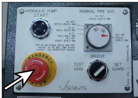
14. Después de que se ha retraído (levantado) completamente la corredera, presione el botón “PARADA DE EMERGENCIA” en el panel de control.
