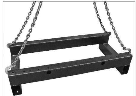
6. Utilizando un método de izaje de cuatro puntos, como se muestra arriba, eleve la base de apoyo inferior sobre el área donde están instalados los anclajes al piso. Alinee los cuatro orificios de la base de apoyo con los cuatro anclajes del piso. Baje lentamente la base de apoyo sobre los anclajes del piso.
