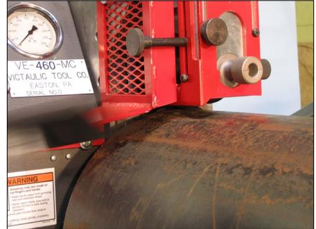
7. Ponga un tramo de tubería del tamaño, material y espesor adecuados sobre el rodillo inferior. Procure que el extremo de la tubería haga contacto con la brida de tope del rodillo inferior. Mientras sostiene la tubería con la mano, presione sin soltar el pedal de accionamiento seguro. El rodillo superior avanzará y hará contacto con la tubería. Quite las manos de la tubería.
