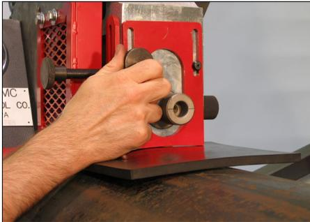
7. Sostenga firmemente la almohadilla de ajuste correcta del protector contra la tubería y empujela bajo los protectores de rodillo. Suelte la perilla en la parte delantera de los protectores de rodillos para bajar la placa sobre la almohadilla de ajuste del protector. Apriete la perilla.
