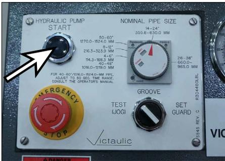
2. Presione el botón “ARRANQUE DE BOMBA HIDRÁULICA”.
