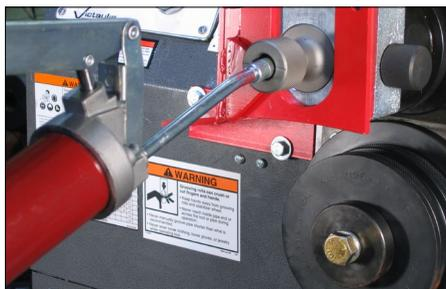
15. Engrase los rodamientos del eje superior, como se muestra, aplicando grasa por la grasería de lubricación situada en la parte delantera del eje superior. Consulte la tabla “Lubricantes recomendados” correspondiente para seleccionar la grasa adecuada.
