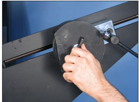
5a. Retire la tuerca mariposa del protector de rodillo estabilizador y quite el protector de rodillo estabilizador.
