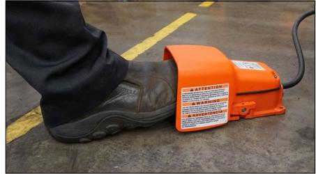
3. Presione el pedal de accionamiento seguro, confirme el funcionamiento de la herramienta y luego suelte el pedal.
