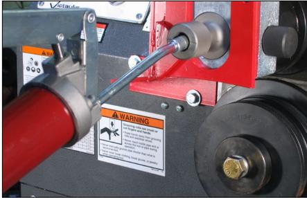
2. Engrase los rodamientos del eje superior cada vez que cambie los rodillos y después de 8 horas de funcionamiento. Se incluye una grasea en la parte delantera dle eje superior. Consulte la tabla "Lubricantes recomendados" correspondiente para seleccionar la grasa adecuada.
