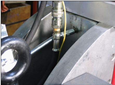
3. Engrase las guías de la corredera. La grasea de las guías de la corredera se ubica en la parte posterior de la corredera y es accesible cuando la cubierta de la herramienta está abierta.
