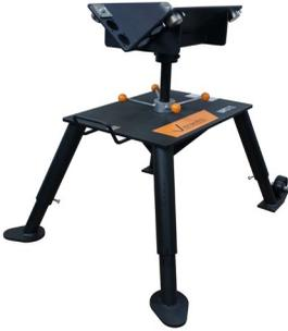
El soporte para tuberías Victaulic VAPS112 es un soporte para tuberías portátil y ajustable que posee rodillos y cuatro patas para mayor estabilidad. El modelo VAPS112 sirve para tuberías de ¾ a 12 pulg./de 26.9 a 323.9 mm (de 1 ½ pies/0.5 metros hasta longitudes aleatorias simples de 20 pies/6 metros) y ofrece una capacidad de carga de 1075 lb/490 kg. El diseño de torniquete permite el ranurado sencillo de ambos extremos de tuberías. Consulte los detalles con Victaulic.
