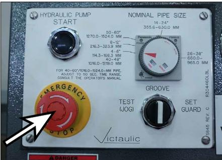
8. Tire el botón de "PARADA DE EMERGENCIA" en el panel de control y el gabinete eléctrico a la posición levantada.
