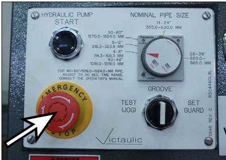
2. Tire el botón de “PARADA DE EMERGENCIA” en el panel de control y el gabinete eléctrico a la posición levantada.
