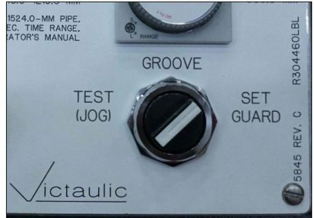
9. Coloque el interruptor selector del panel de control en el modo "AJUSTAR PROTECTOR". Presione el pedal de accionamiento seguro sin soltarlo. El rodillo superior y la corredera comenzarán a moverse hacia abajo.
