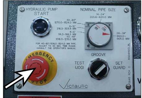
5. Antes de realizar ajustes en el protector de la herramienta, presione el botón "PARADA DE EMERGENCIA" en el panel de control. El rodillo superior seguirá asentado contra la tubería.
