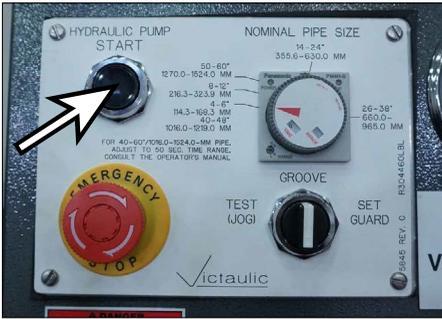
17. Presione el botón "ARRANQUE DE BOMBA HIDRÁULICA". Deje funcionando la bomba hidráulica por 3 – 5 minutos.
