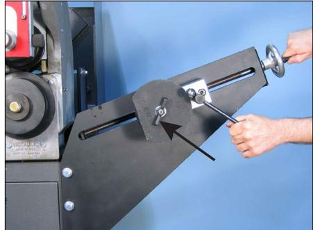
6. Apriete la palanca de cierre del estabilizador y la tuerca mariposa del protector de rodillo estabilizador.
