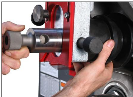
**3a.** Mientras sostiene el rodillo superior, extraiga el eje superior del rodillo superior/corredera tirando de él hacia fuera.
