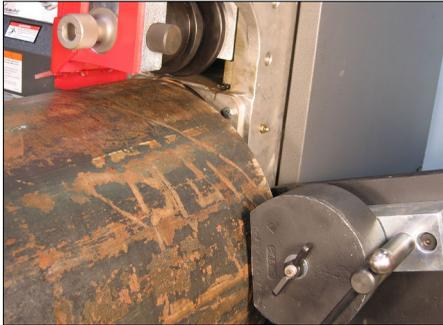
4. Utilizando el volante del estabilizador, ajuste el rodillo estabilizador hacia la tubería.
