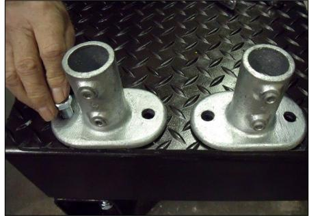
**19a.** Instale una base de pasamanos sobre la plataforma en las ocho ubicaciones de la plataforma/apoyo de la herramienta. Asegúrese de que los orificios en las bases de los pasamanos estén alineados con los orificios en las plataformas/base de apoyo y que los tornillos de fijación en las bases de los pasamanos se orienten lejos de la plataforma, como se muestra.
