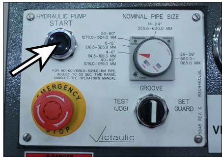
8. Presione el botón "ARRANQUE DE BOMBA HIDRÁULICA". El aceite hidráulico empezará a fluir desde la conexión en "T" a través del tubo de purga hasta el depósito de aceite hidráulico.
