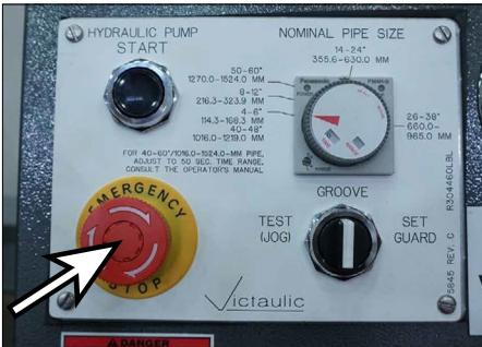
19. Desactive el sistema hidráulico presionando el botón "PARADA DE EMERGENCIA" en el panel de control.
