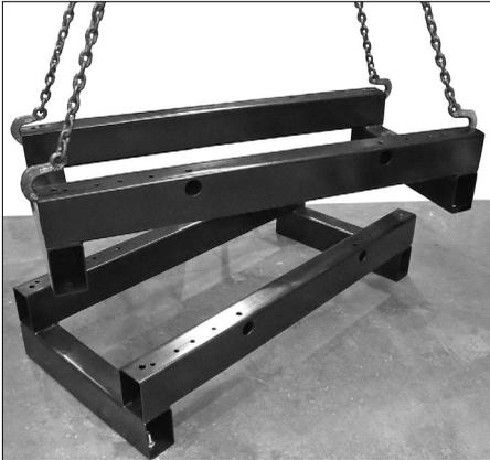
**8.** En este momento, se puede instalar una base de apoyo adicional. Siguiendo el mismo método de izaje de cuatro puntos que se muestra en el paso 6, eleve la segunda base de apoyo sobre la primera. Alinee los cuatro orificios en la segunda base de apoyo con los cuatro orificios en la primera. Baje lentamente la segunda base de apoyo sobre la primera.
