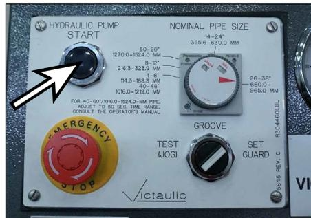
11. Presione y suelte el botón "ARRANQUE DE BOMBA HIDRÁULICA". El motor de la bomba hidráulica de la herramienta se energizará y el eje del ariete de la herramienta se retraerá a la posición neutral.
