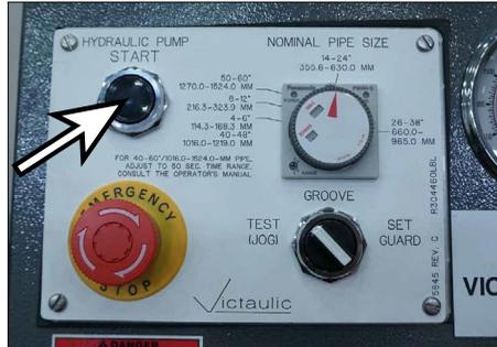
3. Coloque el interruptor selector en el panel de control en el modo de “PRUEBA (MARCHA GRADUAL)” y presione momentáneamente el botón de “ARRANQUE DE LA BOMBA HIDRÁULICA” para energizar el rodillo inferior. Observe el sentido de rotación del rodillo inferior. Suelte el botón de “ARRANQUE DE LA BOMBA HIDRÁULICA” para desenergizar el rodillo inferior.
