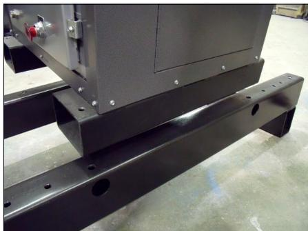
**13.** Al bajar la herramienta sobre la o las bases de apoyo, asegúrese de que el cable de alimentación no quede en el medio y que el cable del pedal de accionamiento seguro esté desconectado para evitar daños. Los orificios en la base de la herramienta se deben alinear con los orificios más internos de la base de apoyo, como se muestra.
