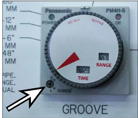
2. Si es necesario, haga girar el tornillo de rango de tiempo, ubicado en la esquina inferior izquierda del temporizador, al rango deseado indicado en la cara del dial.
