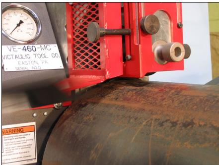
11. Ponga un tramo de tubería del tamaño, material y espesor adecuados sobre el rodillo inferior. Procure que el extremo de la tubería haga contacto con la brida de tope del rodillo inferior. Quite las manos de la tubería.
