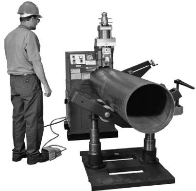
13. Para comenzar la operación de ranurado, presione el pedal de accionamiento seguro sin soltarlo. Esto hará avanzar el rodillo superior hasta que haga contacto con la tubería. El rodillo inferior comenzará a rotar y empezará a formarse la ranura.
