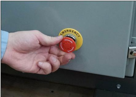
3. Tire el botón de "PARADA DE EMERGENCIA" en el panel de control y el gabinete eléctrico a la posición levantada.
