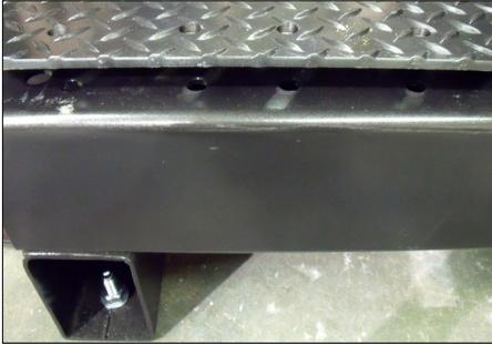
**17.** Instale la plataforma sobre la base de apoyo. Alinee los orificios en la plataforma con los orificios en la base de apoyo, como se muestra. Repita este paso al otro lado de la herramienta.
