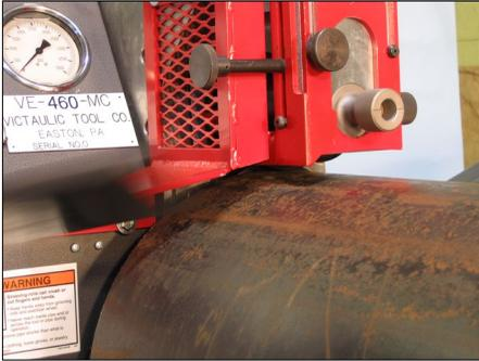
3. Inserte un tramo de tubería del tamaño y espesor adecuados sobre el rodillo inferior. Procure que el extremo de la tubería haga contacto con la brida de tope del rodillo inferior. La tubería deberá descansar directamente sobre el rodillo y no deberá estar desviado hacia un lado o hacia otro.
