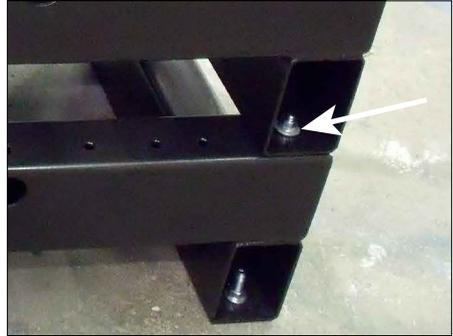
**10.** Inserte un perno con arandela plana por los orificios en la segunda y la primera base de apoyo. Coloque una arandela plana, una arandela de seguridad y una tuerca en el extremo del perno. Apriete la tuerca a fondo hasta que la arandela de seguridad quede comprimida. Repita este paso con las otras tres ubicaciones de orificios.
