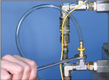
4. Instale el tubo de purga en la conexión en "T", como se muestra arriba. Inserte el otro extremo del tubo de purga en el orificio de llenado/venteo en el depósito de aceite hidráulico. **NOTA:** El tubo de purga consta de una conexión estriada para manguera NPT de ¼ pulg. y 4 pies/1.2 m de manguera de vinilo transparente con D.I. de ¼ de pulg. (suministrada).
