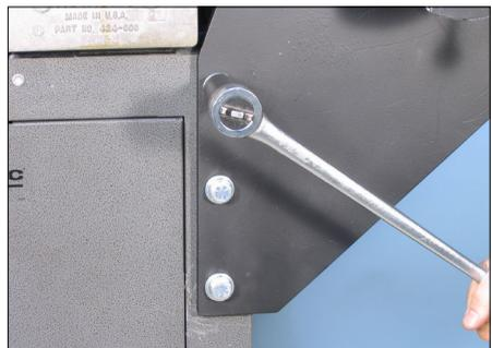
4. Retire los pernos y las arandelas de seguridad del estabilizador de la parte delantera y derecha de la herramienta. Coloque el conjunto del estabilizador en la esquina delantera derecha de la herramienta de modo que los orificios de montaje del conjunto del estabilizador se alineen con los orificios de montaje de la herramienta. Utilizando los pernos y las arandelas de seguridad del estabilizador que retiró antes de la herramienta, fije el conjunto del estabilizador a la herramienta.
