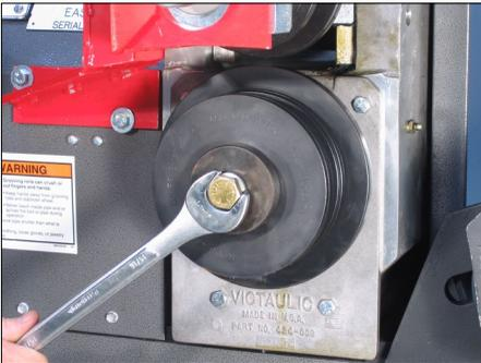
5. Apriete completamente el perno de retención del rodillo inferior para fijarlo en el eje principal.
