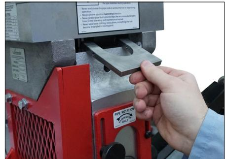
7. Retire el espaciador deslizante encajado a presión del cabezal de la herramienta, como se muestra arriba.
