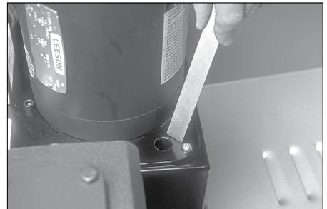
2. Llene el depósito de aceite hidráulico con aceite hidráulico fresco hasta que el nivel llegue a 1 – 2 pulg./ 25 – 50 mm de la parte superior del depósito de aceite hidráulico. Consulte la sección "Lubricantes recomendados".
