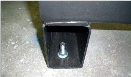
**7.** Instale una arandela plana y una tuerca en cada uno de los anclajes del piso, como se muestra. Apriete la tuerca por completo.
