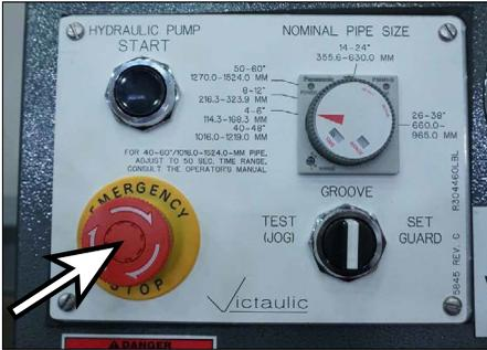
5. Tire el botón “PARADA DE EMERGENCIA” y confirme que la energía al motor continúa apagada. Presionar el pedal, presionar el botón de arranque o ajustar el interruptor selector no deberían tener ningún efecto en el estado de la herramienta. Todos los componentes deberían permanecer apagados.
