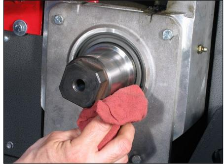
**1.** Antes de la instalación, limpie el eje principal y el rodillo inferior para eliminar la suciedad y las escamas.
