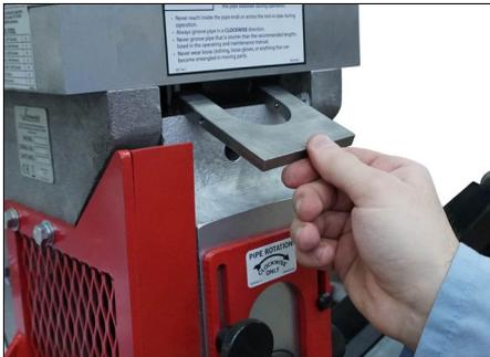
11. Instale a presión el espaciador deslizante en la herramienta, como se muestra arriba.
