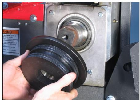
3. Retire el rodillo inferior tirando de él para sacarlo del eje principal. Guarde el rodillo inferior en el gabinete de la herramienta. Si el rodillo inferior no puede retirarse manualmente, utilice un extractor de engranajes convencional.
