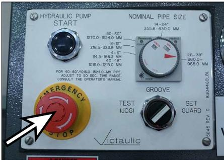
9. Después de retraer (levantar) completamente la corredera, presione el botón “PARADA DE EMERGENCIA” en el panel de control.
