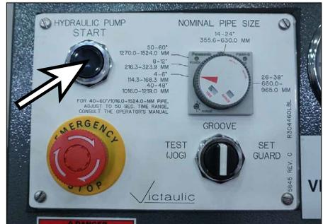
10. Presione el botón "ARRANQUE DE BOMBA HIDRÁULICA".
