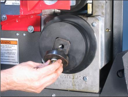
4. Instale la arandela del rodillo inferior y el perno de retención del rodillo inferior.
