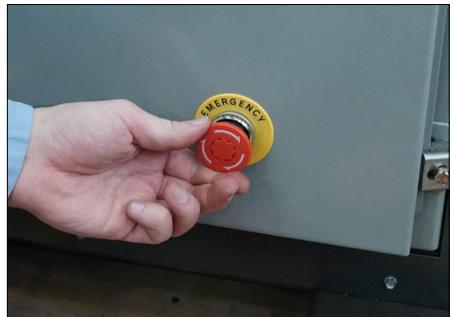
16. Tire el botón de “PARADA DE EMERGENCIA” en el panel de control y el gabinete eléctrico a la posición levantada.
