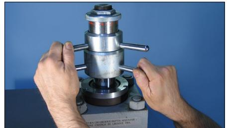
4. Gire el tope de diámetro de ranura en sentido antihorario para bloquear al ajustador de profundidad en posición.
