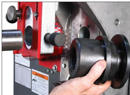
**3b.** Retire el rodillo superior. Guarde el rodillo superior en el gabinete de la herramienta.
