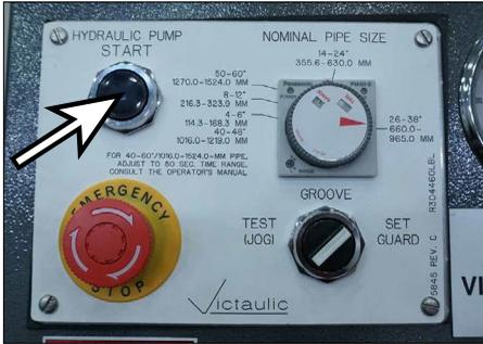
8. Presione el botón “ARRANQUE DE BOMBA HIDRÁULICA” para retraer (levantar) la corredera.
