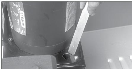
14. Lleve el nivel del aceite hidráulico a 1 – 2 pulg./ 25 – 50 mm de la parte superior del depósito de aceite hidráulico. NO llene el depósito de aceite hidráulico en exceso, ya que el aceite podría rebalsarse por la expansión térmica. Consulte la tabla “Lubricantes recomendados” correspondiente para seleccionar el aceite hidráulico correcto.
