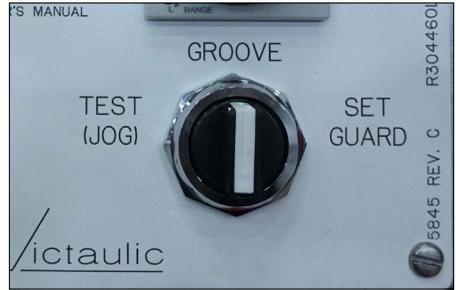
9. Verifique que el interruptor selector del panel de control esté en la posición "RANURAR".
