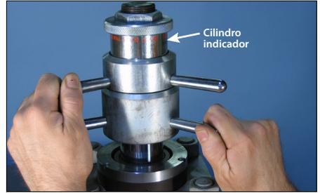
2. Ubique el diámetro y espesor adecuados en la etiqueta indicadora de tamaño de tuberías del tope de profundidad. El cilindro indicador de tamaño de tubería se puede girar para una visualización más fácil.
