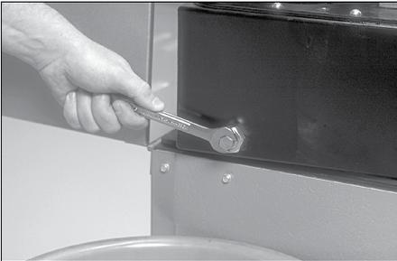
8. Retire el tapón de drenaje para vaciar el aceite hidráulico antiguo del depósito de aceite hidráulico.
