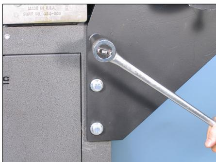
4. Retire los pernos y las arandelas de seguridad del estabilizador de la parte delantera y derecha de la herramienta. Coloque el conjunto del estabilizador en la esquina delantera derecha de la herramienta de modo que los orificios de montaje del conjunto del estabilizador se alineen con los orificios de montaje de la herramienta. Utilizando los pernos y las arandelas de seguridad del estabilizador que retiró antes de la herramienta, fije el conjunto del estabilizador a la herramienta.
