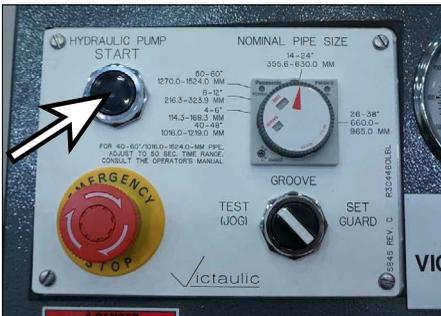
6. Presione el botón “ARRANQUE DE BOMBA HIDRÁULICA”.
