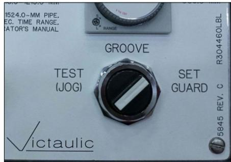
9. Coloque el interruptor selector del panel de control en el modo "AJUSTAR PROTECTOR".
