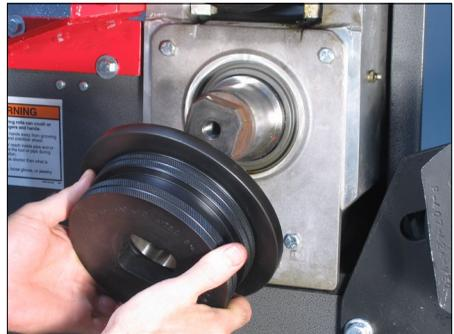
**3.** Alinee el extremo cuadrado del eje principal con el orificio cuadrado del rodillo inferior. Empuje el rodillo inferior completamente en el eje principal. Asegúrese de que las marcas en el rodillo inferior queden hacia afuera.
