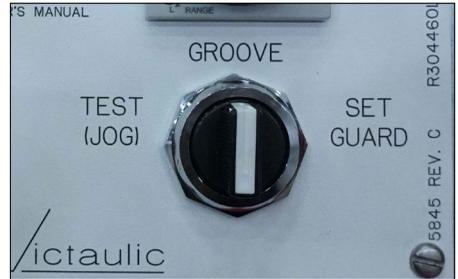
8a. Ponga el interruptor selector en la posición “RANURAR”. El cabezal de la herramienta debería bajar al presionar el pedal de accionamiento, y subir a su posición de reposo al soltar el pedal.
