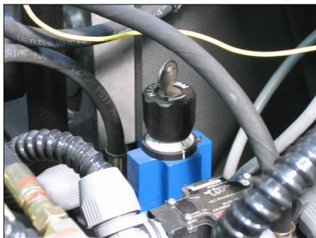
**2.** Gire la llave para desbloquear la válvula de control de velocidad del ariete.
