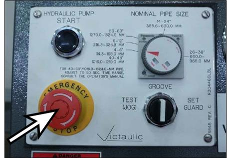
7. Tire el botón "PARADA DE EMERGENCIA" en el panel de control a la posición levantada.
