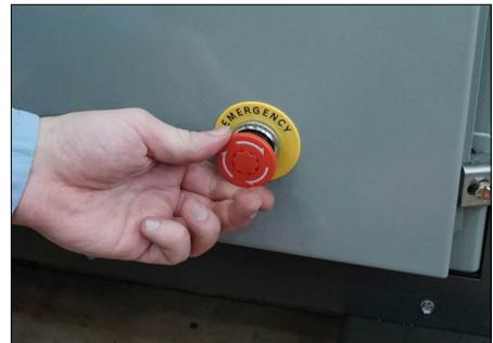
5. Tire hacia afuera el botón de "PARADA DE EMERGENCIA" en el panel de control y compruebe que el botón "PARADA DE EMERGENCIA" en el gabinete eléctrico se lleve a la posición levantada.
