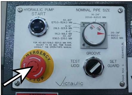
10. Después de que el rodillo superior/corredera haya avanzado aproximadamente 1 pulg./25 mm y los rodillos estén alineados y enganchados, presione el botón "PARADA DE EMERGENCIA" en el panel de control.
