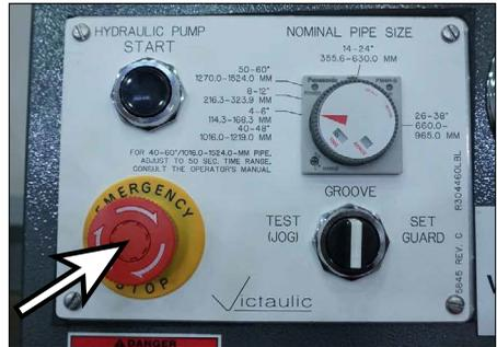
4. Presione el botón “PARADA DE EMERGENCIA” y confirme que esta acción corta la energía al motor. Presionar el pedal, presionar el botón de arranque o ajustar el interruptor selector no debería tener ningún efecto en el estado de la herramienta. Todos los componentes deberían permanecer apagados.
