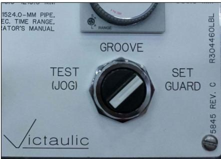
4. Coloque el interruptor selector del panel de control en el modo "AJUSTAR PROTECTOR".
