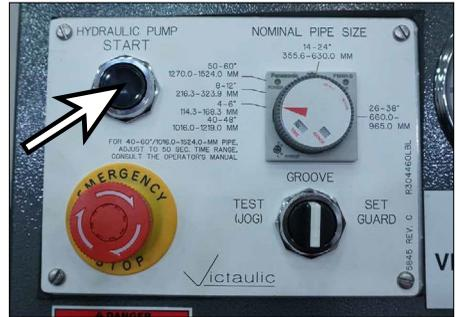
8. Presione el botón "ARRANQUE DE BOMBA HIDRÁULICA".
