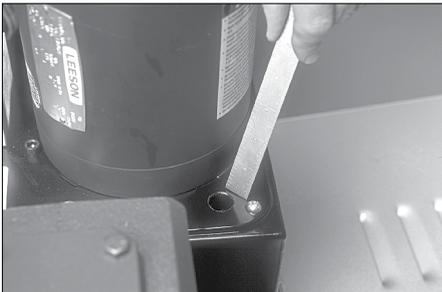
12. Llene el depósito de aceite hidráulico con aceite hidráulico fresco hasta que el nivel llegue a 1 – 2 pulg./ 25 – 50 mm de la parte superior del depósito de aceite hidráulico. Consulte la sección “Lubricantes recomendados”.
