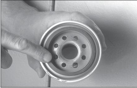
11. Lubrique la empaquetadura del filtro de aceite hidráulico nuevo con aceite hidráulico fresco. Llene el filtro con aceite hidráulico fresco y luego instálelo en la herramienta apretando con la mano.
