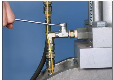
3. Quite el tapón de la conexión en "T" en la parte inferior del puerto del cilindro hidráulico.
