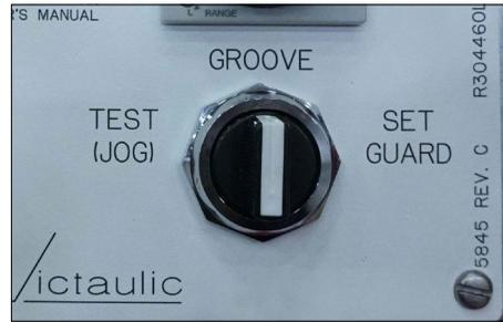
4. Verifique que el interruptor selector del panel de control esté en la posición "RANURAR".
