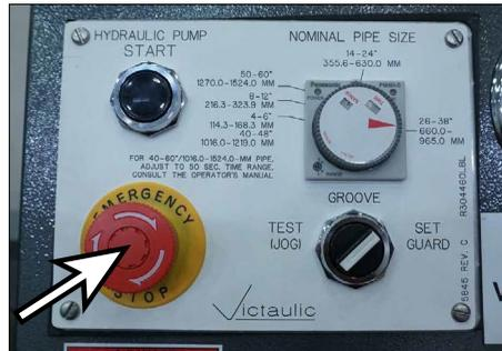
10. Cuando se completan los ajustes del protector de la herramienta, tire del botón "PARADA DE EMERGENCIA" en el panel de control a la posición levantada.
