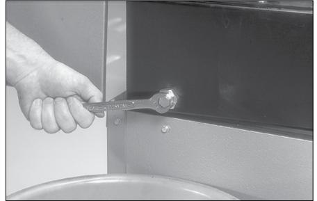
9. Reemplace el tapón de drenaje. Vuelva a deslizar el depósito de aceite hidráulico a su posición y a fijar los soportes.
