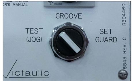
8b. Ponga el interruptor selector en la posición “PRUEBA (MARCHA GRADUAL)”. El cabezal de la herramienta debería bajar al presionar el pedal de accionamiento, y mantenerse en posición al soltar el pedal.
