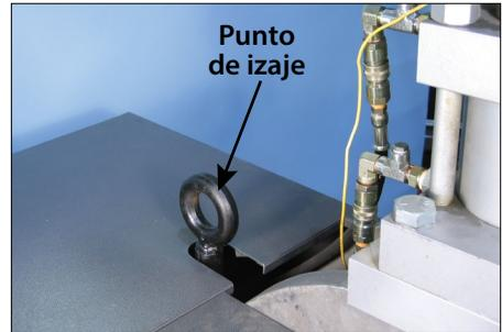
**12.** Cuando se haya instalado y asegurado el número correcto de bases de apoyo, se debe elevar la herramienta hasta su posición y colocarla sobre la o las bases de apoyo. Se incluye un perno de argolla en la sección media superior de la herramienta. Compruebe que la capacidad nominal mínima de la grúa aérea sea de 2000 lb/910 kg. Consulte la sección "Dimensiones y peso de la herramienta – Sin bases de apoyo" si requiere más información.
