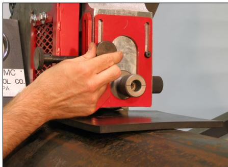
**1.** Ajuste el protector del rodillo delantero, si es necesario, para descubrir completamente el eje superior.
