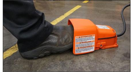
7. Presione el pedal de accionamiento seguro, confirme el funcionamiento de la herramienta y luego suelte el pedal.
