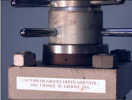
15. Mientras el ranurado continúa, el tope de diámetro de ranura se moverá hacia abajo y hará contacto con el cilindro hidráulico. Este contacto activa el temporizador de duración, que permite que la tubería gire de una a tres revoluciones más para asegurar que la ranura esté terminada (consulte la sección "Ajuste de control de duración"). La herramienta liberará automáticamente la tubería unos segundos después. Suelte el pedal de accionamiento seguro y quite el pie del pedal.
