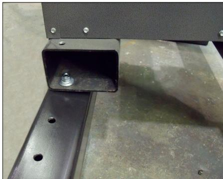
**15.** Inserte un perno con una arandela plana a través del orificio en la base de apoyo y en el orificio de la base de la herramienta. Coloque una arandela plana, una arandela de seguridad y una tuerca en el extremo del perno. Apriete la tuerca a fondo hasta que la arandela de seguridad quede comprimida. Repita este paso con las otras tres ubicaciones de orificios en la base de apoyo y en la base de la herramienta.
