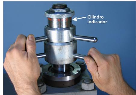
1. Retraiga los ajustadores de profundidad para permitir el recorrido completo del cilindro hidráulico.
