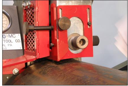
9. Quite la almohadilla de ajuste del protector de la tubería. Guarde la almohadilla de ajuste del protector de una ubicación segura.
