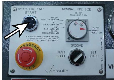
13. Presione el botón "ARRANQUE DE BOMBA HIDRÁULICA" para retraer (levantar) completamente la corredera.
