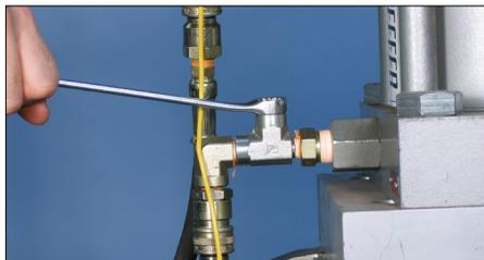
12. Retire el tubo de purga e instale el tapón en la conexión en “T”. **NO PERMITA QUE VUELVA A ENTRAR AIRE EN LA CONEXIÓN EN “T” CUANDO INSTALE EL TAPÓN (VEA EL AVISO SIGUIENTE).**
