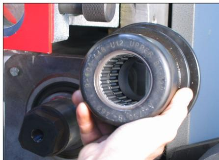
**2.** Instale el rodillo superior correspondiente detrás de la corredera, como se muestra arriba. Asegúrese de que las marcas del rodillo superior queden hacia delante.
