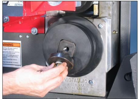
2. Retire el perno de retención del rodillo inferior y la arandela del rodillo inferior.
