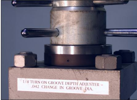
8. Mientras el ranurado continúa, el tope de diámetro de ranura se moverá hacia abajo y hará contacto con el cilindro hidráulico. Este contacto activa el temporizador de duración, que permite que la tubería gire de una a tres revoluciones más para asegurar que la ranura esté terminada (consulte la sección “Ajuste de control de duración”).
