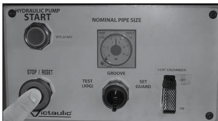
11. Desligue o sistema hidráulico pressionando (para dentro) o botão de emergência "STOP" no painel de controlo.
