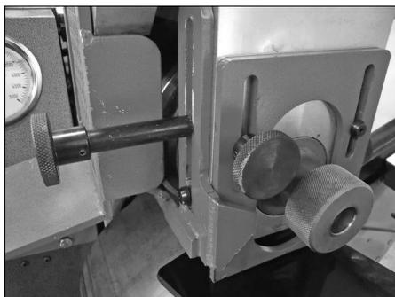
5. Segure o disco de configuração da proteção firmemente contra o tubo e empurre-o por baixo das proteções do rolo. Desaperte o botão na frente das proteções do rolo para descer a placa para o disco de configuração da proteção. Aperte o botão.
