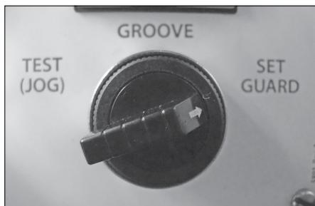
7b. Coloque o seletor no painel de controlo no modo “REGULAR PROTEÇÃO”.
