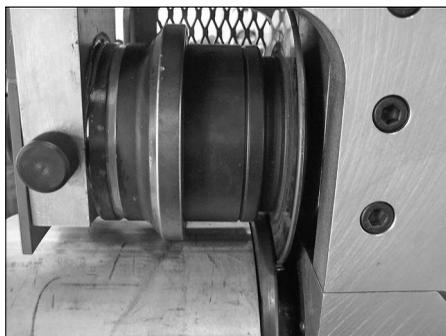
**10.** Introduza um comprimento de tubo que tenha a dimensão, o material e a espessura certas sobre o rolo inferior. Verifique se a extremidade do tubo toca completamente no flange de apoio do rolo inferior. Afaste as mãos do tubo.
