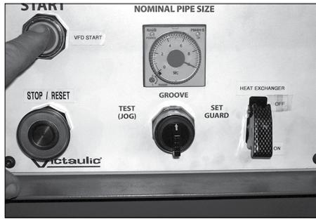
9. Carregue e solte o botão "HYDRAULIC PUMP START" (Arranque da bomba hidráulica). O motor da bomba hidráulica da ferramenta fica ativo e o veio do peso da ferramenta recua para a posição neutra.
