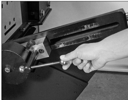
**1.** Desaperte o manípulo de fixação do estabilizador.
