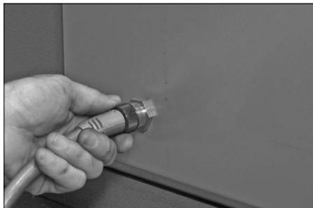
**10.** Passe o cabo do pedal interruptor de segurança através da base de apoio. Ligue o cabo do pedal interruptor de segurança no recetáculo na parte lateral da ferramenta alinhando os pinos/aba do conector do adaptador macho com o recetáculo. Aperte o anel de fixação no conector.
