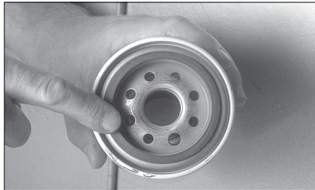
**4a.** Coloque um tabuleiro por baixo do filtro de óleo hidráulico. Retire o filtro de óleo hidráulico.
