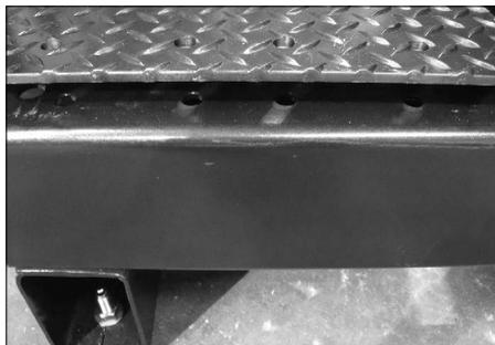
**11.** Monte a plataforma na base de apoio. Alinhe os orifícios na plataforma com os orifícios na base de apoio, como se pode ver acima. Repita este passo para o outro lado da ferramenta.
