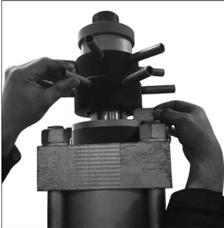
6. Afaste a chave do contacto com o anel de aterramento da ferramenta.
