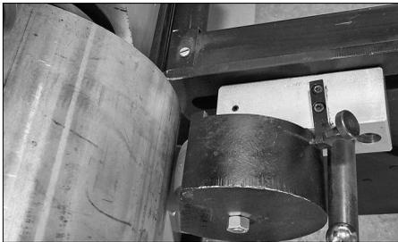
5. Utilizando o volante do estabilizador, ajuste o rolete do estabilizador na direção do tubo.
