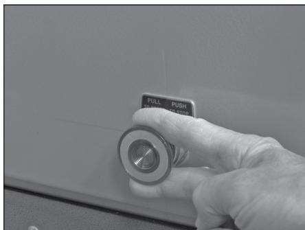
9. Puxe o botão de emergência "STOP" no painel de controlo e a proteção elétrica para a posição exterior.
