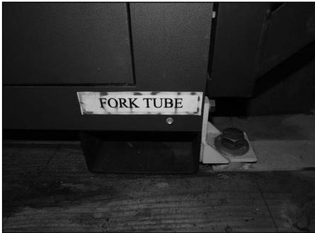
5. Utilizando um empilhador de garfos, eleve a VE50T por cima da área onde as âncoras de pavimento estão colocadas. **NOTA:** Os garfos têm de ser introduzidos em cada “FORK TUBE”. Alinhe os quatro orifícios na base de apoio com as quatro âncoras no pavimento. Baixe lentamente a VE50T sobre as âncoras do pavimento.
