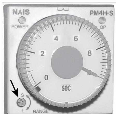
2. Se necessário, rode o parafuso do intervalo de tempo, colocado no canto inferior esquerdo do temporizador, para o intervalo pretendido apresentado na face do mostrador.
