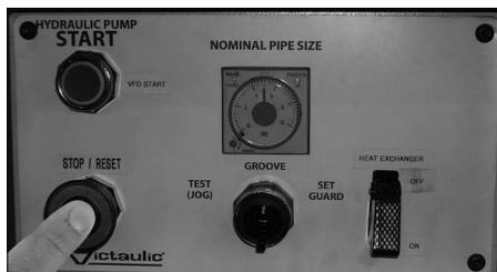
4. Antes de efetuar ajustes na proteção da ferramenta, pressione (para dentro) o botão de emergência **"STOP"** no painel de controle. O rolo superior continua assente sobre o tubo.
