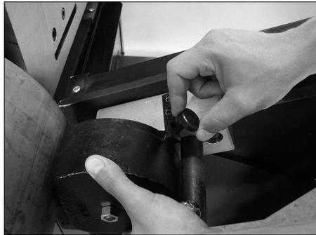
6. Desaperte o botão de regulação da proteção do rolete para posicionar a proteção do rolete de forma que a abertura esteja diretamente de frente para o tubo. Verifique se a proteção não raspa no tubo. Aperte o botão de regulação da proteção do rolete.
