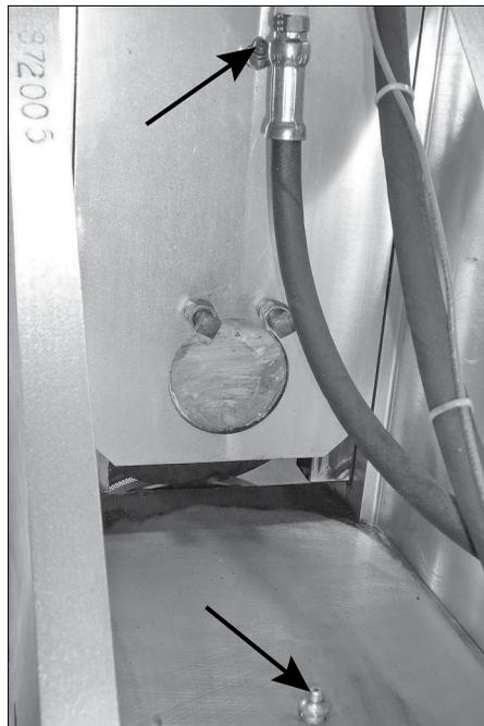
4. Lubrifique as chavetas da corrediça e os rolamentos do veio principal através dos copos de lubrificação colocados na parte de trás da corrediça.
