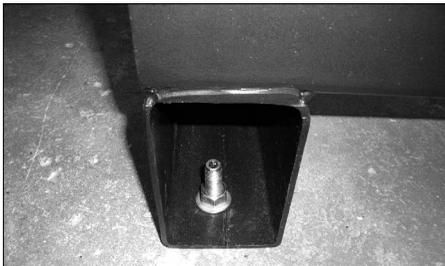
6. Coloque uma anilha lisa e uma porca em cada âncora de pavimento, como se pode ver acima. Aperte a porca completamente.
