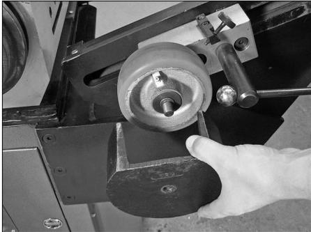
**5a.** Retire a porca de abas da proteção do rolete do estabilizador e a proteção do rolete do estabilizador.
