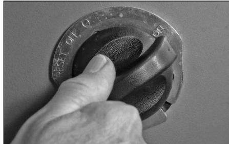
**5.** Rode o interruptor de alimentação na parte lateral da ferramenta para a posição "ON".
