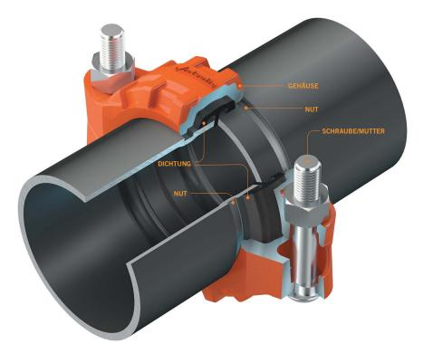
Es gibt mehrere Merkmale, durch die sich extreme Hitzebeständigkeit von mechanischen Verbindungen erzielen lässt: das Gusseisengehäuse, die Eigenschaften des Dichtungsmaterials und die resultierende Dichtkraft, wenn die Schrauben und Muttern fest angezogen sind.
