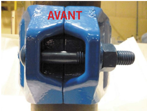
Figure 3a : Assemblage style 905 avant l'essai au brouillard salin C5-M de 1000 heures
