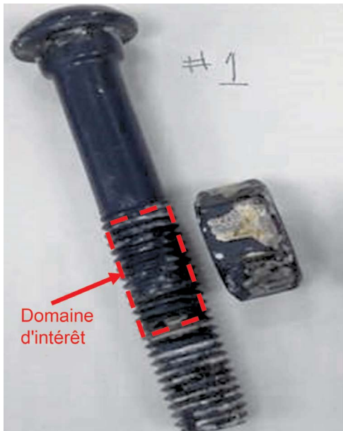
Figure 4 : Visserie revêtue de fluoropolymère de Victaulic après un essai au brouillard salin C5-M de 1000 heures
