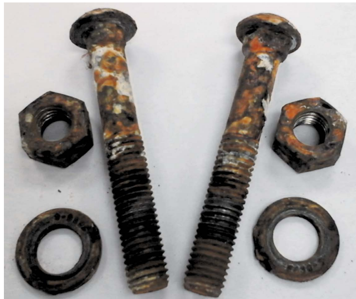
Figure 5 : Visserie électrozinguée en acier au carbone après un essai au brouillard salin C5-M de 1000 heures
